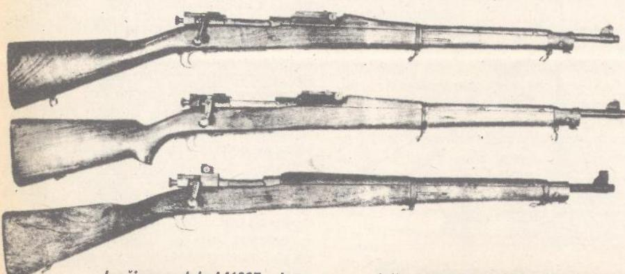
Inačice modela M1903 odozgo prema dolje: M1903, M1903A1, M1903A3
