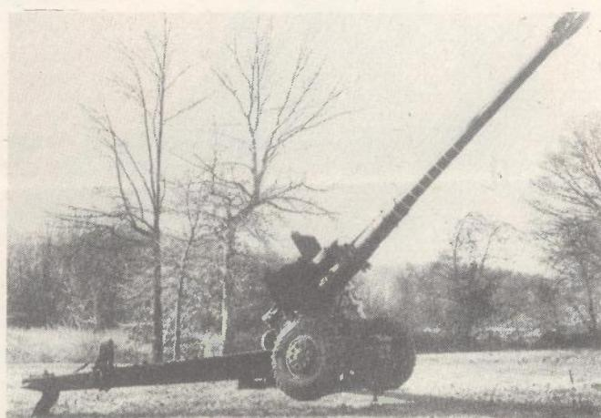
TOP D-47 122 mm ruske proizvodnje na temelju kojeg je nastao kineski 122 mm Type 60, a kasnije zamjenom cijevi 130 mm Type 59-1
