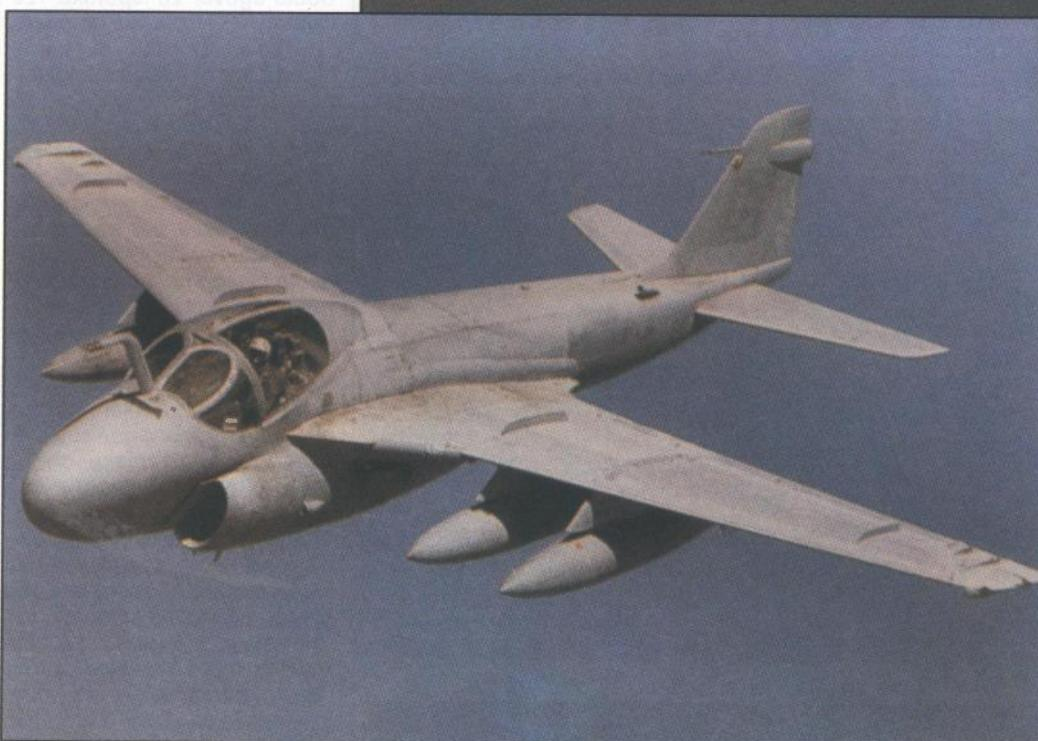
windera i AMRAAM-a namijenjenih samoobrani; ugovorom je trebalo biti isporučeno oko 300 radara), dva turboventilatorska motora bez uredaja za naknadno sagorijevanje. General Electric F404-GE-400D (svaki s 4384 kp potiska), postavljanje dva dodatna nosa-
