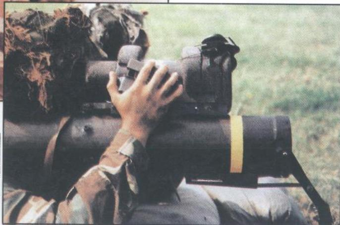
Vojnik američke vojske u pripravi za opaljenje rakete DRAGON. Jasno se ispod palca desne ruke vojnika vidi gumb za opaljenje koji se nalazi montiran na bloku za vođenje i praćenje koji se odvaja nakon ispaljenja i pogadanja od kontejnera (lansirne cijevi) koji se odbacuje
