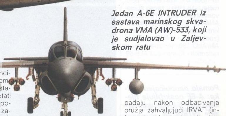
Recognition Attack Multi-sensor); ova modifikacija sastoji se u postavljanju male kupole na donjem dijelu nosa zrakoplova, u kojoj je smješten FLIR (termovizijski senzor za monitoriranje prednje polusfere), la-
