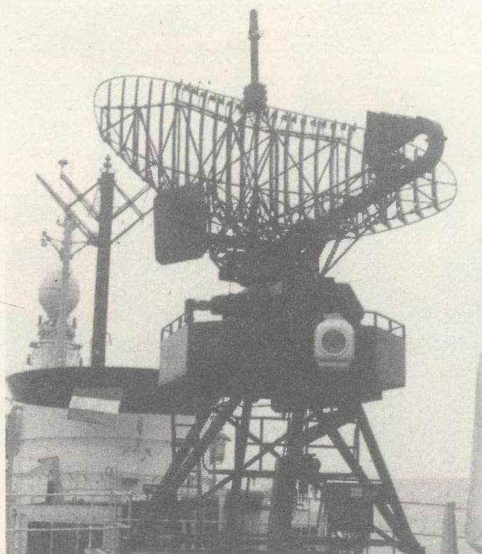
Osnovni element sustava za motreće i nadzor zračnog prostora je radar HSA LW-08
