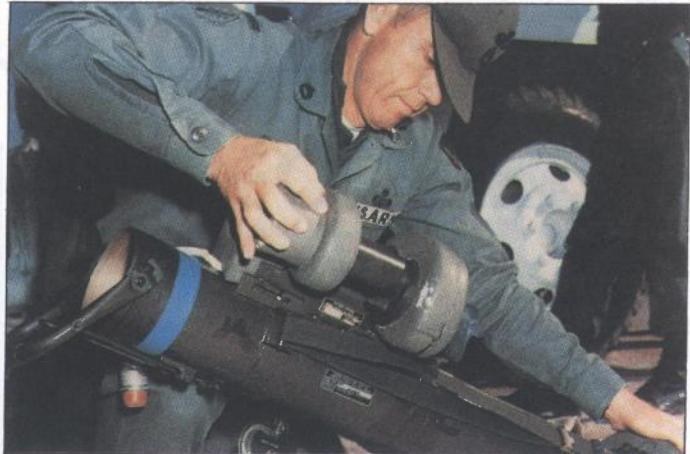
**Optički sustav osim teleskopskog optičkog bloka sadrži IC detektor i svu potrebnu elektroniku za ispaljenje i vođenje raketu do cilja**
