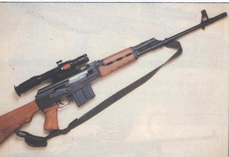
Snajperska puška 7,9 mm M76 s montiranim optičkim ciljnikom ON M76
