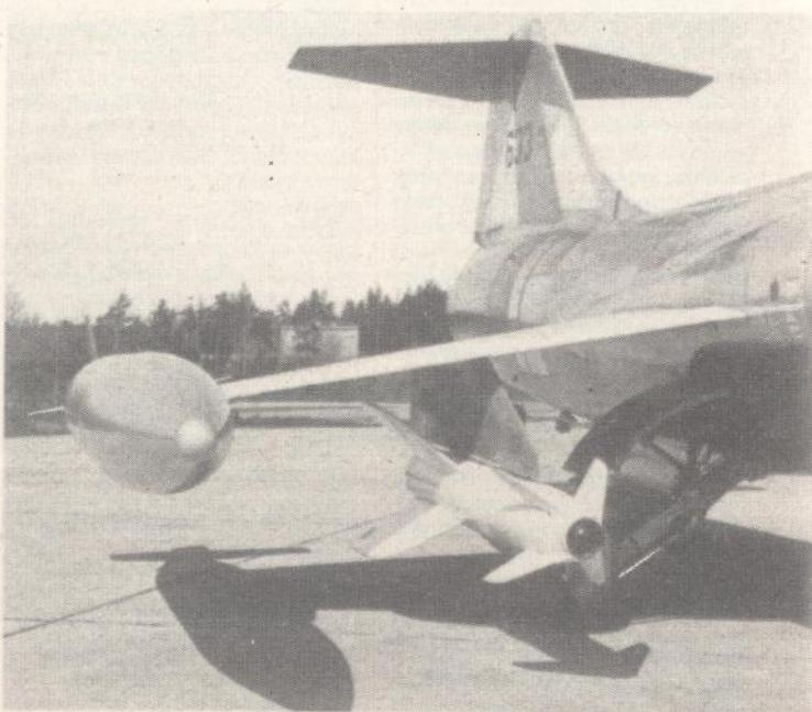
Kad se započelo s pokusima lansiranja sa zrakoplovnih platformi, prva platforma je bio zrakoplov F-104. Kasnije su nastavljeni pokusi na zrakoplovima F-16 koji su poslije 1980. godine postali stalna platforma za Penguin raketu
