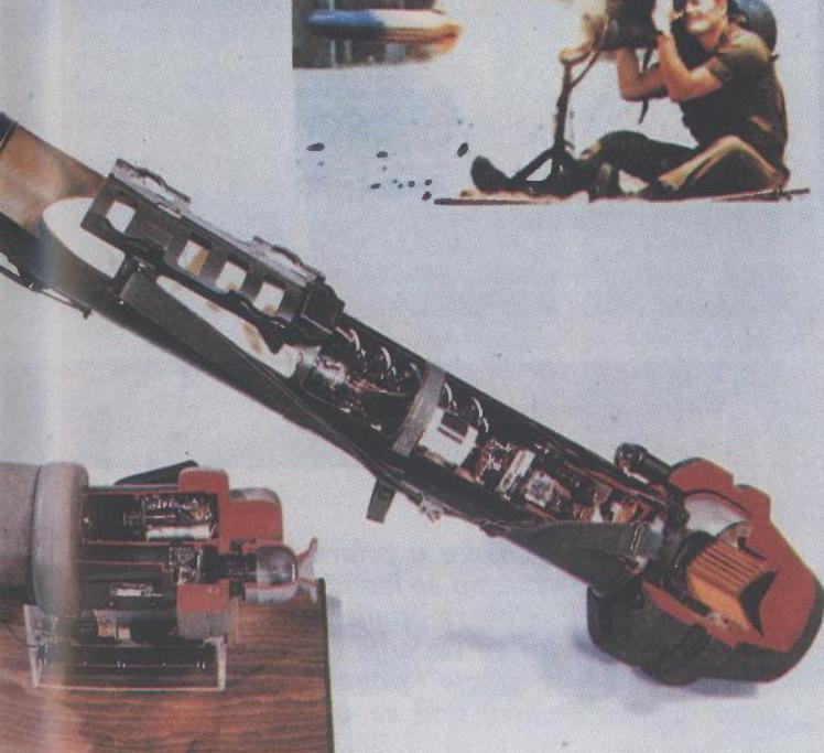
valjanje, dok operator cilja kroz ciljnički križić da bi uklopio raketu u crtu ciljanja. Obavijesti koje sustavu šalje IC traser sustav obrađuje i stvara upravljačke signale kojima se sukcesivno uključuju parovi motorića od kojih svaki daje potisak od 120 kg za 0,7 sekundi. Sustav za vođenje (optički tragač) koji se priključuje na kontejner s raketom je Kolzman SU 36/P.
