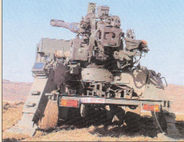
dručju sustava za topničku potporu. Sustav ATMOS (Autonomous Truck MOUNTED System) je samovozna haubica nastala kao odgovor na potrebe moderne vojske. Te potrebe predviđaju visokomobilni topnički sustav srednje mase i velike paljbene moći. U Soltamu, kao i brojnim drugim tvrtkama diljem svijeta koje proizvode topničke sus-
