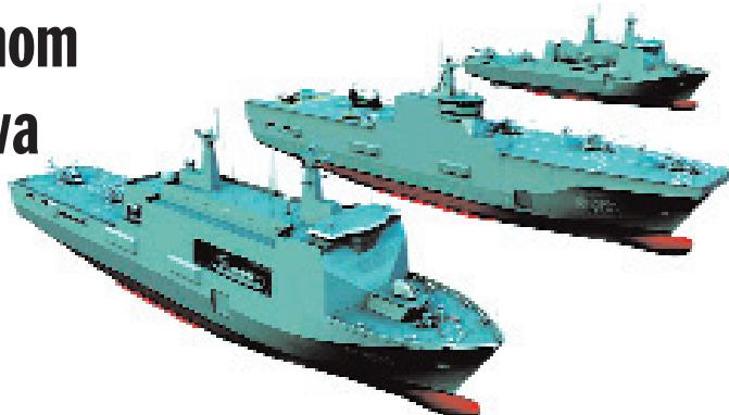
25,0 m (82 ft); maksimalna istinsna 11 570 t (12 750 tons); mogućnost transporta 555 vojnika, 400 stožernog osoblja i 30 borbenih tenkova ili 90 oklopnih transporterata. Oprema uključuje i dva Thales Naval Nederland Goalkeeper Close-in borbena sustava i Thales Naval Nederland DA08 radar.
