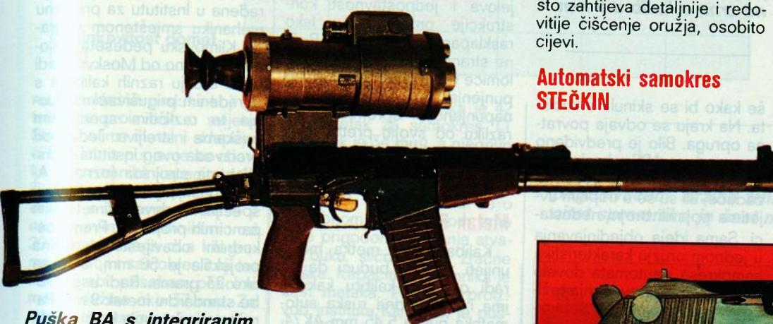
**Puška BA s integriranim prigušivačem u kalibru 9 mm. Na slici je prikazana inačica s montiranim uređajem za noćno gađanje**
