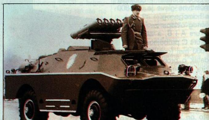
**Ruski BRDM-2 s pet kontejnera s raketama KONKURS. Kod ove vrste platforme napravljene su lansirne rampe s automatskim punjenjem nakon ispaljivanja svih pet raketa**
