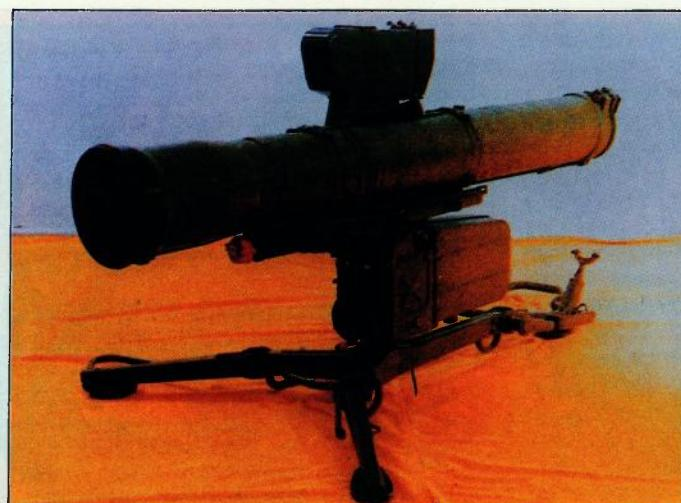
*Kompletan PO sustav KONKURS C (Tank Buster). Iznad kontejnera sa raketama vidi se optički blok a ispod bloka elektronike ispred kojeg se nalazi kutija sa zupčastim prijenosom uređaja za pokretanje po pravcu i visini*
