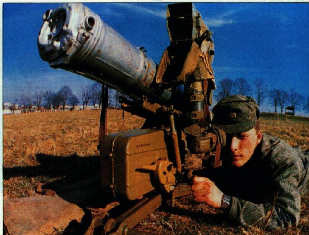
**POVRS FAGOT prema NATO sustavu označavanja nosi naziv AT-4 SPIGOT. Kompaktan je i autonoman sustav koji se lako prenosi i brzo postavlja u bojni položaj. Male protežnosti daju mu malu i slabo uočljivu siluetu na bojišnici**
