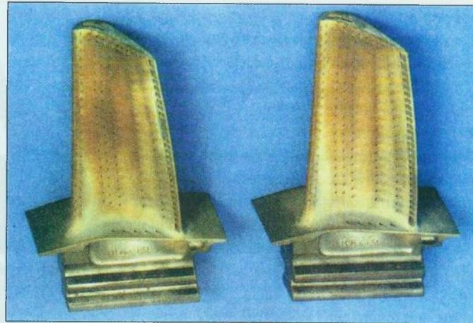
Turbinske lopatice turboventilatorskog motora F119; zbog visokih radnih temperatura kojima će biti izložene, u njihovoj izradbi korištene su nove tehnologije
