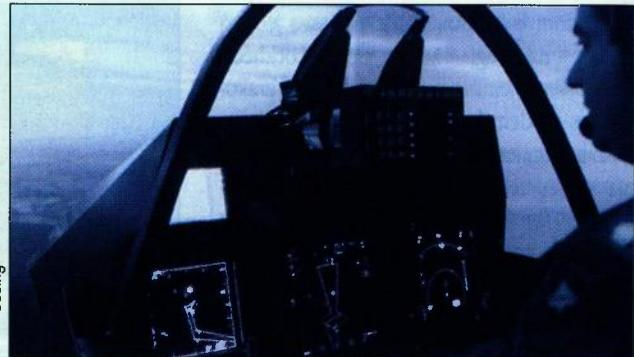
Boeingov FMS simulator rabljen je u procesu dizajniranja X-32 za utvrđivanje konfiguracije komponenti sustava avionike
