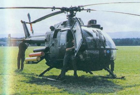
Njemački protuoklopni vrtoljet PAH-1 Phase 1 (PAH-1A1, vojna inačica Bo 105P), naoružan PO raketnim sustavom Milan
