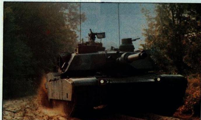
**Američki tank ABRAMS opremljen je s čak tri strojnice. Na kupoli su ugrađene dvije protuzrakoplovne strojnice: jedna u kalibru 12,7 mm s kojom rukuje zapovjednik i druga u kalibru 7,62 mm s kojom rukuje ciljatelj topa. Treća strojница, također u kalibru 7,62 mm spregnuta je za cijev topa**
