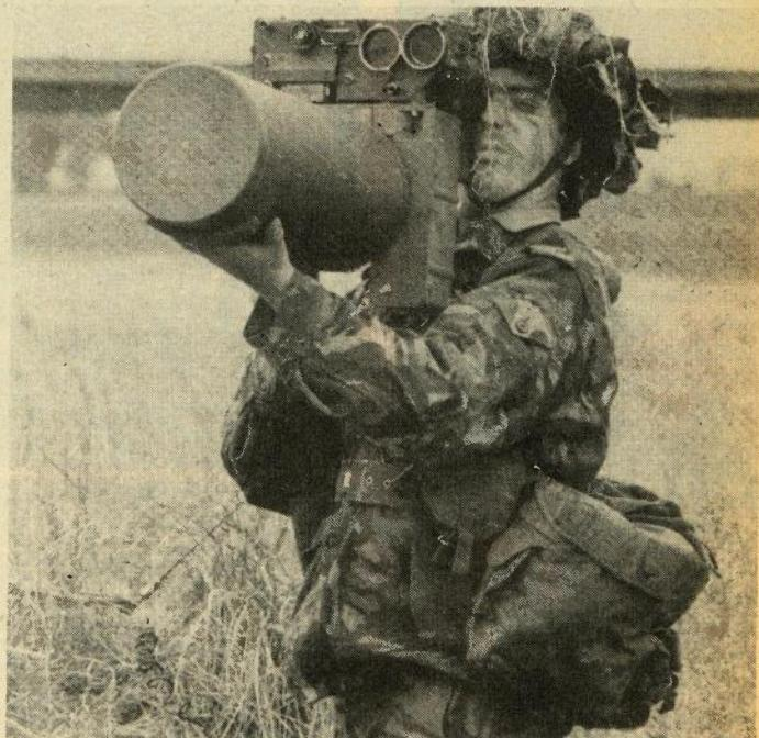
*Za protuzrakoplovnu obranu teritorijalnih postrojbi služi raketni sustav JAVELIN*
