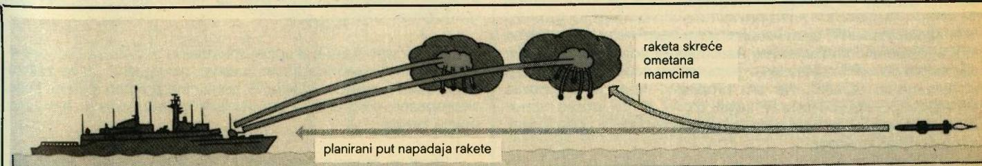
*Da bi se brod zaštito od protubrodskih raketa, neprijatelj ispaljuje mamce koji sustavu za detonaciju i vođenje rakete predstavljaju objekt (brod) kojim ta raketa napada te na taj način dolazi do skretanja rakete s unaprijed planiranog puta napada.*
