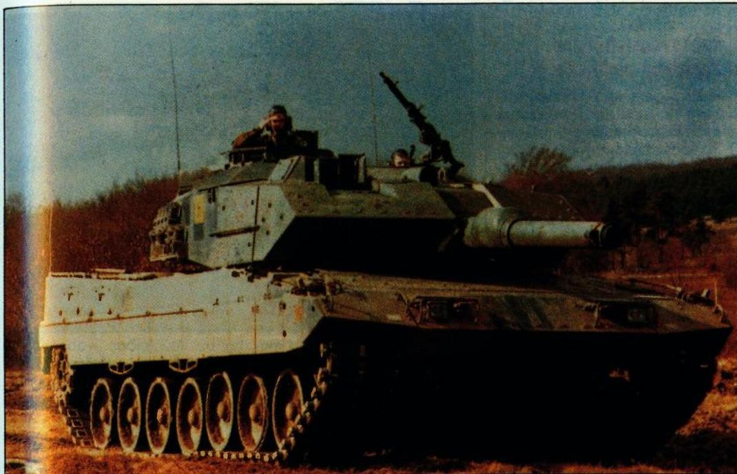
**Njemački tank LEOPARD 2 naoružan je topom kalibra 120 mm, jednom spregnutom strojnicom 7,62 mm MG3 i jednom protuzrakoplovnom strojnicom istog kalibra**
