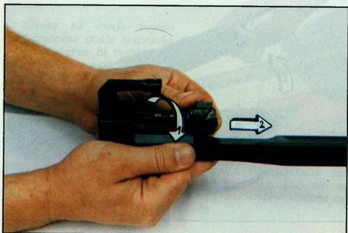
*Odvajanje zatvarača od nosača zatvarača*
