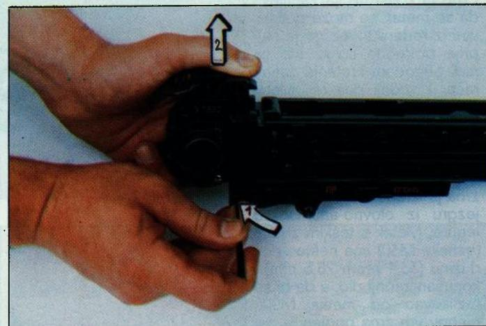
Skidanje uređaja za okidanje s kućišta
