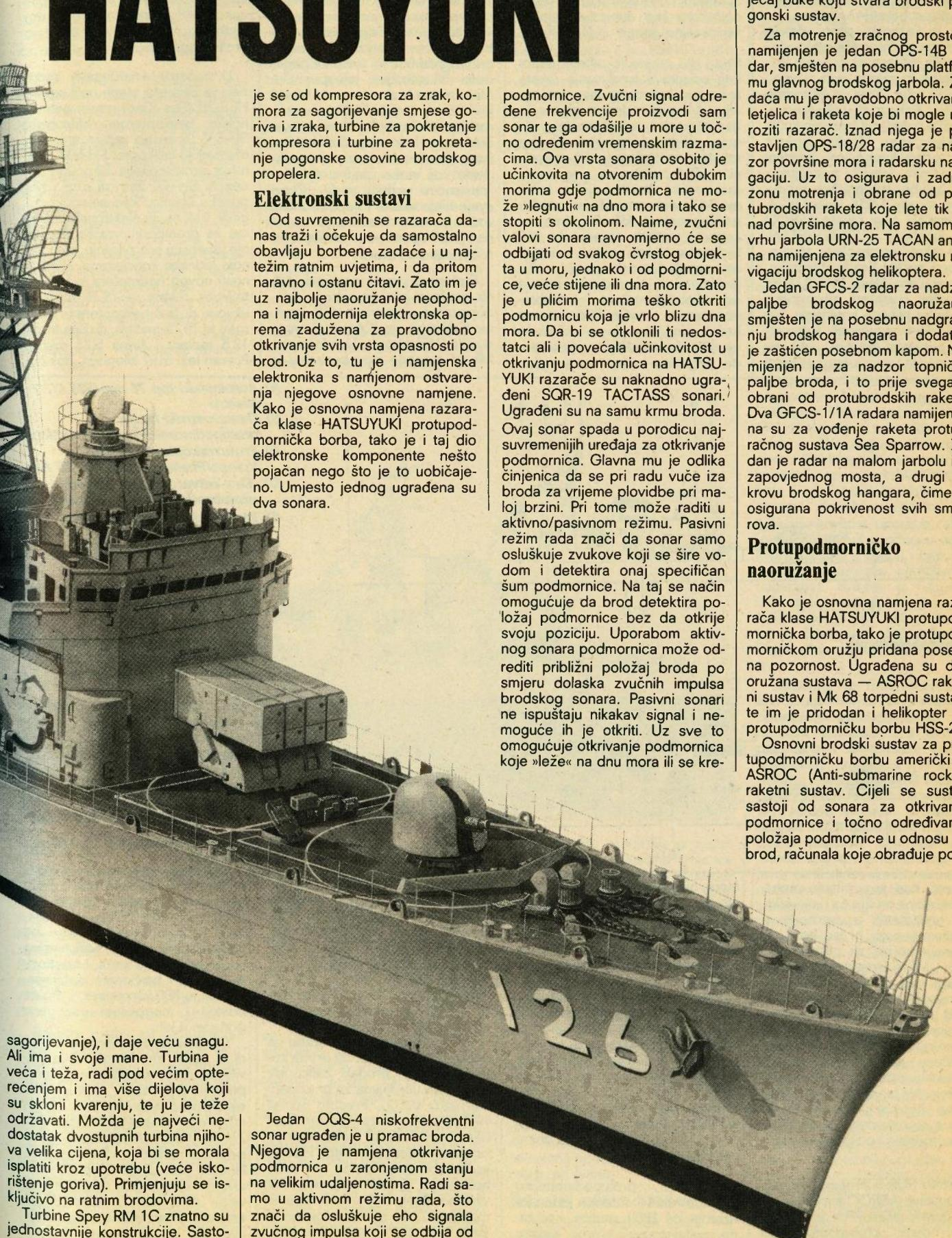
sagorijevanje), i daje veću snagu. Ali ima i svoje mane. Turbina je veća i teža, radi pod većim opterećenjem i ima više dijelova koji su skloni kvarenju, te ju je teže održavati. Možda je najveći nedostatak dvostupnih turbinu njihova velika cijena, koja bi se morala isplatiti kroz upotrebu (veće iskoristenje goriva). Primjenjuju se isključivo na ratnim brodovima.
