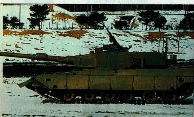
**Japanski tank (Type 90) naoružan je topom 120 mm i dvije strojnice: jednom u kalibru 7,62 mm koja je spregnuta s topom i jednom protuzrakoplovnom u kalibru 12,7 mm**
