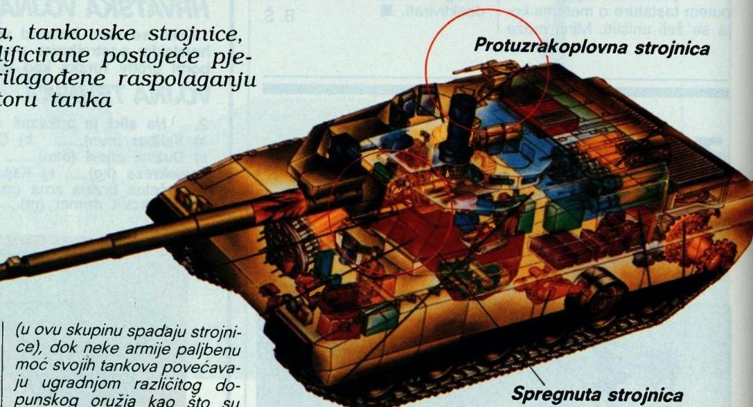
Pored topa kao osnovnog naoružanja, tankovi su opremljeni različitim pomoćnim oružjem u koje spadaju i strojnice. Obično se na kupoli ugrađuje protuzrakoplovna strojnica u kalibru 12,7 mm a u oklopnom dijelu tzv. spregnute strojnice najčešće kalibra 7,62 mm. Pojam spregnute strojnice označava strojnicu koja je mehanički vezana s cijevi topa i pokreće se zajedno s njom
