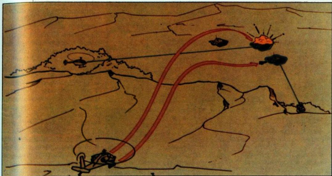
**Shematski prikaz kako rakete HELLFIRE mogu biti ispaljene iza zaklona prema metama označenim (obilježenim) laserima (plave crte). Za ove rakete su napravljena TV i slikovna IC tražila, no plu-aktivno lasersko vođenje pokazalo se kao najbolja solucija**
