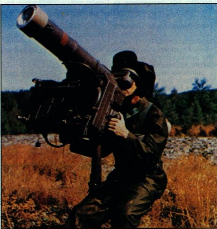
Poslije lansiranja rakte zemlja-zrak tvrtke BOFORS leti k cilju duž laserske zrake koju isijava lanser oružja. Ovdje je primjenjena nova i na elektronske kon-tramjere otporna metoda vođenja rakete
