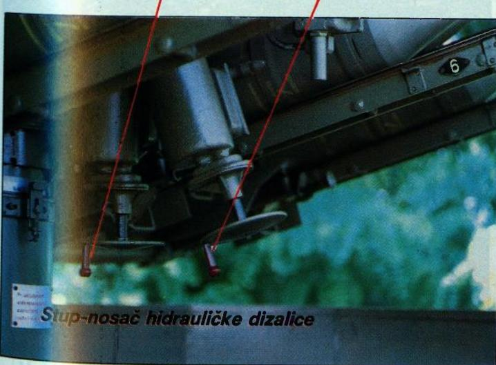
**Prikaz detalja mehanizma za usmjerenje sklopa lansera po smjeru i visini.**
