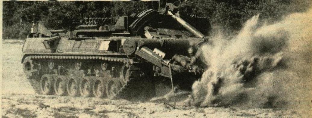
Specijalni uređaji, koji ispred sebe imaju oklopna pomagala i pri tome uništavaju mine, ili pomagala s kojima se raščišćava prolaz u miniranom tlu razgrijtanjem zemljišta, nazivaju se uređaji za razminiranje a nalaze se u izravnom dodiru s minama, zbog aktiviranja (pritiskom, udarom, čupanjem) ili odbacivanja u stranu
