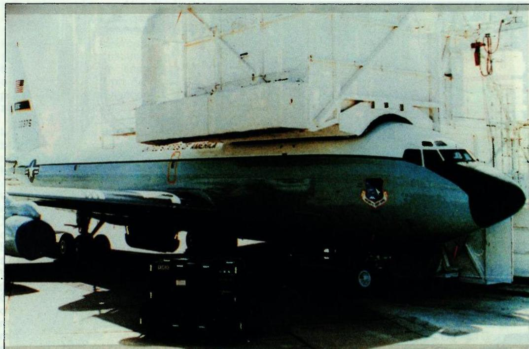
**Zrakoplov EC-135E, nazvan ARGUS 2 namijenjen je za provjeru zrakoplovnih lasera a opremljen je s 11 tipova senzora za skupljanje optičkih podataka**
