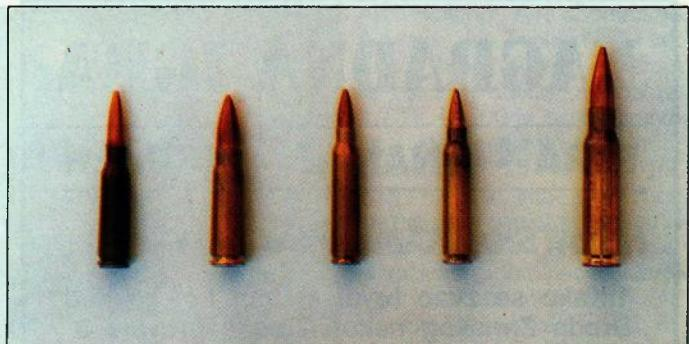
Izgled metaka koje koriste automatske puške. Slijevo udesno: 5,45 x 39 mm; 7,62 x 39 mm; 5,56 x 45 mm M193; 5,56x 45 mm SS 109; 7,62 x 51 mm. Uočava se velika razlika u protežnostima između metka 7,62 mm NATO i ostalih metaka
