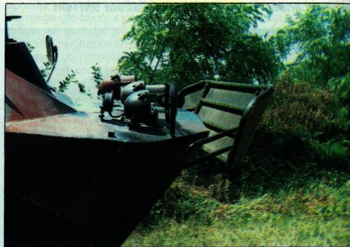
**Prigodom savlađivanja vodenih prepreka uključuje se propeler, a istodobno s otvaranjem poklopca prostora za propeler podiže se na prednjem dijelu valobran koji sprečava zapljuškivanje prozora, odnosno periskopa vozača**
