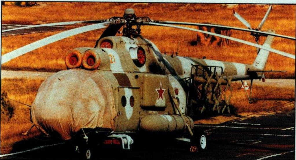
ska relejna postaja. Po izgledu Hip D je sličan transportnoj inačici Mi-8T. Umjesto oružja na bokovima su postavljeni spremnici (vjerojatno za elektronsku opremu), a na repu helikoptera smještena je većina komunikacijskih antena (na donjem dijelu nalaze se dvosstrukе žičane antene i jedna vjerovatno HF antena, a na gornjem dijelu dvije cilindrične i dvije zakriviljene antene). Hip D nije opremljen doplerskim radarem. Iduća inačica Mi-9 Hip G također služi kao mobil-
