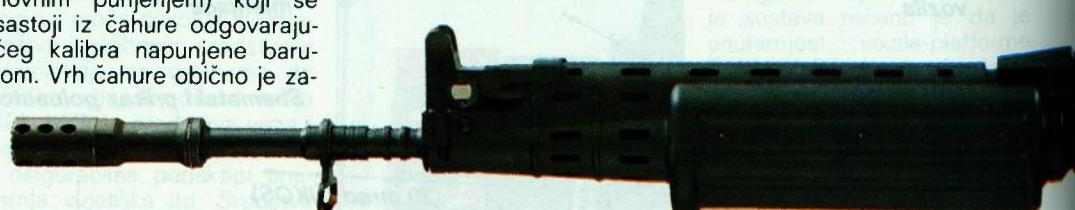
**Kod većine pušaka zapadnih zemalja tromblon je sastavni dio cijevi jer se skrivač plamena koristi i za stavljanje tromblonskih mina. Vanjski promjer je standarisiran i iznosi 22 mm. Radi sprečavanja spadanja mine s cijevi ugrađen je žičani prsten**
