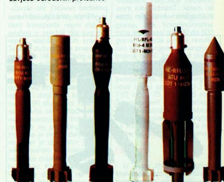
Belgijska tvrtka MECAR ima vrlo velik assortiman tromblonskih mina. Njihove konstrukcije temeljene su na konceptu »hvatača zrna« što znači da se ispaljivanje obavlja bojnim metkom. Odatle skraćenica BTU (Bullet Trup Universal) na svakoj mini. Uočavaju se specijalno napravljena krilca na dimnoj mini M281 koja na daljini od 650 m stvara dimnu zavjesu površine 30x30 m. Svi modeli mina mogu se ispaljivati s bilo koje puške 5,56 mm ili 7,62 mm koja ima standardni tromblon promjera 22 mm.
