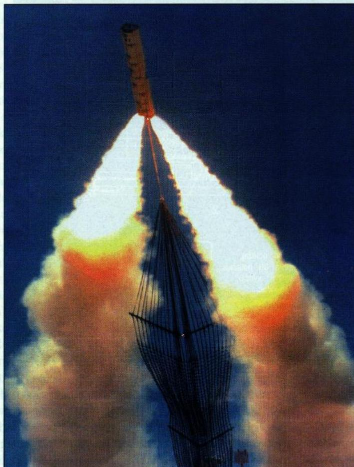
Let ispaljenog eksplozivnog ESMB sustava iznad minskog polja. Vozilo pješaštva Bradley vuče prikolicu iz koje se raketom lansira eksplozivna mreža s titan kumulativnim punjenjima. Razminira se put duljine 145 m i širine 5 m
