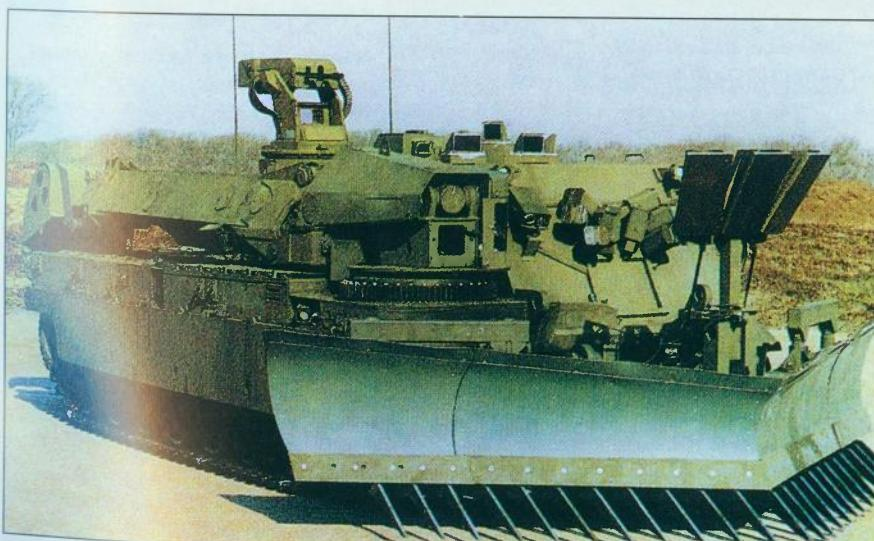
Američki Grizzly "Breacher" je inženjerijsko vozilo za svladanje minskih zapreka punom širinom tanka. Oprema: minski plug za uklanjanje mina, automatski sustav za nadzor dubine i pregleda tla i mehanička ruka. Raščićava prolaz širok 4 m, do dubine 38 cm, brzinom od 10 km/h
