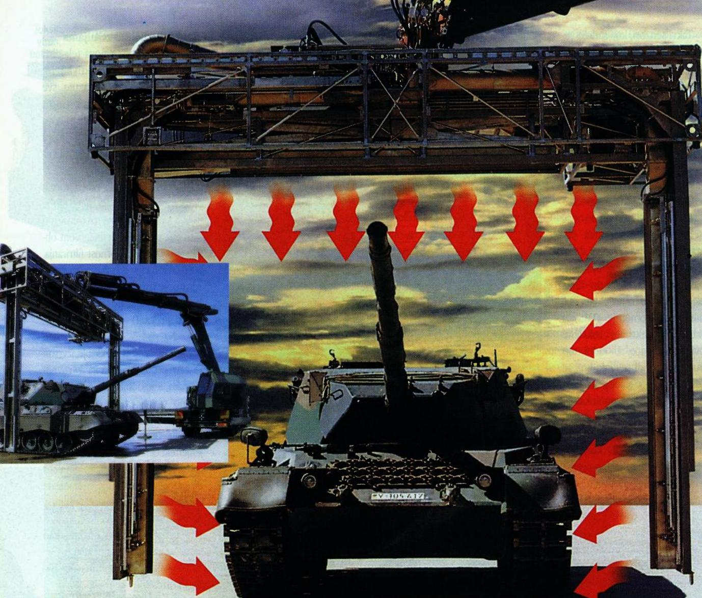
Slika 6. Prikaz dekontaminacije velikih vozila pomoću vrućeg plina
