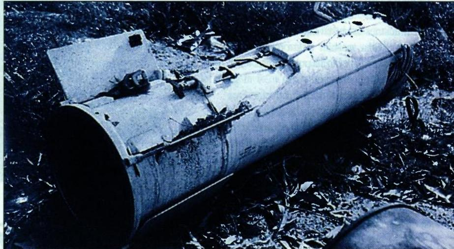
Aerosolna bomba BLU-73/B; 34 kg etilenoksida, ekvivalentno 100 kg TNT. Zrakoplov nosi veći broj mina
