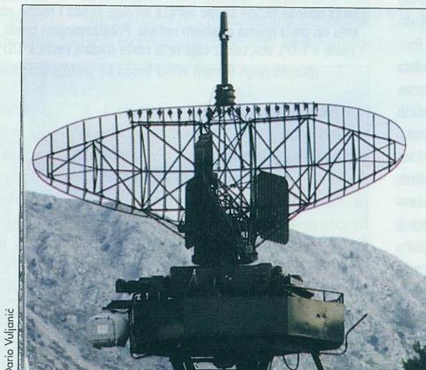
**Zbog veće vjerojatnosti preživljavanja u bitkama između radara i omotača, motrički radari vojne namjene najčešće imaju za oko 20 dB veću efektivnu zračenu snagu od one koju imaju standardni radari civilnih namjena sličnih dometa detekcije. Na slici je izvozno vrlo uspješni nizozemski radar za motrenje zračnog prostora LW 08**
