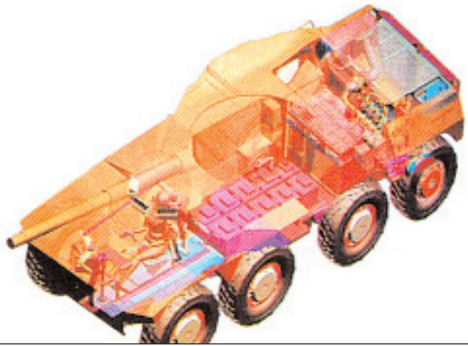
dizelski motor. Kamion je imao motor snage 330 kW, a Rooikat ima motor snage 450 kW. Energija se sprema u NiMH baterije poznatog proizvođača takvih rješenja, tvrtke Saft.
