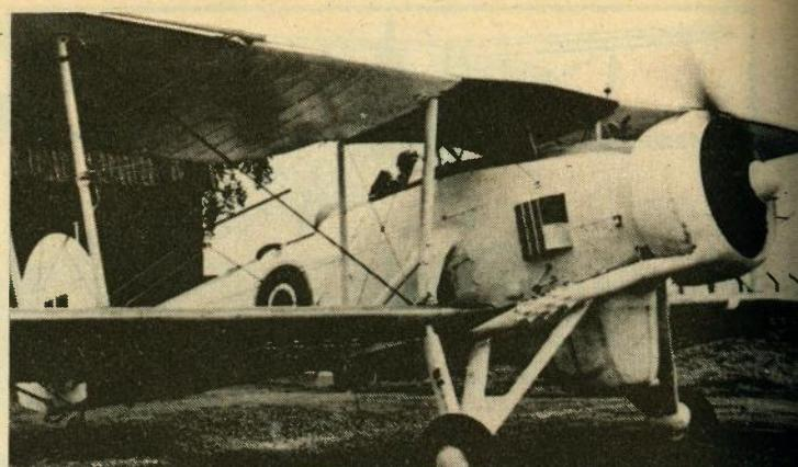
**Swordfish Mk.III.** Vidi se kupola i antene radara ASV Mk.X, nosači raketa i prigušivač plamena iz motora potreban za noćne akcije
