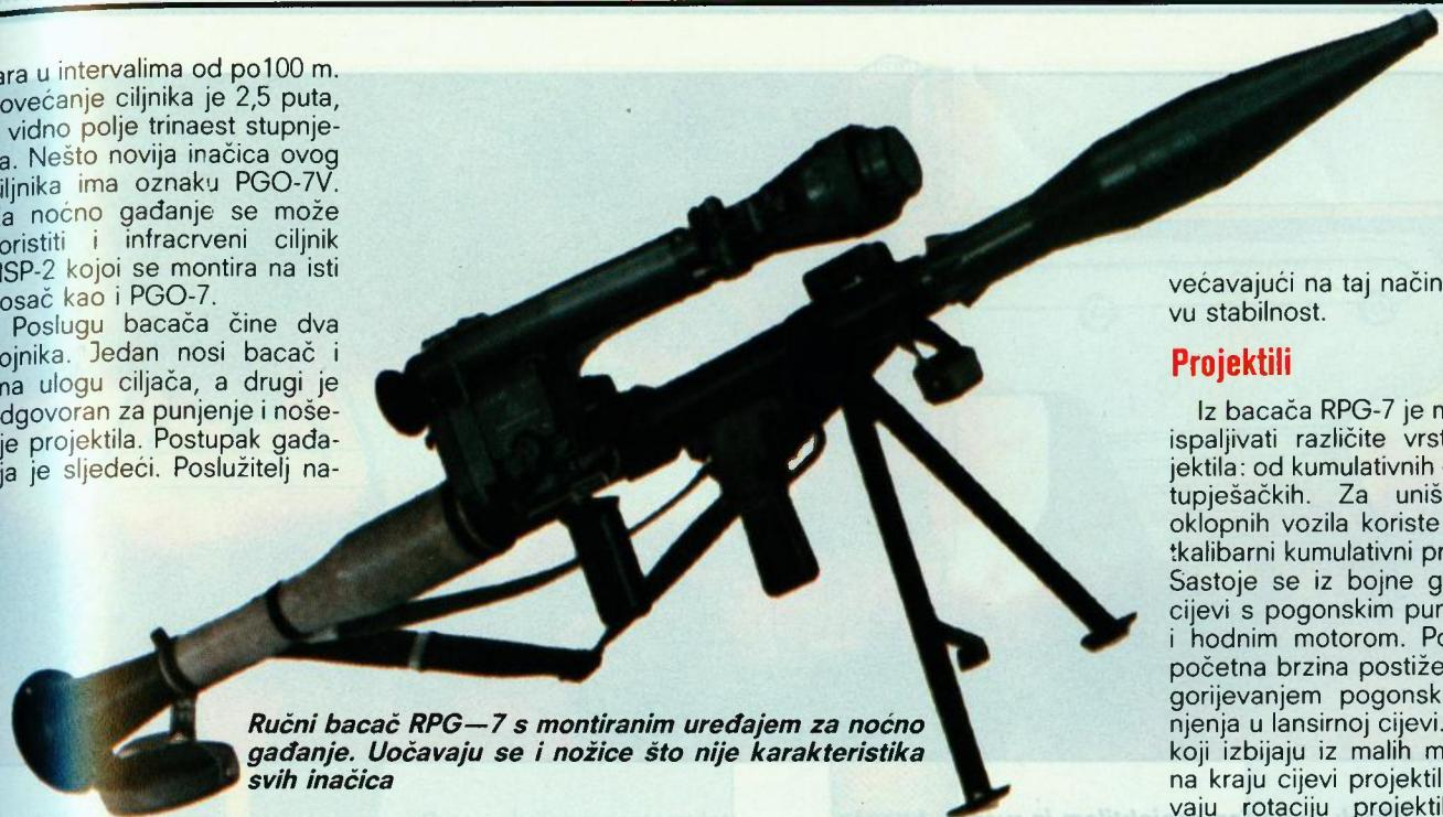
*Ručni bacač RPG-7 s montiranim uređajem za noćno gađanje. Uočavaju se i nožice što nije karakteristika svih inačica*
