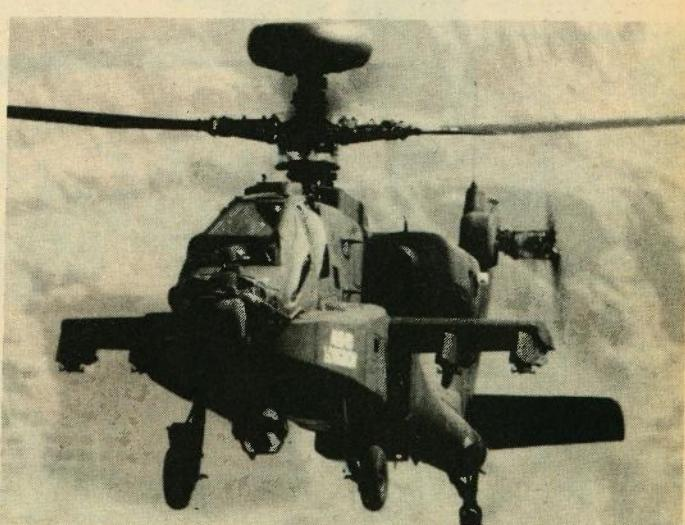
Na ovoj slici je vidljivo povećanje prostora za smještaj avionike; na prototipu prikazanom na prethodnoj slici ova modifikacija još nije izvršena
