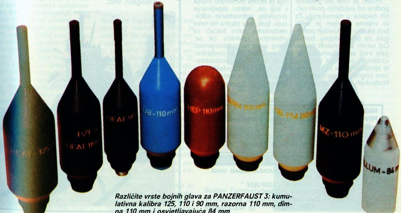
**Različite vrste bojnih glava za PANZERFAUST 3: kumulativna kalibra 125, 110 i 90 mm, razorna 110 mm, dimna 110 mm i osvjetljavajuća 84 mm**
