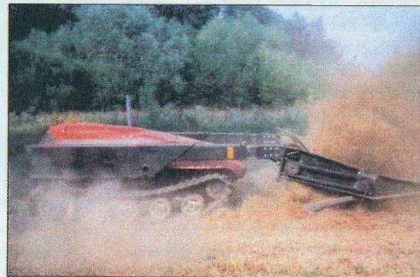
Hrvatsko robot vozilo MV-2 lagana mlatilica, daljinski upravljano za uništavanje protupješačkih mina (površinski pritisak na tlo  $0.42 \text{ daN/cm}^2$ ; alat s čekićima za kopanje i razbijanje mina do 600 g, komplet 60 kom, DOK-ING d.o.o.)
