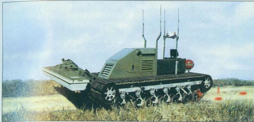
Izraelsko robot vozilo s radarskim detektorem EL/M-2190. Visina detekcije iznad tla iznosi 70 cm
