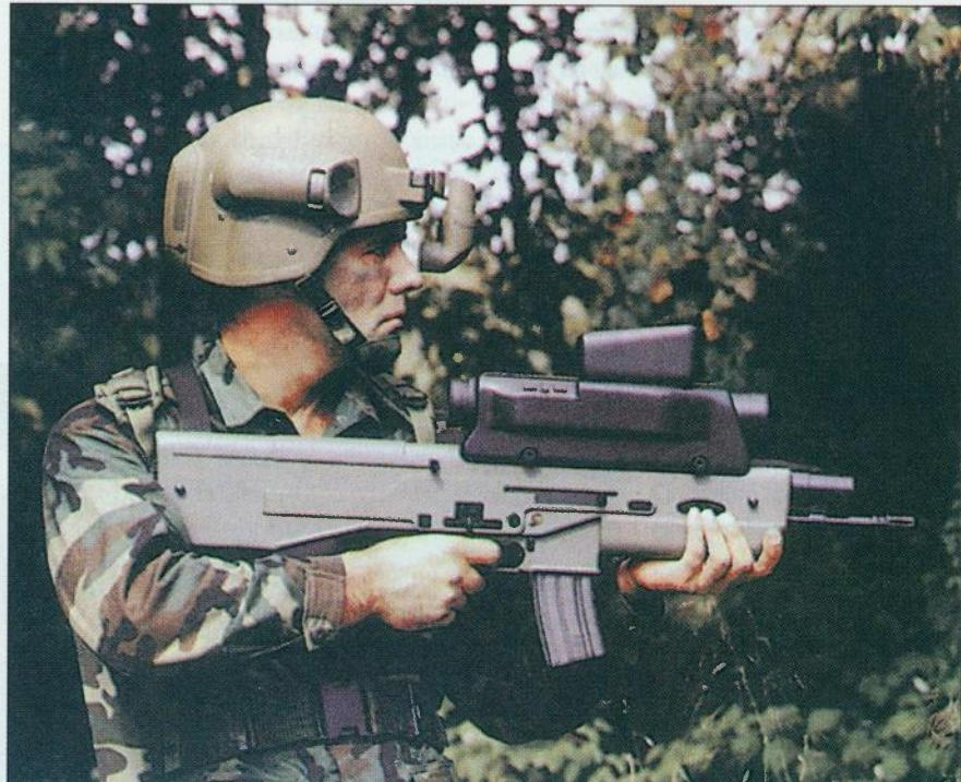
Izgled prototipa oružanog sustava pod vodstvom tvrtke AAI. Bullpup konstrukcija omogućila je da oružje bude vrlo kratko i kompaktno, iako je bilo nužno ugraditi dvije cijevi različitih kalibara
