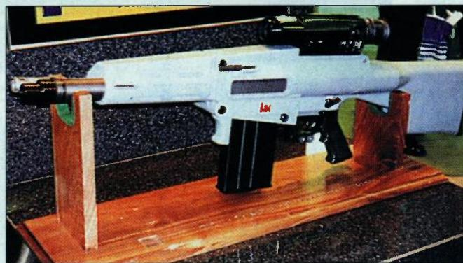
Prototip oružja koje je razvio tim predviđen tvrtkom Alliant Techsystems. Uočavaju se dvije cijevi (5,56 mm i 20 mm) postavljene jedna uz drugu
