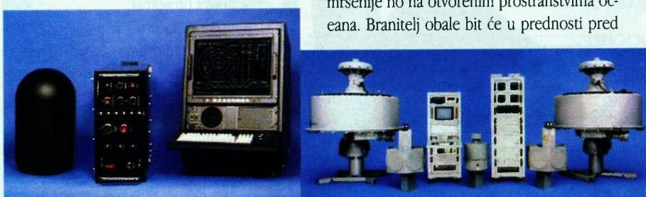
Brodski EW sustav američkog poduzeća ARGOSystems koji uključuje ESM sustav AR-900 (lijevo) i ECM sustav APECS II (u sredini) te jedna od dviju antena ometača sustava APECS II koje pokrivaju sektore od po 180 stupnjeva
