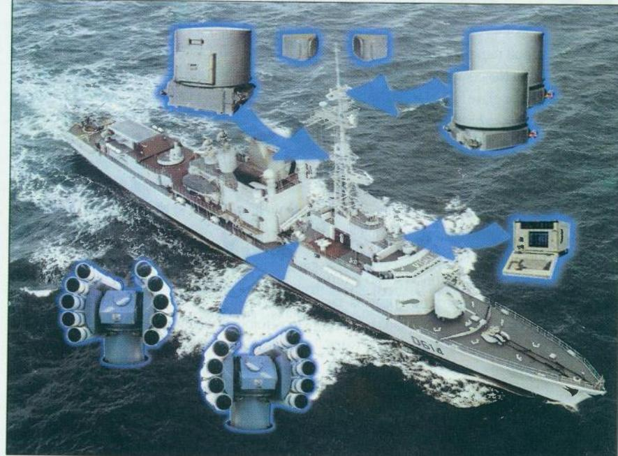
**Raspored sklopova sustava za elektronička djelovanja Salamandre V3 (ukupne mase oko 800 kg) na razaraču s dvodjelnom antenom ESM detektora na vrhu jarbola i tri ometačke antene (pokrivaju po 120 stupnjeva) na nižim postoljima na glavnom jarbolu**
