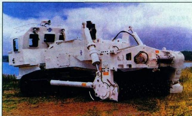
Švedska usitnilica Bofors Mine Guzzler za humanitarno razminiranje za obrađivanje sumnjivog tla i uništavanje mina, do dubine 30 (50) cm, protusmjeren način kopanja ("ispod sebe")
