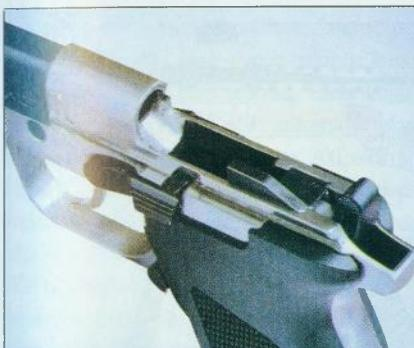
Pogled na tijelo samokresa bez zatvarača. Vidi se posebni oblik kokota koji nije rađen za napinjanje rukom kao i cijeli sustav ugradnje cijevi, kočnice zatvarača, izbacivača naboja, odnosno ispaljenih čahura naboja, i prvot za kočnicu rasklapanja samokresa. Posebno je uočljiva kosa rampa na ulazu u cijev, a ta je oznaka svih samokresa s nezaključanim zatvaračem
