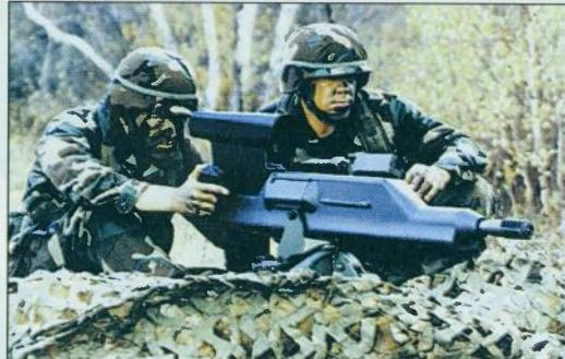
Prototip oružja iz programa OCSW koji bi trebalo zamijeniti tešku strojnici 12,7 mm M2 Browning te automatski bacač granata Mk1
