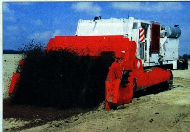
Njemačka usitnilica RHINO za obradivanje sumnjivog tla i uništavanje mina, do dubine 30 (50) cm, istosmjeran način kopanja
