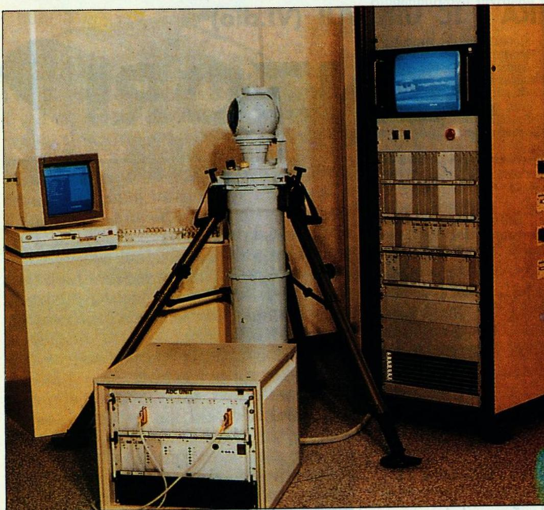
**ARISE je jedan eksperimentalni sustav koji će biti korišten za ispitivanje IRST opreme za uzbunjivanje na zračne prijetnje**
