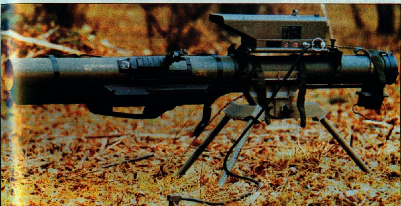
**Dodavanjem ciljničko-nadzornog sustava ručni raketni bacači za jednokratnu uporabu mogu se koristiti kao svojevrsne protuoklopne mine vodoravnog djelovanja. Za detekciju i lociranje cilja koristi se IC, akustički i seizmički senzor. Na slici je prikazan bacač LAW 80 s montiranim sustavom AJAK**
