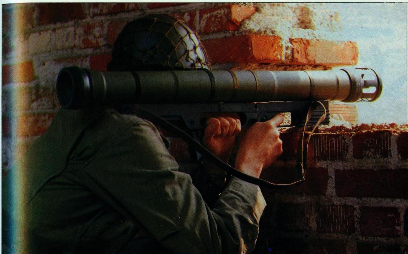
*Konstrukcija ručnog raketnog bacača ARMBRUST omogućava ispaljivanje projektila iz zatvorenih prostora, što je vrlo važno za borbu u urbanim sredinama. Bacač je dugačak svega 85 cm, a ima masu do 6,3 kg. Nakon ispaljivanja rakete, lanser se baca.*
