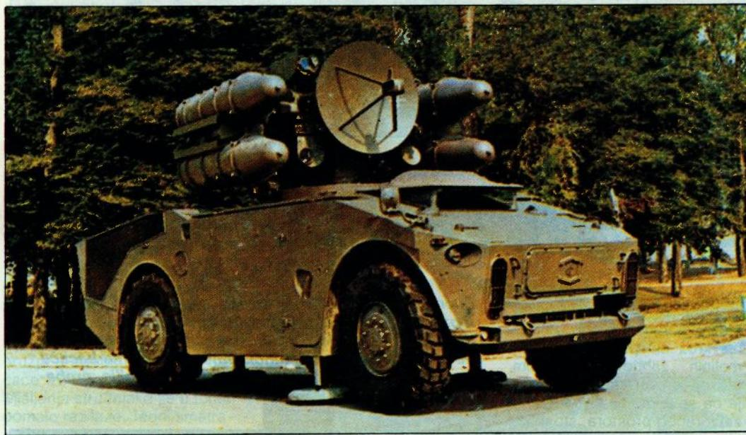
Lansirna jedinica sustava »Crotale« (serijska proizvodna izvedba) u paljbenom položaju (dobro su vidljive nožice za niveliiranje)
