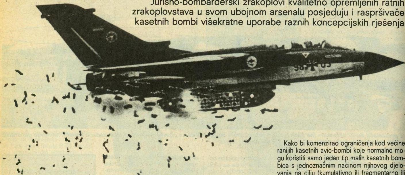
*Jurišni zrakoplov Tornado njemačkog ratnog zrakoplovstva izbacuje kasetne bombe iz raspršivača MW-1*
