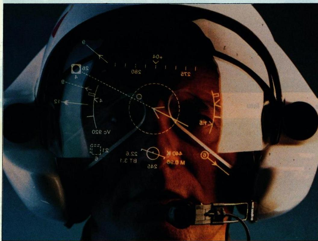
Značajna se pozornost posvećuje razvoju pokazivača u kacigama (HMD) koji omogućavaju različiti stupanj »uronjenosti« sučelja s virtualnim zapovjedno-upravljačkim prostorom. Slika prikazuje eksperimentalni HMD kojeg razvija Sextant Avionique
