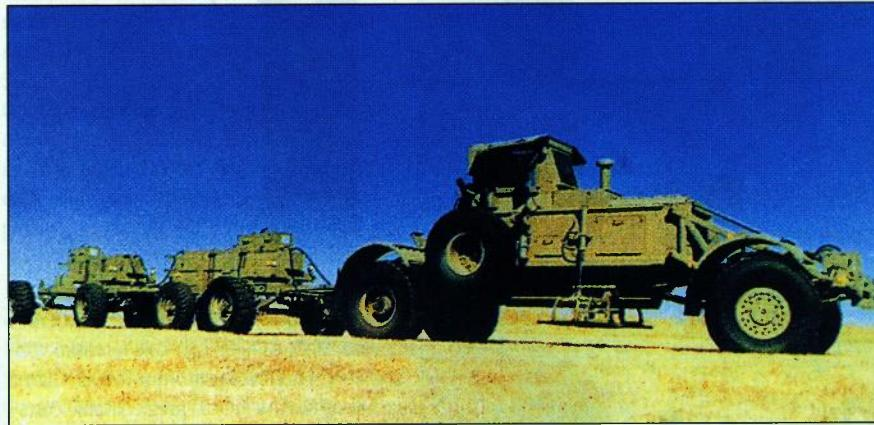
Pokretni sustav "Chubby" za čišćenje putova od mina. Sastoji se od prvog detekcijskog vozila Meerkat (MDV) i od detekcijskog vučnog vozila Husky (T/MDV), te dvije prikolice Dulsendpoot za detoniranje mina (MDT). Iza toga slijedi zapovjedno vozilo kolone koje vuče komplet pričuvnih osovina, te 10-tonski logistički kamion koji vuče ostale pričuvne dijelove i opremu
