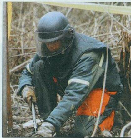
Pronalaženje mina pipalicom. Klečeći položaj pirotehničara sa zaštitnom opremom. Kut uboda pipalice, broj uboda, zaštita glave i tijela te koncentracija, temeljne su značajke ručnog čišćenja
