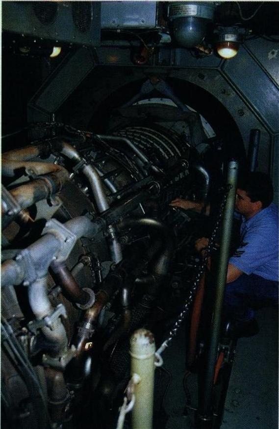
Pregled turbine LM 2500PE koja je smještena u izolirani modul
