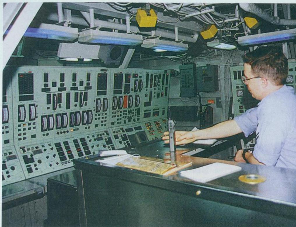
Nadzor svih glavnih i pomoćnih strojeva obavlja se iz Središnje nadzorne postaje (CCS)
