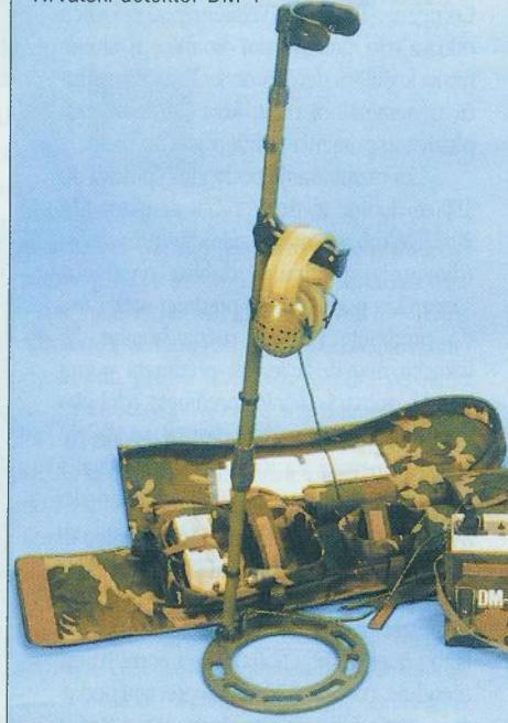
Načelo rada detektora metala AN-19/2. Zavojnica odašiljača u glavi za traženje odašilje električni impuls i stvara magnetsko polje koje u blizini mine inducira vrtložne struje zbog pojave metalnih predmeta. Te struje izazivaju pojavu sekundarnog polja kojeg zatim hvata zavojnica prijamnika. Signal se obrađuje, a zvuk u slušalici upozorava čovjeka na prisutnost metalnog predmeta. Na temelju iskustva može se odrediti veličina i oblik predmeta
