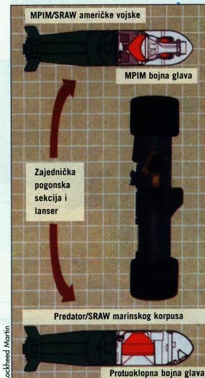
Predator ima u nosu prema naprijed i dolje okrenute laserske i magnetske senzore koji prvo detektiraju nazočnost cilja i nakon toga u točno određenom trenutku Predator shvaća da je iznad cilja te aktivira bojnu glavu koja odozgo probija tanki oklop na gornjoj površini tenka. Isto tako druga inačica Predatora ima MPIIM "direct-attack" bojnu glavu kojom se uspješno može djelovati protiv svih vrsta fortifikacijskih objekata.
