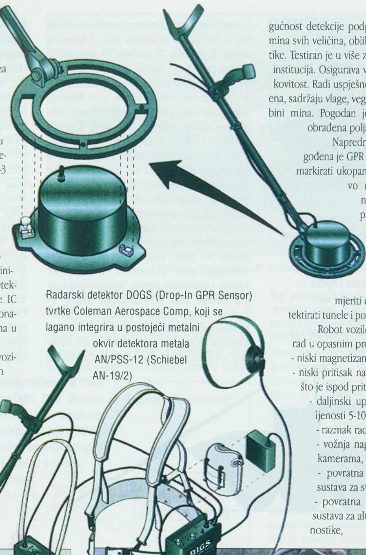
Radarски detektor DOGS (Drop-In GPR Sensor) tvrtke Coleman Aerospace Comp, koji se lagano integrira u postojeći metalni okvir detektora metalata AN/PSS-12 (Schiebel AN-19/2)
