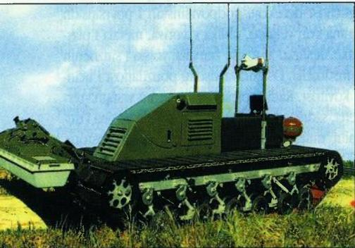
Izraelsko robot vozilo GRV s daljinskim upravljanjem za detekciju i markiranje metalnih i nemetalnih mina s GPR radarem EL/M-2190 koji pregledava sloj tla. Širina detekcije iznosi 2 (3.5) m, dubine 30 cm, radne brzine 3.6 km/h. Niska i rijetka vegetacija nije problem. Gusta i veća vegetacija mora se prethodno ukloniti. Identifikacija se poboljšava dodatkom koji omogućava IC i TV detekciju
