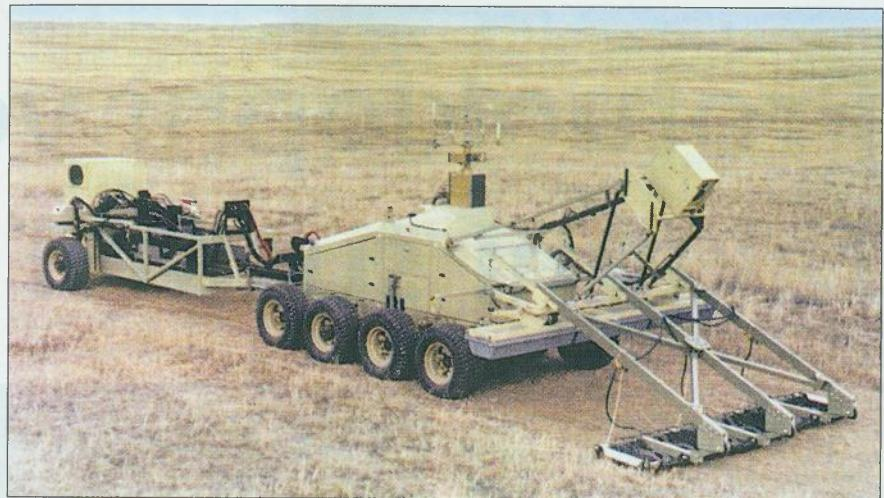
Telerobot vozilo 8x8 ILDP multisenzorski detektor
