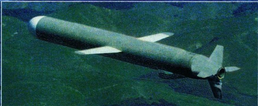
Krstareći projektii Tomahawk s turbomlaznim pogonom je za navođenje na cilj opremljen sustavom praćenja kontura terena ili sustavom GPS
