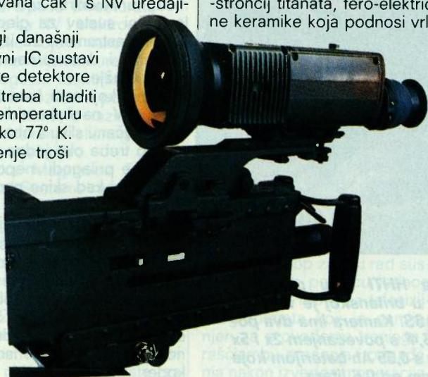
**IC ciljnik (IWS) koji je razvila tvrtka Magnavox. Ova inačica ciljnika ima široke kutne leće objektiva (12 x 20°). Inačica s detektorskom matricom od 128 elemenata može raspoznati čovjeka (3-4 piksela) na udaljenosti od 600 m**
