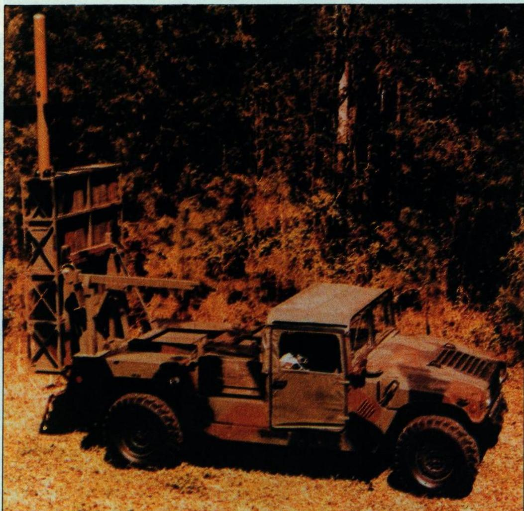
HUMMER s postavljenim šestocijevnim PZO sustavom FOG-M
