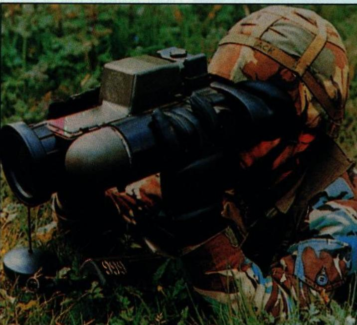
Ručna termovizijska kamera HHTI koju proizvodi tvrtka Thorn EMI Electronics, u britanskoj je vojsci u uporabi pod nazivom SPYGLASS. Kamera ima dva polja vida i to 20° sa 8,6° i 8° sa 3,4° s povećanjem 2x i 5x respektivno. Težina joj je 5 kg s 0,55 Ah baterijom koja osigurava rad 1,75 sata s bocom od 0,6 litara
