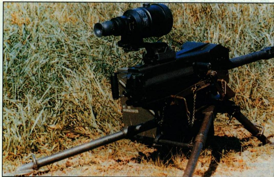
**Automatski bacač granata Mk 19 s montiranim NV ciljnikom pod nazivom AN/TVS-5 koji je razvila tvrtka IMO Industries. Uz pomoć ovog ciljnika moguće je vrlo precizno gađati ovim bacačem na daljini od čak 500 m u uvjetima vrlo slabe vidljivosti**
