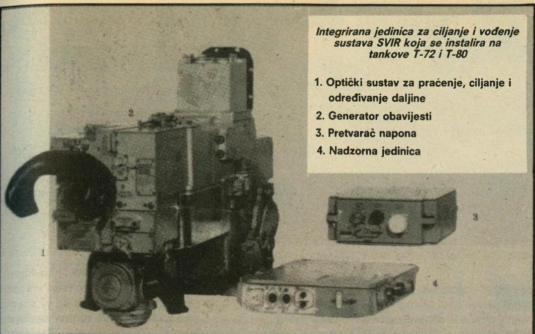
*Integrirana jedinica za ciljanje i vođenje sustava SVIR koja se instalira na tankove T-72 i T-80*
