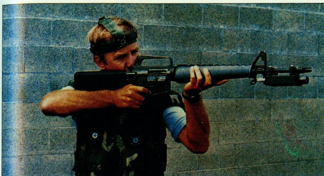
**Sustav MILES može se montirati na različite vrste oružja. Na slici je prikazana američka puška 5,56 mm M16 s laserskim predajnikom montiranim ispod cijevi. Na glavi i prsluku strijelca razmješteni su odgovarajući detektori**
