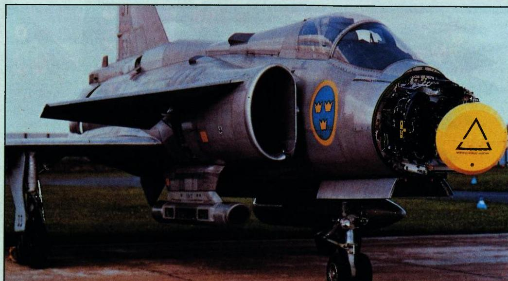
*Impulsno dopplerski radar PS-46/A (UAP 1023); na fotografiji je prikazan prototip istog*
