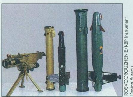
Postojeći PO lanser 9P151 moguće je koristiti i za lansiranje i vođenje i POVR 9M115 Metis i POVR 9M131 Metis-M. Na slici su prikazane obje raketne postavljene pokraj svojih kontejnera. Prema konfiguraciji (tzv. konfiguracija "patka") raketne su iste, no zamjetno je povećanje veličine raketne Metis-M, kao i nešto prema nazad pomaknuta kormila na nosu raketne
