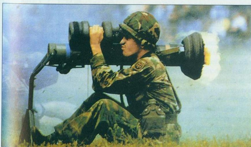
Na slici je prikazano lansiranje POVRS Dragon II. Može se zamijetiti karakteristični sjedeći položaj operatora prigodom uporabe sustava
