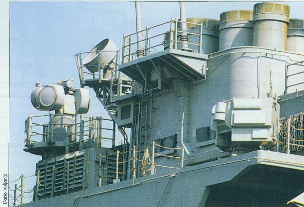
Na krmenom nadgrađu smješteni su sustav Mk 95, ispod kojeg su otvoreni sustava za klimatizaciju, antena OE-82, krmeni dimnjak, kao i kućište anetne sustava AN/SLQ-32
