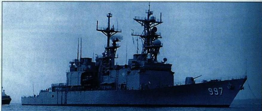
Jedino na razaraču *USS Hayler*, posljednjoj izgrađenoj jedinici klase *Spruance*, za motrenje zračnog prostora rabi se radar AN/SPS-49V(5) čija je antena postavljena na platformi s prednje strane krmenog jarbola
