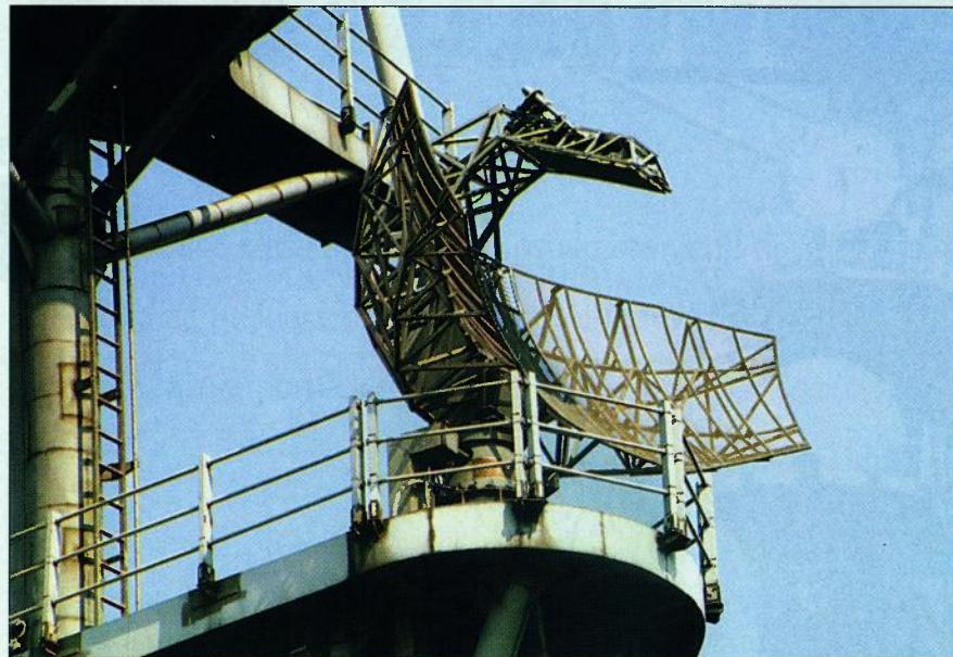
Za motrenje zračnog prostora na većini razarača klase *Spruance* služi radar AN/SPS-40
