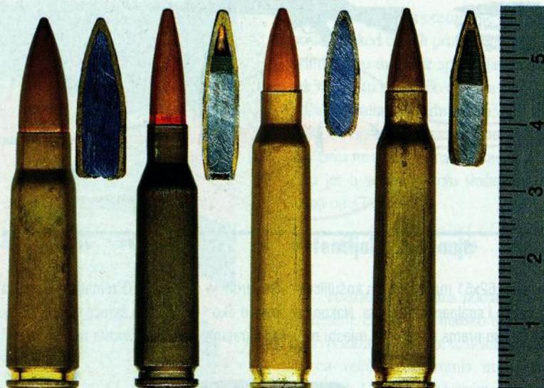
Izgled najpoznatijih metaka za jurišne puške i presjeci njihovih zrna. S lijeva na desno: 7,62x39 mm, za pušku AK-47, 5,45x39 mm za AK-47, 5,56x45 mm M193 i 5,56x45 SS109 za M16
