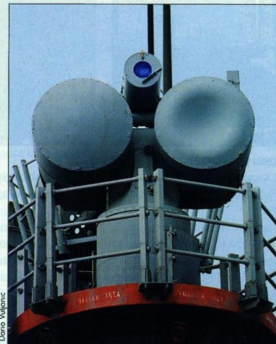
Za upravljanje paljbom PZ sustava Sea Sparrow služi sustav za praćenje i osvjetljavanje cilja Mk 95 s razdvojenim prijamnim i predajnim antenama, kao i TV kamerom iznad njih
