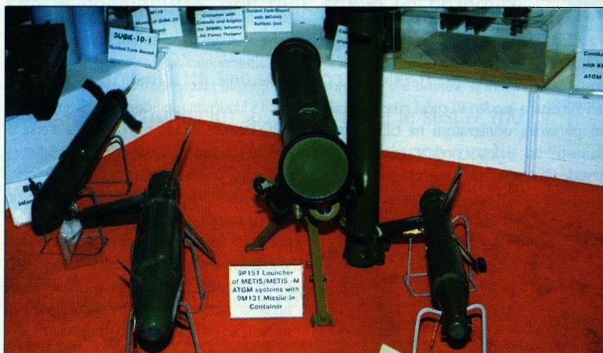
Na slici je prikazan PO lanser 9P151 s postavljenim kompletom rakete 9M131 Metis-M. Desno od lansera nalazi se starija inačica rakete 9M115 Metis izvan kontejnera, a lijevo novija inačica 9M131 Metis-M također izvan kontejnera
