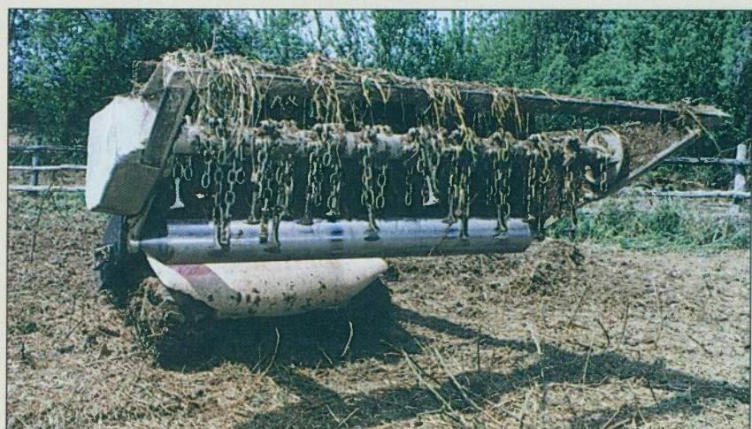
MV-2 rotacijom mlatila i udarom čekića kopa i razrahljuje sloj zemlje dubine do 20 cm, ovisno o odabranoj brzini
