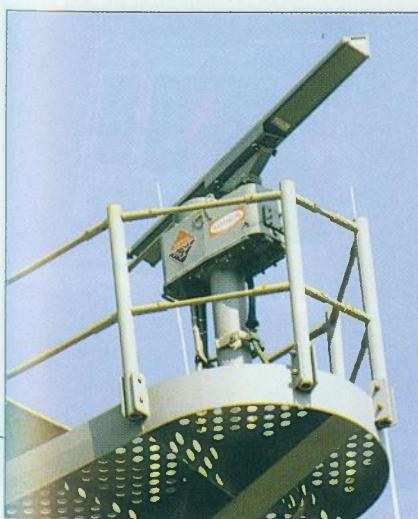
Antena navigacijskog radara AN/SPS-64
