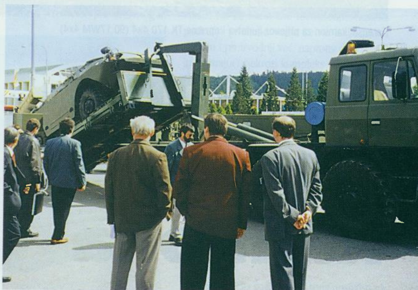
Prikaz jednog od mogućih rješenja (sustav paleta) za brzo i jednostavno prebacivanje različitih borbenih sustava i vozila
