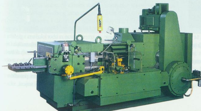
Tehnološki postupak u izradbi čahure strjeljiva za samokrese u kalibru 9x19 mm
