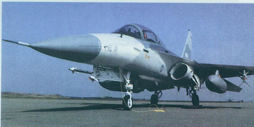
Tajvanski laki lovac Ching Kuo IDF, naoružan s dva projektila zrak-zrak srednjeg dometa TC-2 i četiri projektila zrak-zrak kratkog dometa TC-1. Ching Kuo bi mogao predstavljati model razvoja budućih lakih lovaca
