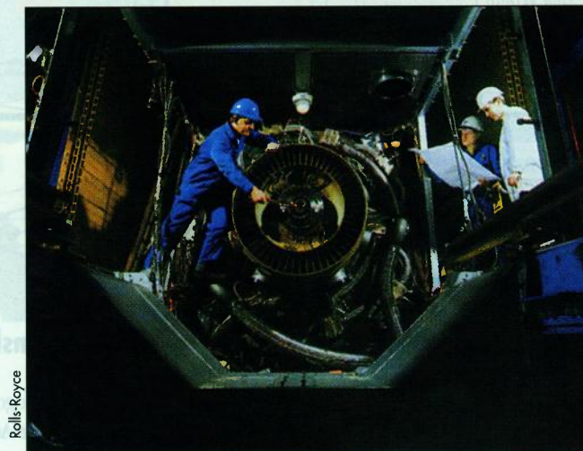
Pripreme za ispitivanje plinske turbine WR 21 s međuhlađenjem i prikupljanjem plinova (ICR)
