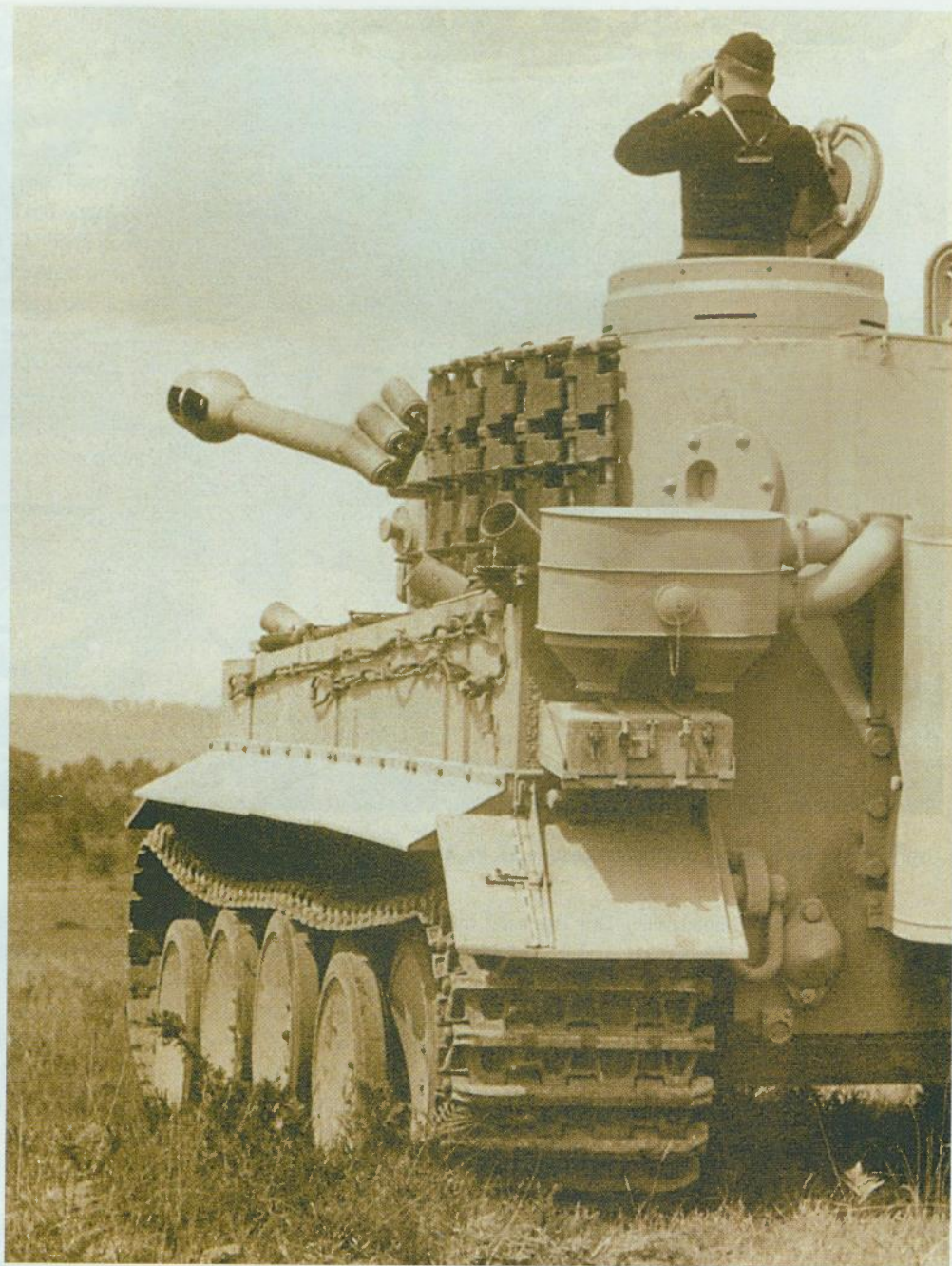
Tiger u Rusiji: vidi se filter Feifel na zadnjem dijelu tenka
