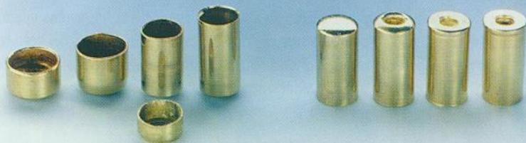
Tehnološki postupak u izradbi čahure strjeljiva za samokrese u kalibru 9x19 mm
