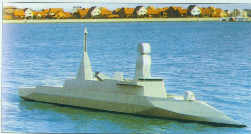
Za ispitivanja projekta Sea Wraith II izgrađen je daljinski upravljani model duljine 5,5 m
