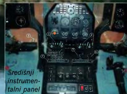
3. VOR/DME (VHF Omni Range = Svesmjeni radiofar/Distance Measuring Equipment = Uredaj za mjerjenje kose udaljenosti)
