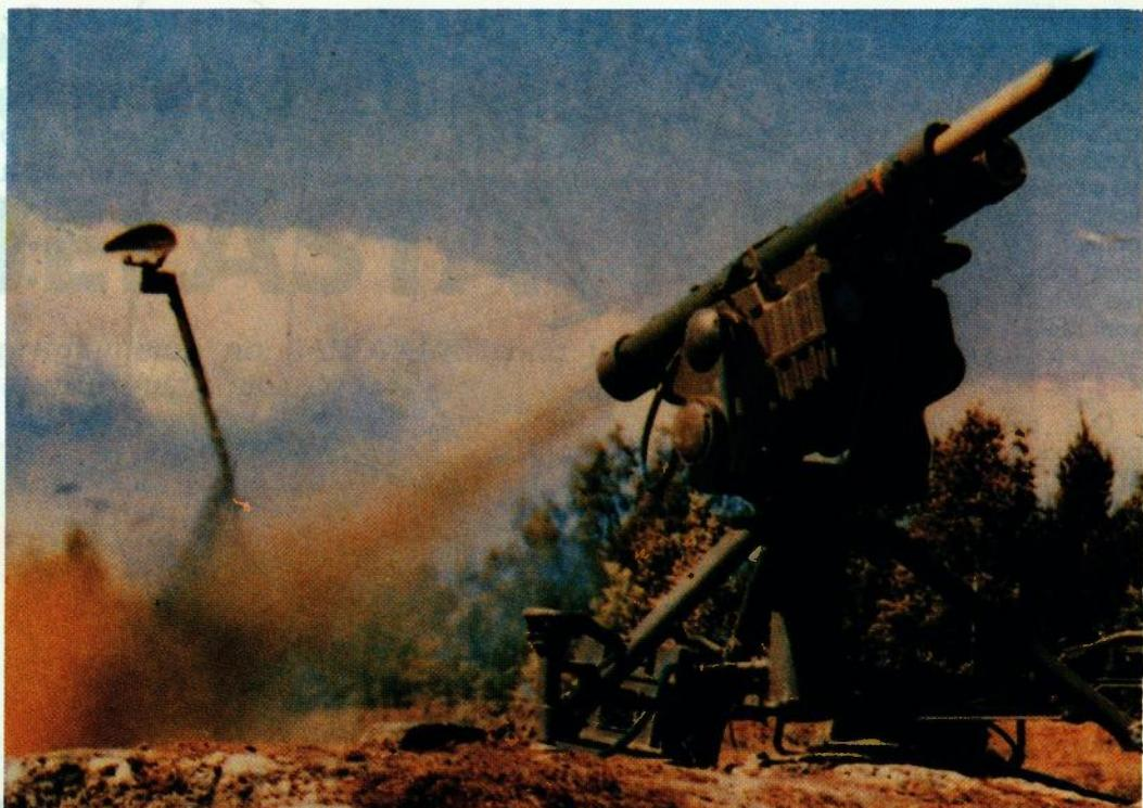
**RBS90 Mk2 raketa prigodom lansiranja s daljinski nadziranog dvostrukog lansera. Radar-ska antena (jasno vidljiva u pozadini) služi za otkrivanje i praćenje ciljeva**
