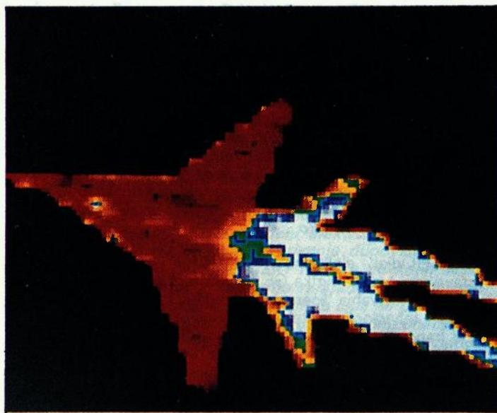
**Prikaz termovizijske slike zrakoplova MIG-29 dobiven pomoću termovizijske kamere tvrtke Amber Engineering. Tvrta proizvodi »nepokretnе« kao i skenirajuće matrice od različitih vrsta detektorskog tvari**
