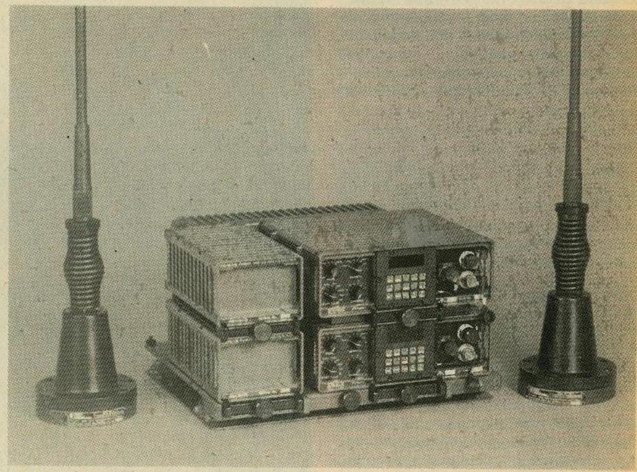
*Stacionarni VHF uređaj RAVEN 2V ujedinjuje primopredajnik (s mogućnošću izbora snage predajnika) i visokoselektivne filtere PV 4431*
