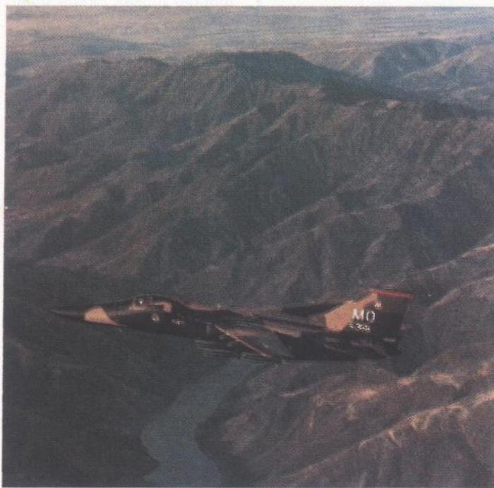
**TFR sustav omogućava F-111 niski let uz praćenje kontura terena što je uz elektronsko ometanje dobar način izbjegavanja detekcije od strane neprijateljskog radara**
