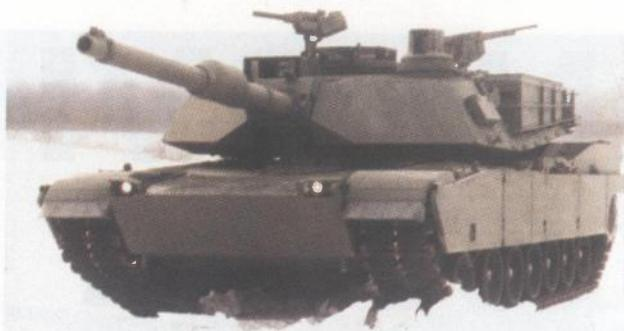
**Suvremeniji MBT tank ABRAMS M1A2 (SAD) naoružan topom kalibra 120 mm s glatkom cijevi**
