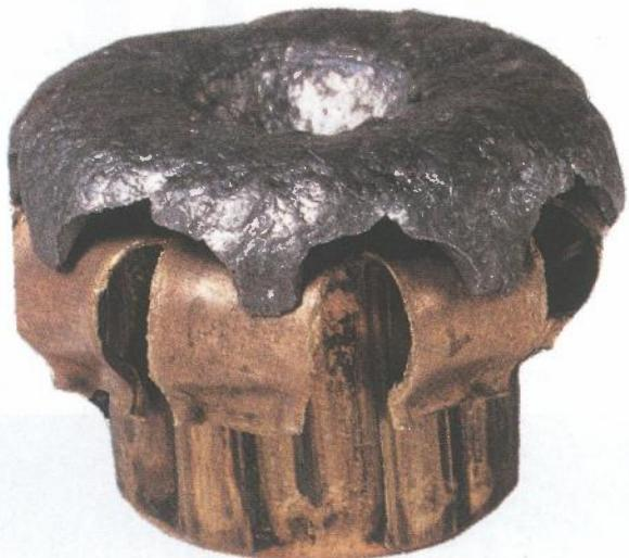
*Izgled zrna s mekanim vrhom nakon udarca u cilj*
