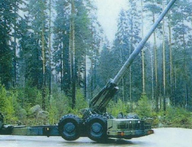
Tipični predstavnik vučnog topništva s ugrađenim APU pogonom. Finska top-haubica 155 GH 52 APU na paljbenom položaju s cijevi u maksimalnoj elevaciji
