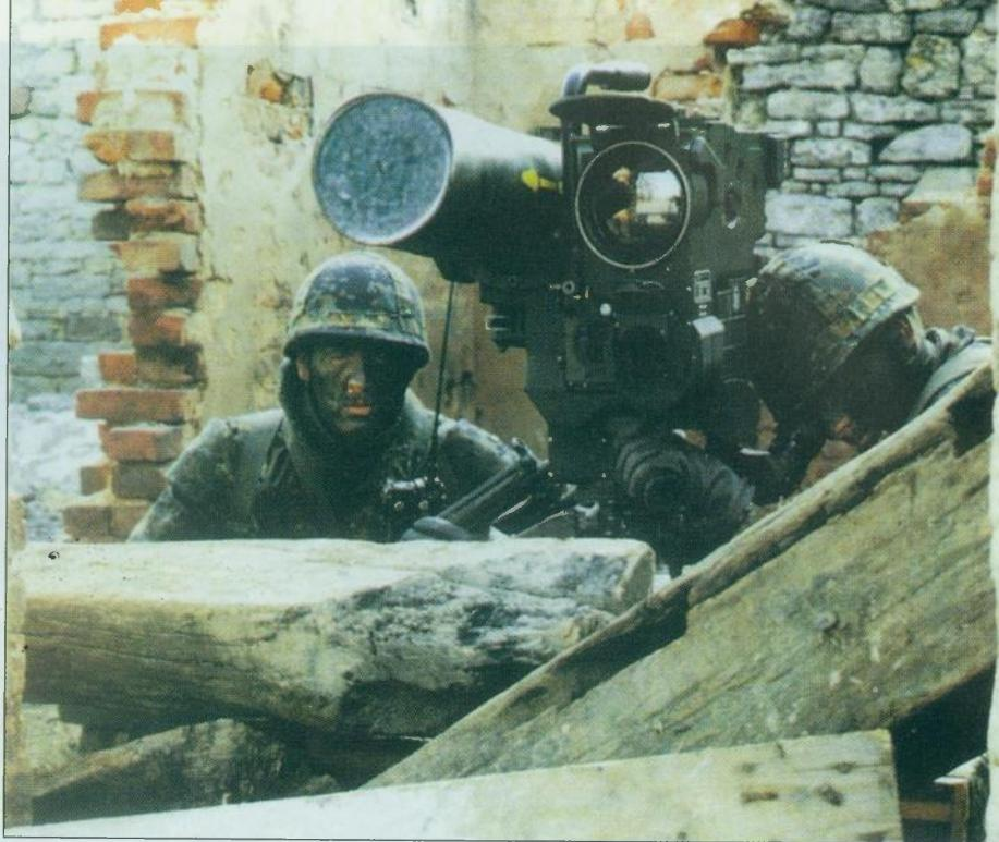
Protuoklopni vođeni raketni sustav TRIGAT-MR u bojnom položaju. Jasno se vidi termovizijska kamera sa svojim uskokutnim objektivom (velika leća) i bocom za hlađenje. Konstruktori su od starijeg sustava MILAN preuzeli nožice kao i isprobanoj termovizijskoj kameri MIRA sa klasičnim hlađenjem (na slici), odnosno moderniju kameru MILIS sa Stirlingovim mikrohladirom
