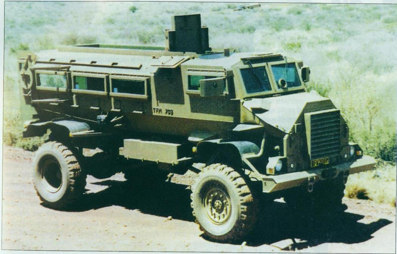
Casspir 4x4 je južnoafrički trupni transporter, oblikovan da zaštiti posadu od PT mina i strjeljačkog oružja, a u slučaju oštećenja omogućava brze popravke zamjenom sklopova i dijelova. Postavljanjem čeličnih kotača može poslužiti za uništavanje PP mina i redukciji sumnjivih površina
