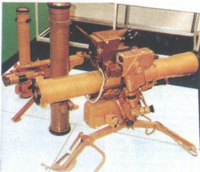
**Protuoklopni vođeni raketni sustav AT-5 SPANDRE (NATO—oznaka) ili KONKURS (Ruska oznaka) — prienosna inačica, s montiranom termovizijskom kamerom ruske proizvodnje, postavljena na jednoj izložbi naoružanja i vojne opreme. Kamera je kompaktne izvedbe a koristi standardne vojne baterije a za hlađenje komprimirani dušik. Vrlo se jednostavno i brzo postavlja**
