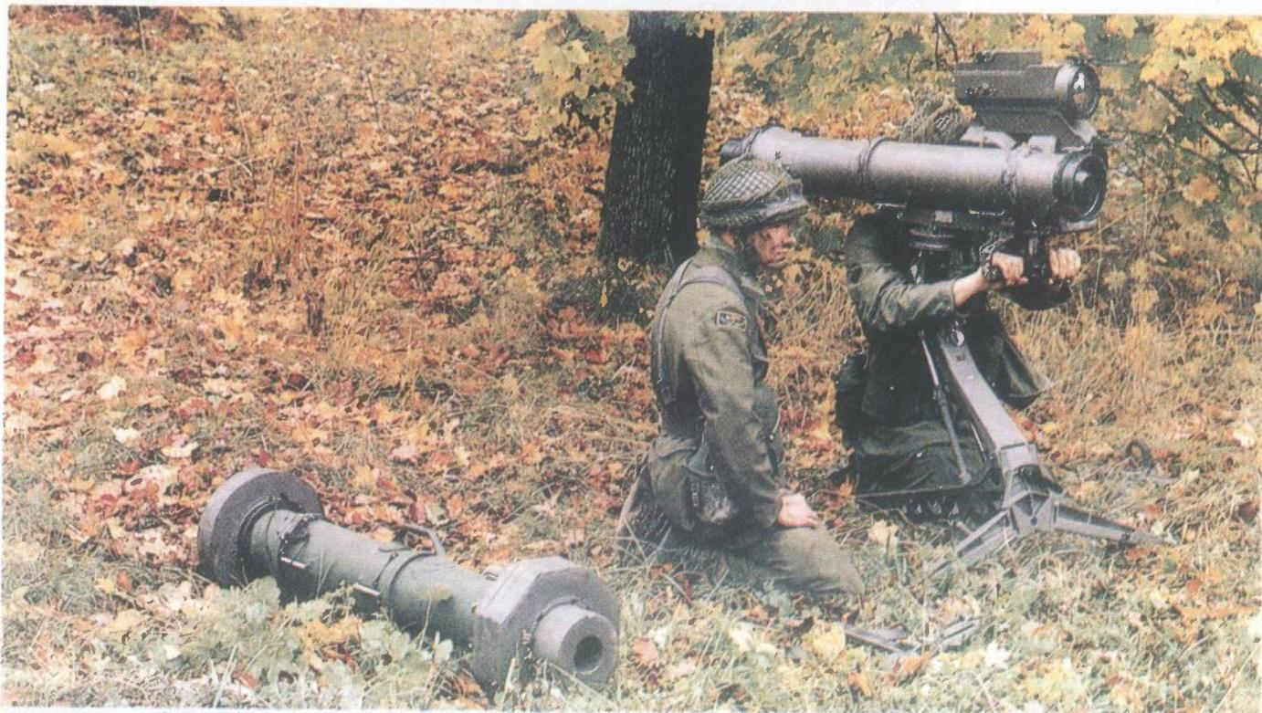
**Protuoklopni vođeni raketni sustav RBS56 BILL s TINS-om (engl., Thermal Imaging Night Sight — termovizijska kamera) — novija inačica**
