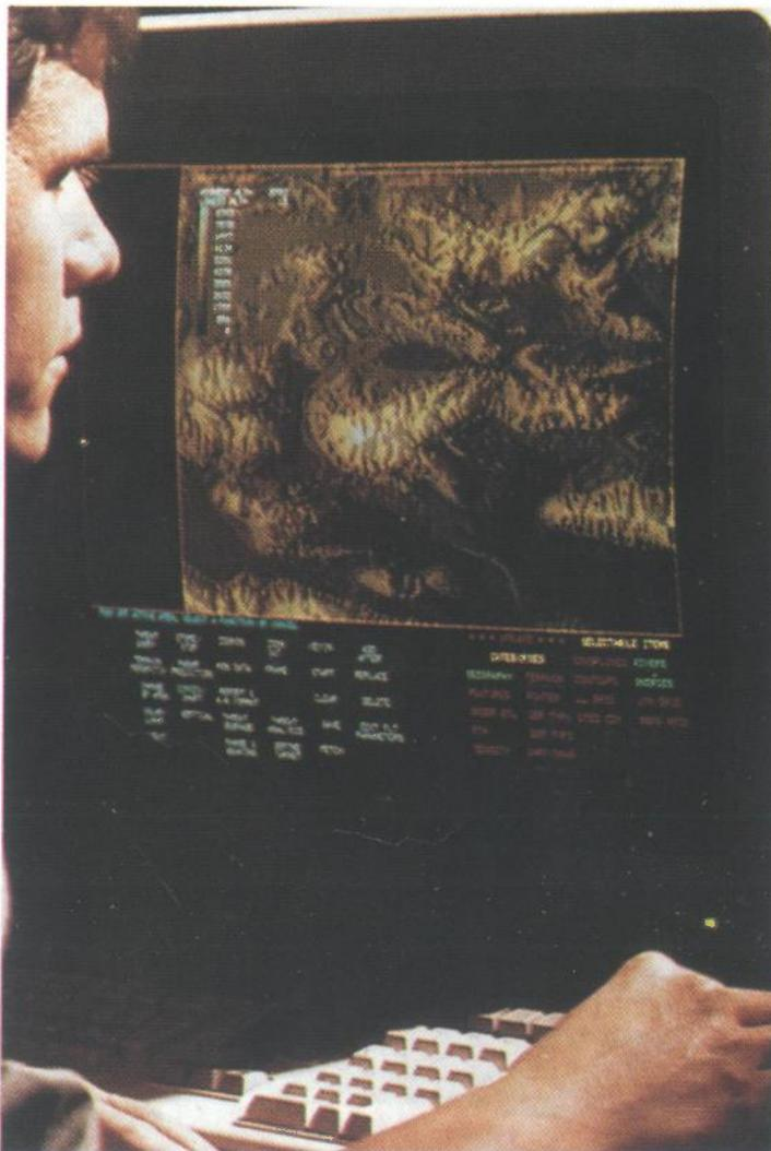
**US Navy & Marine Corps uporabljaju sustav TAMPS razvijenog tijekom Zaljevskog rata od strane McDonnell Douglas Missile Systems Company. Sustav podržava 27 različitih vrsta zrakoplova, osam helikoptera i tri oružna sustava**
