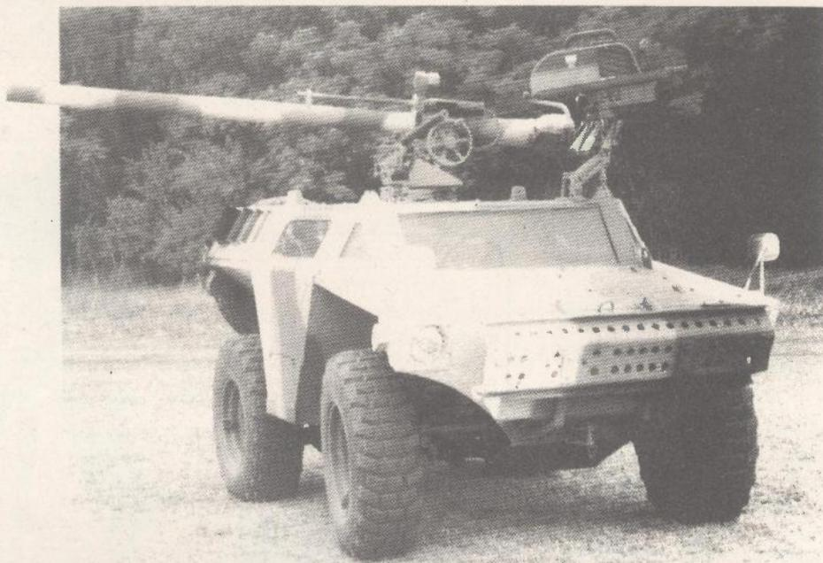
*Borbeno oklopno vozilo Iron Eagle opremljeno bestrajnim topom 106 mm na paletiziranom postolju, protuoklopnim raketnim lanserom Milan srednjeg dometa (na slici desno od topa) i strojnicom Browning kalibra 7,62 mm. Optimalno raspoređena i oblikovana pancirna stakla omogućavaju nesmetano periferno vidno polje i pogled naprijed, uz pružanje balističke zaštite od streljiva manjeg kalibra*
