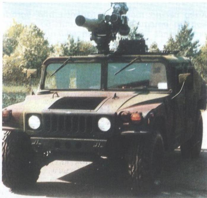
Sustav TOW2 montiran na terensko vozilo HUMMER. Na gornjem dijelu sustava jasno se uočava termovizijska kamera AN/TAS-4A
