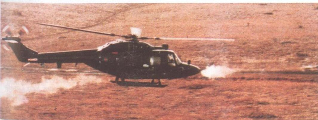
Helikopter WESTLAND LYNX opremljen je dnevnim ciljnikom za sustav TOW koji je montiran na krov iznad kabine, kao i noćnim TETS sustavom za izvođenje noćnih operacija
