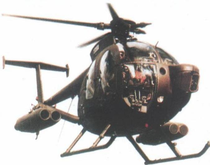
Helikopter serije 500 tvrtke McDonnell Douglas s ciljnikom montiranim na prednjem lijevom dijelu helikoptera
