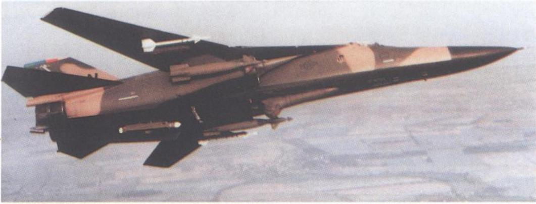
**F-111F opremljen *Pave Tack* sustavom, dvije laserski vođene bombe *GBU-10 Paveway II*, ometačem *ALQ-131* (na stranjem dijelu trupa) i dva *SIDEWINDERA AIM-9P***
