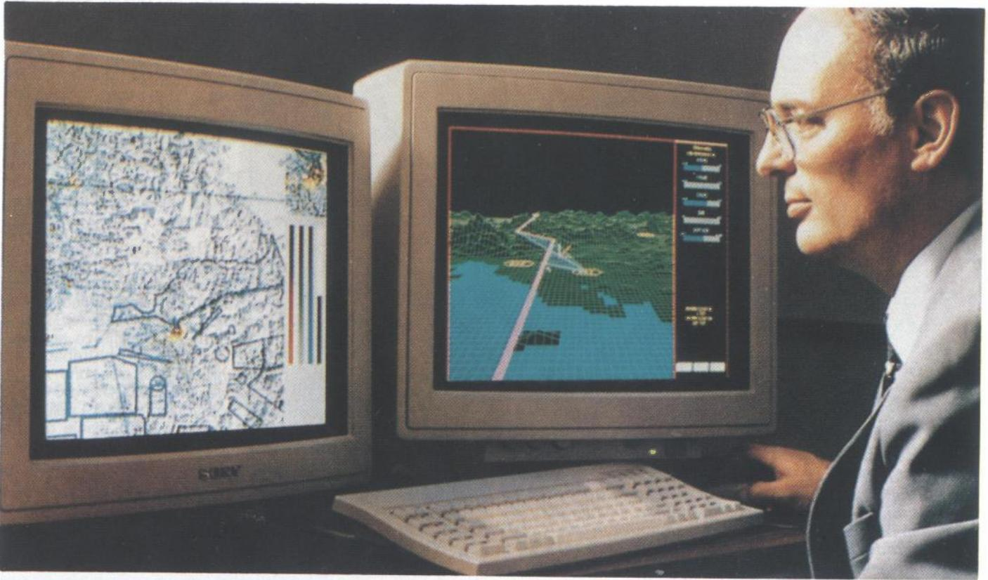
**Lockheed i McDonnell Douglas razvijaju novu generaciju sustava za planiranje bojnih zadaća. Na desnom pokazivaču je troprotežni prikaz putanje zrakoplova koji prodire u protivnički zračni prostor. Plavim poljima su prikazani dijelovi putanje u kojima je zrakoplov na udaru protivničke PZO. Lijevi pokazivač daje prikaz putanje zrakoplova, položaja protivničkih sustava obrane i njihova područja djelovanja, te ciljeva na digitalnom zemljovidu**
