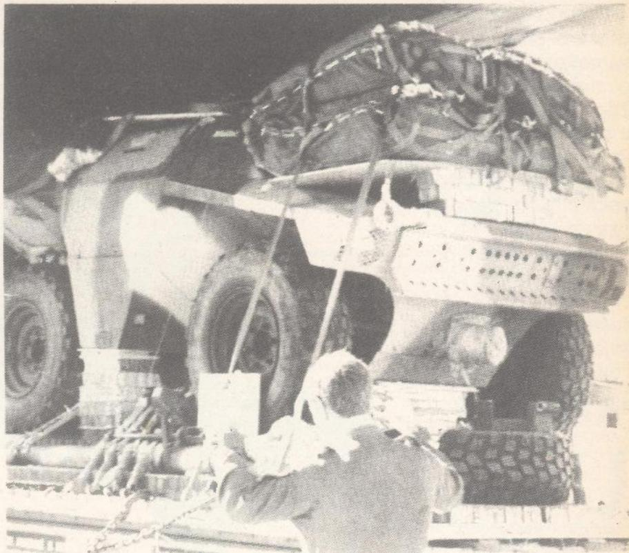
*Ukrcavanje Iron Eaglea pripremljenog za zračno izbacivanje u teretni prostor transportnog zrakoplova C-130 Hercules koji može ponijeti tri takva borbena oklopna vozila. Po uspješnom prizemljenju potrebno je deset minuta da bi se vozilo dovelo u operabilno stanje. Nužno je otpustiti i ukloniti trake koje vezuju vozilo za postolje, učvrstiti pričuvni kotač, ukloniti štitičke za prozore i sl.*
