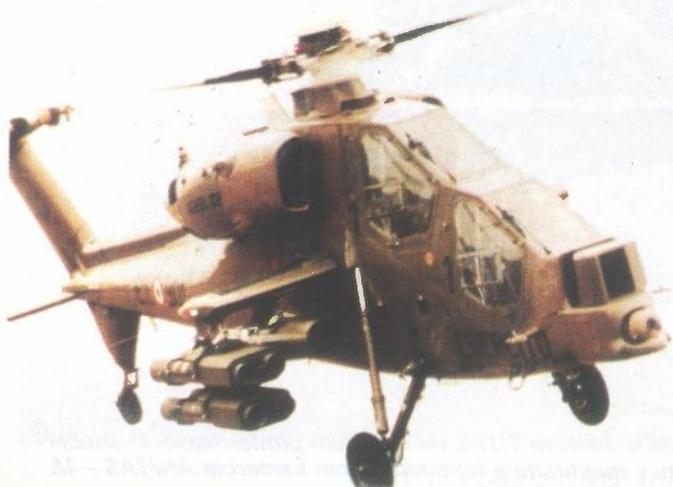
Saab HELITOW protuoklopní sustav montiran na helikopter AUGUSTA A129
