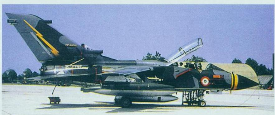
Prototip Tornooda IT-ECR, opremljen izvidničkim spremnikom. Ovaj zrakoplov je počeo ulaziti u službu početkom prošle godine
