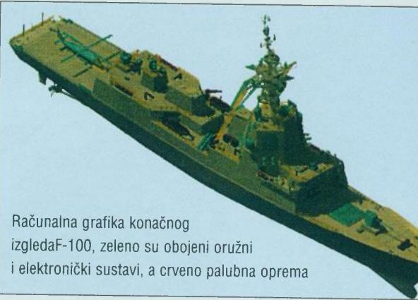
Računalna grafika konačnog izgleda F-100, zeleno su obojeni oružni i električni sustavi, a crveno palubna oprema
