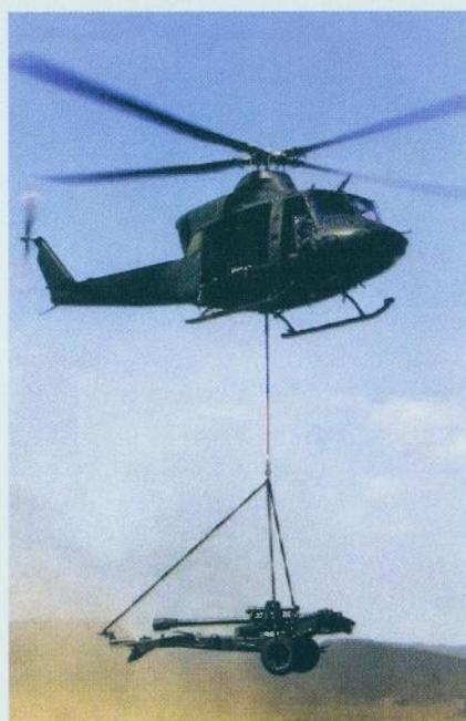
Način prenošenja francuskog topa 105 mm LG1 Mk II vrtoletom ovjesom u tri točke
