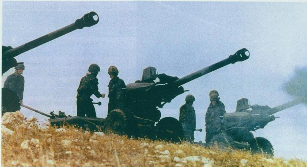
Britanski topovi 105 mm L119 na položaju za paljbu. Mogu se uočiti uređaji sustava za upravljanje paljbom
