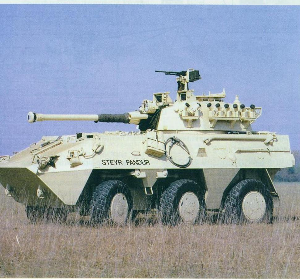
Pandur ARFSV 90, oklopno izvidničko vozilo za paljbenu potporu s tenkovskim topom 90 mm Cicerill MK III A1, mase 13 tona, 1+2 člana posade
