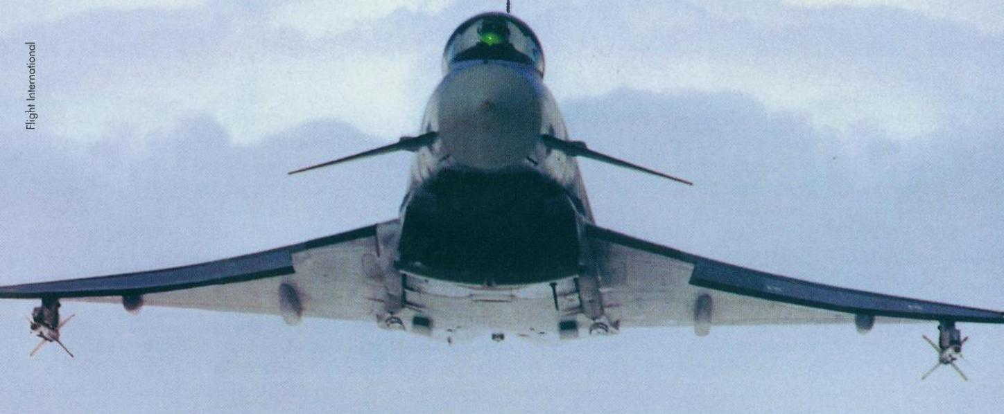
Jedno od svojstava Eurofightera je i konformalno nošenje projektila zrak-zrak smještenih na trupu zrakoplova
