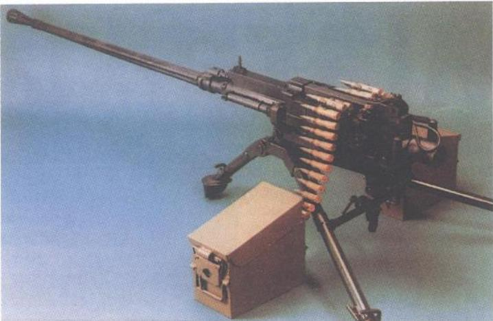
*Belgijska strojnica BRG-15 u kalibru 15,5 x 106 mm pokušaj je da se premosti jaz između mogućnosti strojnica u kalibru 12,7 mm i topova 20 mm*
