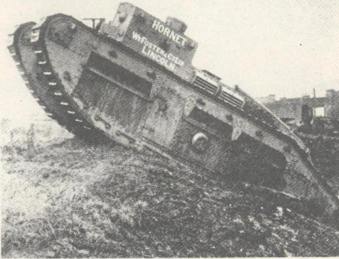
Prototip srednjeg tanka C, nazvan HORNET, ime proizvođača je ispisano na nadgradnji
