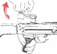
e) Vađenje nosača zatvarača sa zatvaračem
