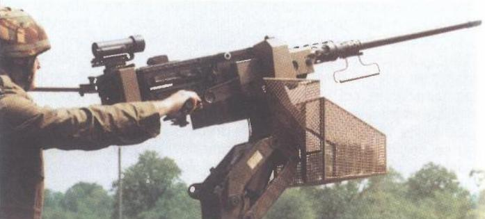
Singapsurska inačica teške strojnice 12,7 mm M2HB s dvojnim sustavom za donošenje metaka
