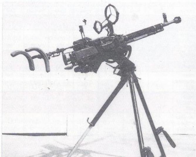
Teška strojnica 12,7 mm DŠK pripremljena za gađanje ciljeva u zraku. Ukupna težina s postoljem iznosi 92 kg, pri čemu sama strojnica teži 34 kg
