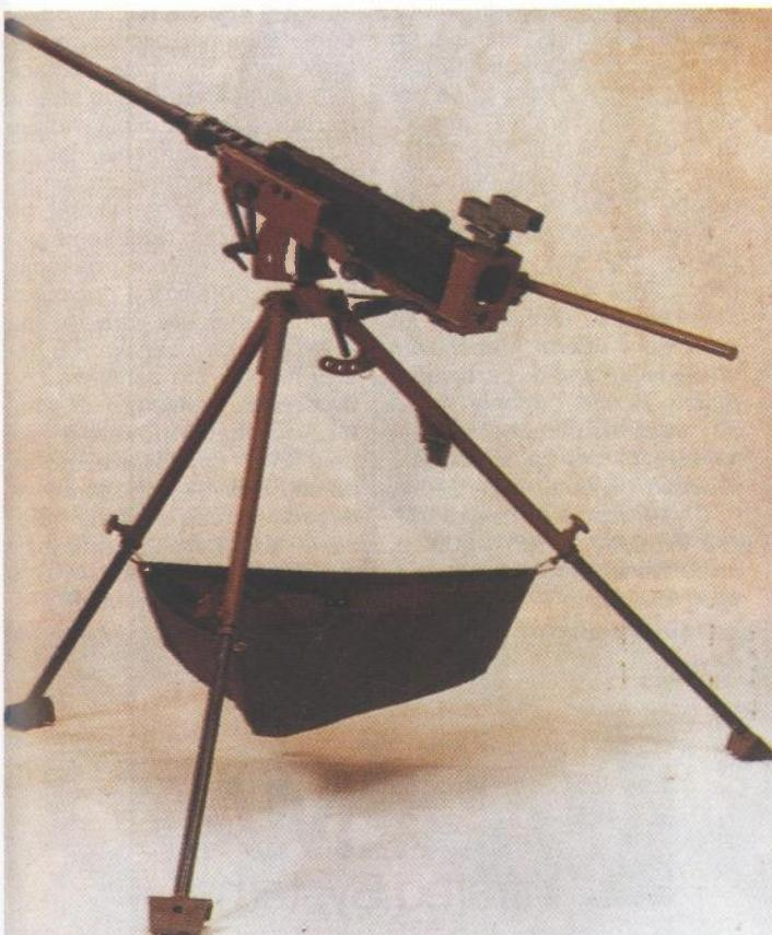
*Od postolja za strojnice zahtijeva se da omogućavaju gađanje cijjeva na zemlji i u zraku. Lijevo je prikazana strojnica na teleskopskom postolju s uvučenim krakovima, a desno s izvučenim kako bi se mogli gađati ciljevi u zraku*
