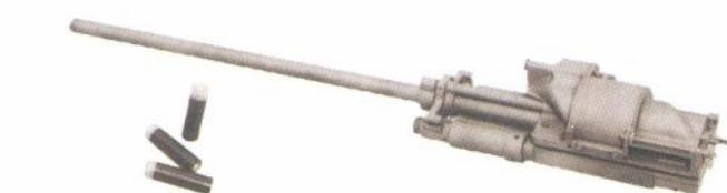
*Tvrta ARES proizvela je strojnici TARG u kalibru 12,7 mm BROWNING koja ima revolversku konstrukciju. Rotacijom bubnja s četiri ležišta metaka moguće je postići brzinu gađanja od 2000 metaka u minuti*
