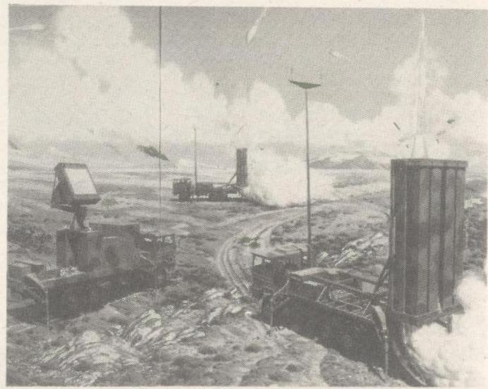
Umjetnički prikaz SAMP/T sustava prigodom djelovanja. Vozila s radarem i vozila s lanserima bit će naravno razvijeni na puno većem razmaku nego što je prikazano na slici
