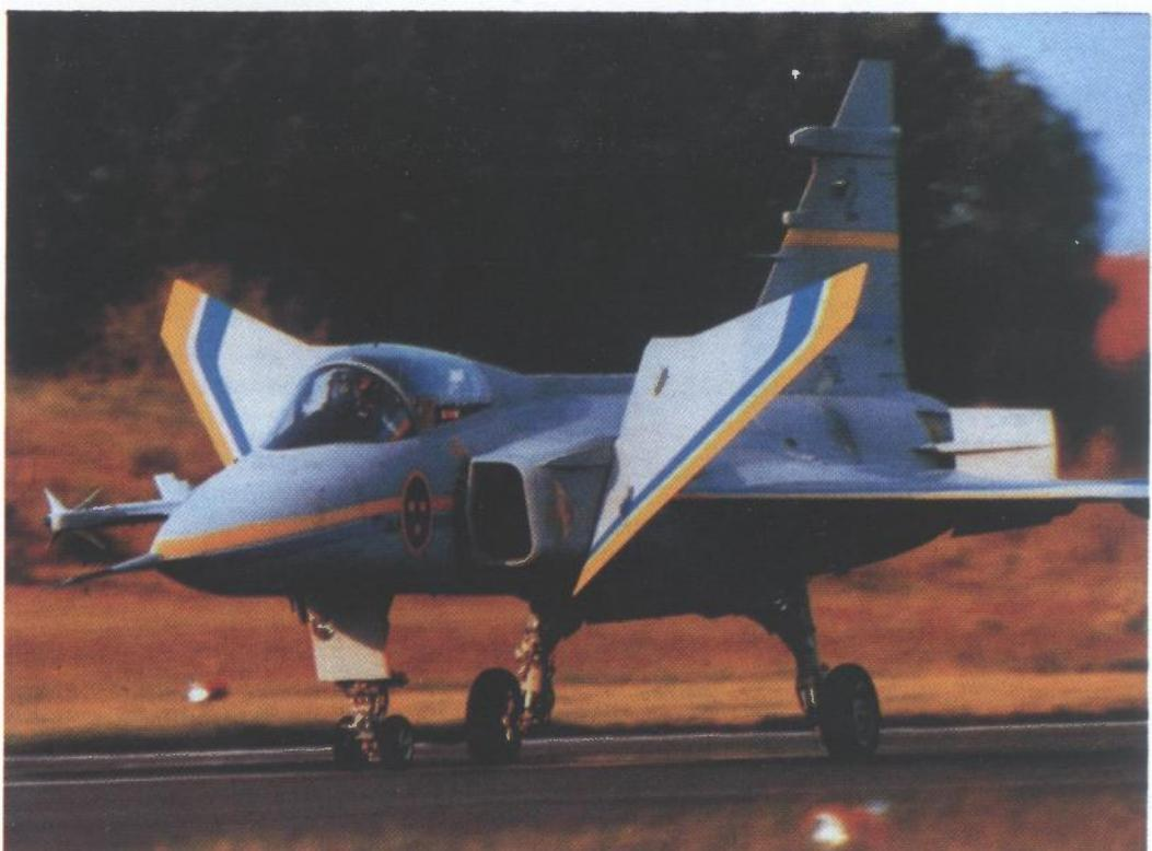
JAS 39 GRIPEN pri slijetanju: kanardi u kočionoj poziciji, aktivirane zračne kočnice
