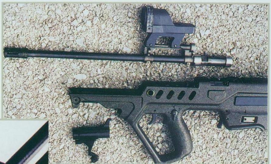
Specifičnost konstrukcije puške TAVOR je mjesto montiranja ciljnika, budući da je on pomoću nosača postavljen izravno na cijev, a ne na kućište puške
