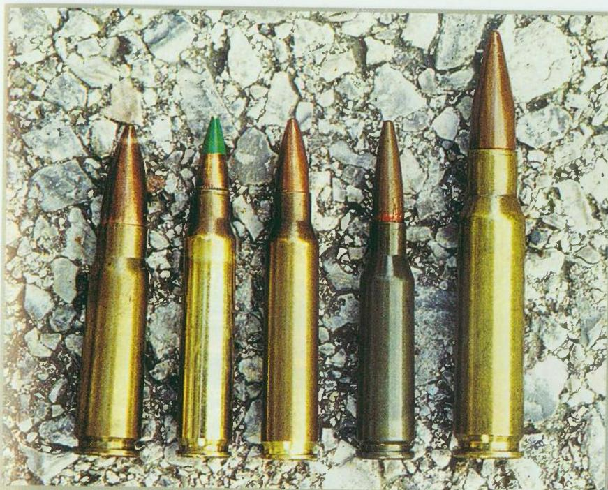
Razlike u izgledu najpoznatijih metaka za automatske puške (s lijeva u desno): 7,62x39 mm za pušku Kalašnjikov AK47, zatim 5,56x45 mm SS109 i 5,56x45 mm M193 za puške u kalibru 5,56mm, 5,45x45 za pušku Kalašnjikov AK74, te metak 7,62x51mm za puške FAL, G3 i slične
