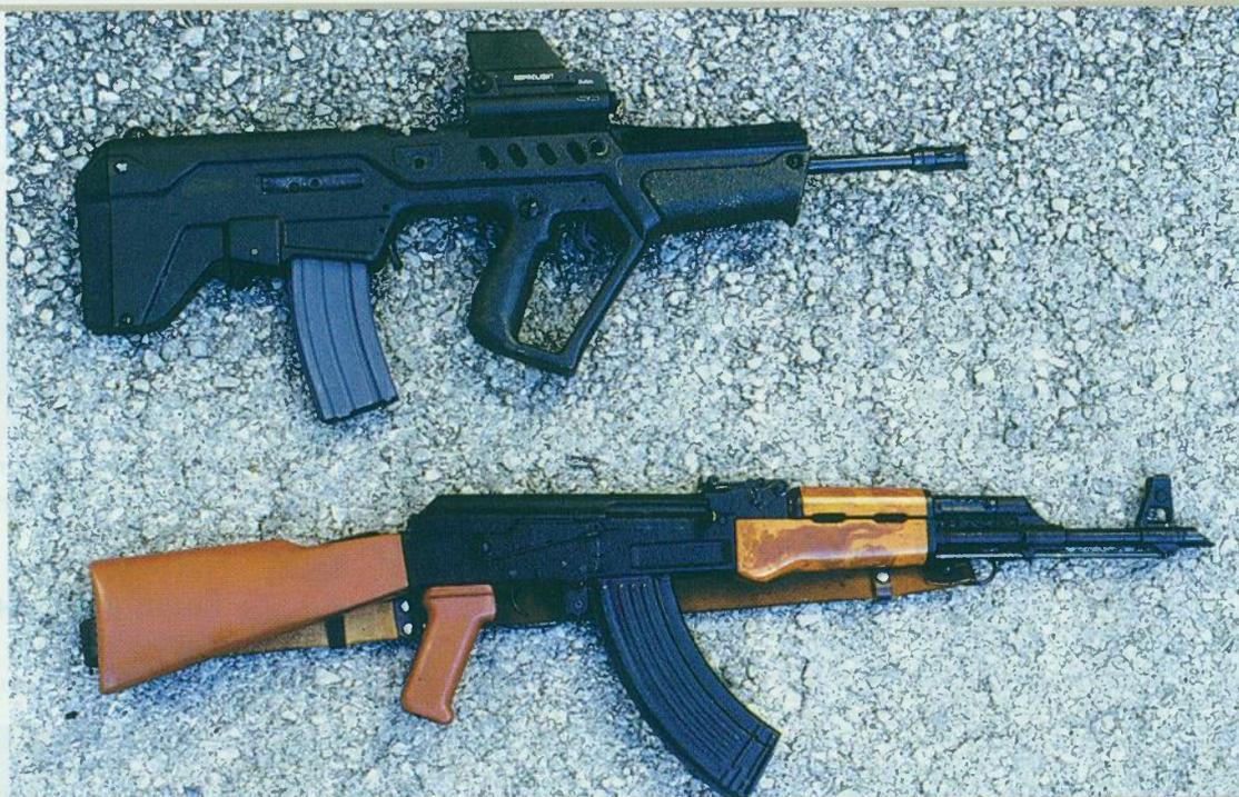
samo nosač zatvarača. To se radi tako da se u stražnjem dijelu kundaka potisne u stranu odgovarajući zatik, zakrene oslonac kundaka, te iz kundaka izvuče nosač zatvarača sa zatvaračem. Proizvođač navodi da je za temeljno održavanje dosta rastaviti oružje na ta dva sklopa, a da se samo povremeno ide na dalje rasklapanje nosača zatvarača. U tom se slučaju najprije odvaja povratna opruga s njezinom
