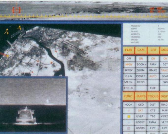
Na slici je prikazan display kakav koristi operator tijekom uporabe sustava HOT ATM. Na displeju mu se prikazuju svi podatci potrebni za uspješnu uporabu sustava, TV slika i termovizijska slika terena koji motri kao i slika digitaliziranog zemljovida područja na kojem djeluje. Ovim se sustavom uspostavlja i veza za prijenos podataka potrebnih za ostvarenje koordinacije paljbe na istoj razini kao i prema višoj zapovjednoj razini preko C<sup>3</sup> sustava
