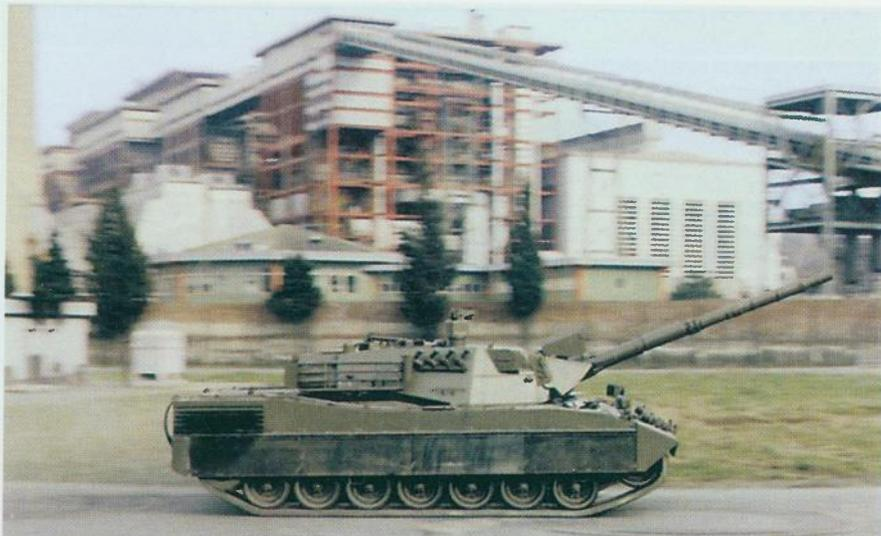
OTOBREDIN tenk OF40. Podvozje tenka je korišteno za realizaciju više projekata (kupola PZO topa 35 mm, 76 mm OTOMATIC, te samovozna haubica 155 mm Palmaria)
