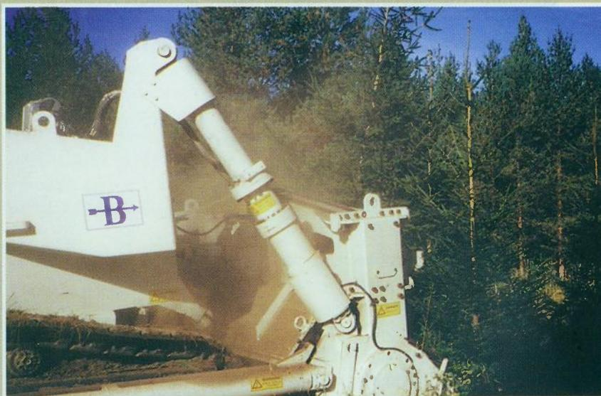
Uništavanje ukopanih PP mina i niske vegetacije. Sve ukopane mine su uništene. Tlo je očišćeno od mina. Rotor freze nije bio oštećen od protupješačkih mina ("pašteta")
