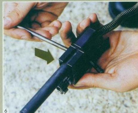
6 Vađenje osovinice zatvarača
