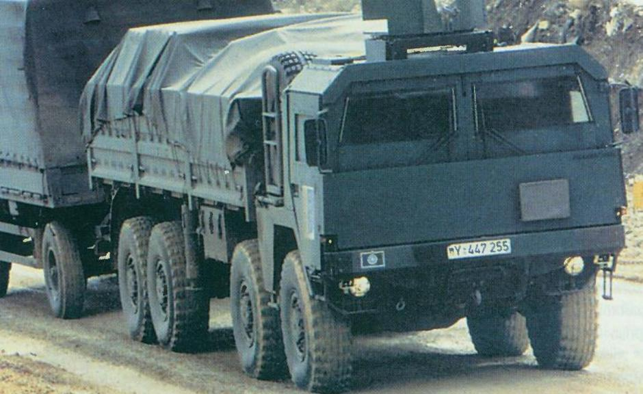
mački teški kamion MAN 8x8 s 5. stupnjem zaštite kabine (uključujući i ugradnju strojnice - MG)
