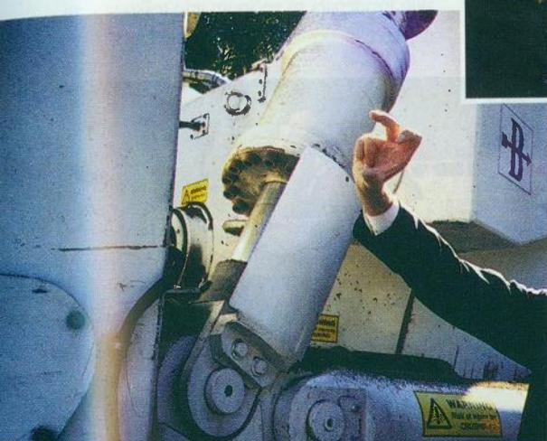
Amortizacija produženog impulsa sile eksplozije (12 kg TNT) s hidromehaničkim prigušenjem. Pomak od 70 mm se jasno vidi na klipnjači tilt hidrocilindra. Stroj je ostao čitav i ispravan, osim naravno rotora freze i štitnika koji se moraju popraviti
