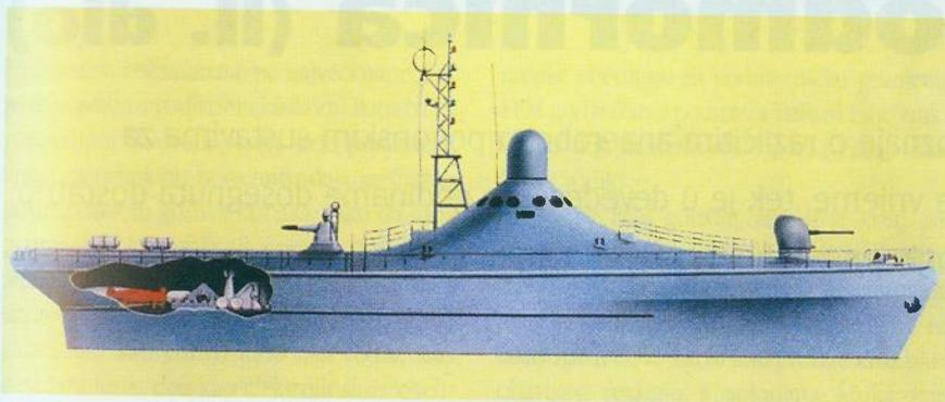
Njemačka tvrtka Abeking & Rasmussen predložila je sredinom osamdesetih projekt minolovca niske zamjetljivosti, MWV 2000. Oble plohe trupa i nadgrađa, izgrađene od nemagnetskih tvoriva, trebale su smanjiti radarsku i magnetsku zamjetljivost
