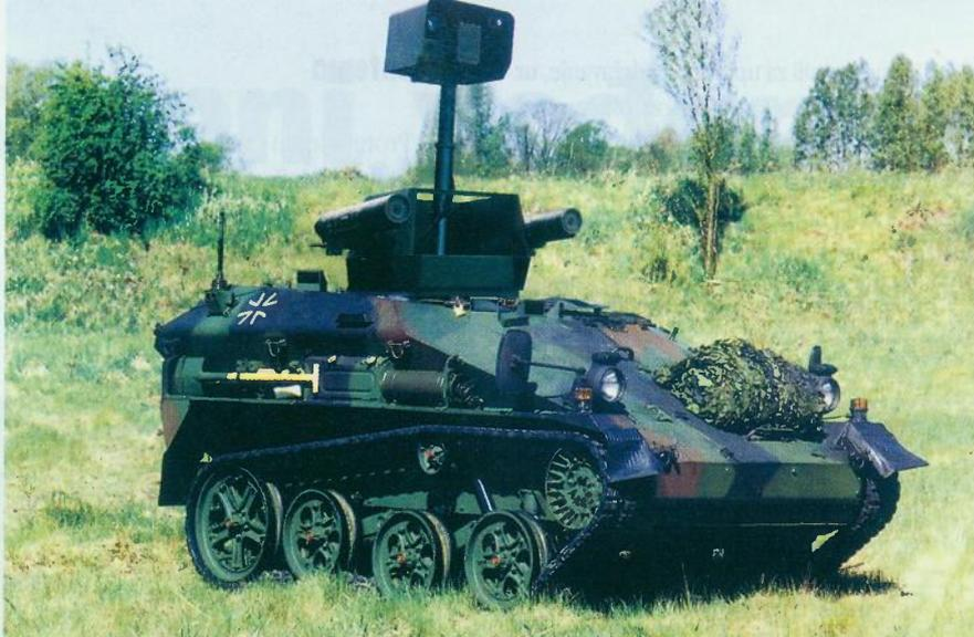
HOT ATM sustav instaliran na Wiesel mini oklopno vozilo na gusjenicama njemačke vojske. Ovakvo vozilo ima mali obris na bojištu, visoku prohodnost zahvaljujući pogonu na gusjenice kao i veliku paljbenu moć zahvaljujući instaliranom PO modularnom sustavu HOT
