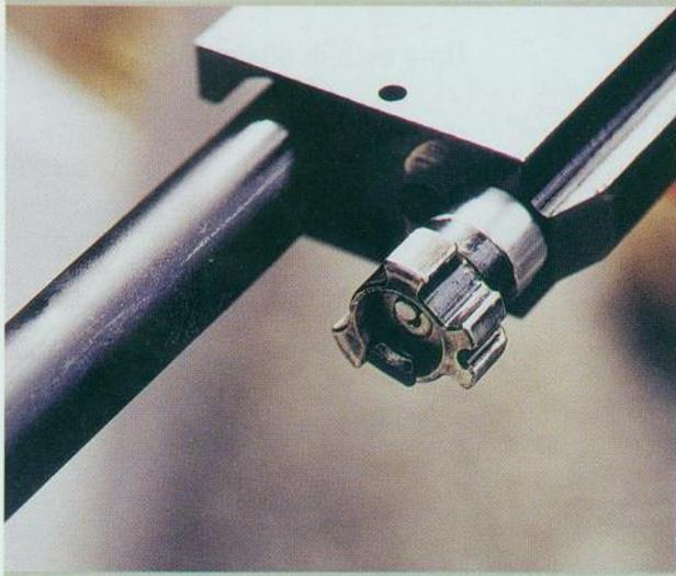
Bravljenje se obavlja rotacijom zatvarača u desnu stranu kao kod puške Kalašnjikov. Razlika je u načinu izbacivanja čahure jer se i izvlakač i izbacivač nalaze na glavi zatvarača
