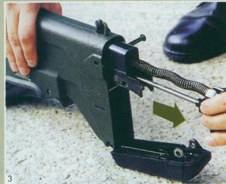
3 Vađenje nosača zatvarača sa zatvaračem
