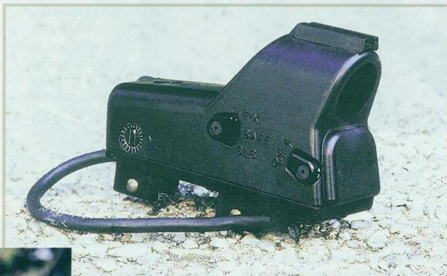
Integrirani ciljnik MARS uključuje u sebi laserski označivač cilja i ciljnik sa svjetlećom točkom. Vidi se preklopnik koji omogućava zauzimanje daljina gađanja do 400 m te preklopnik za tri različita načina uporabe. Sasvim naprijed je vijak za korekciju položaja crvene točke
