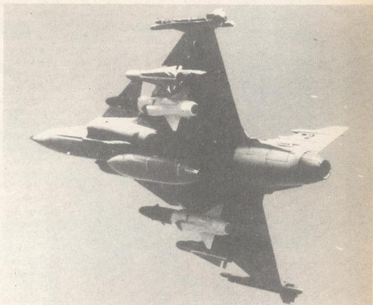
GRIPEN s borbenim teretom od dva protubrodsko projektila RBS-15F i dvije vođene rakete MAVERICK
