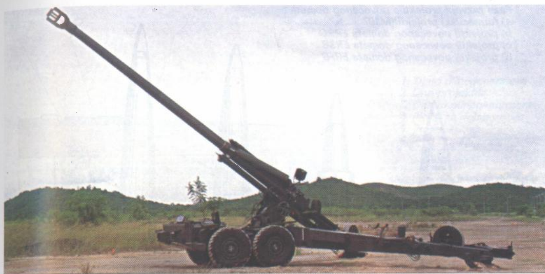
Moderni topnički sustav s dužinom cijevi 52 kalibra i dometom 40 kilometara
