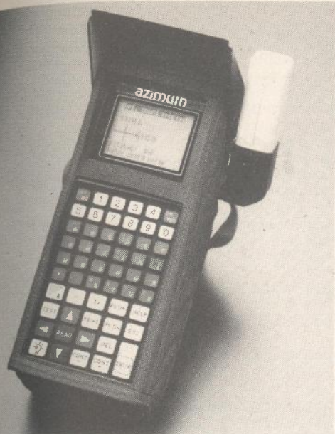
Slika 2. Vojni ručni taktički terminal (TAC-TER) razine osobnog računala (PC) izraelske tvrtke AZIMUTH koji u sebi sadrži GPS prijamnik
