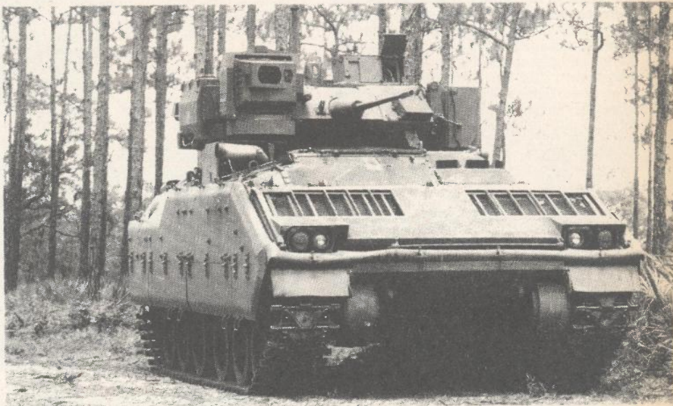
Oklopni transporter BRADLEY s eksperimentalno pričvršćenim niskoenergetskim laserom (LEL) tvrtke Martin Marietta koji nosi naziv STINGRAY: Ovaj je laser montiran na kupoli unutar »kutije« na desnoj prednjoj strani kupole a namijenjen je za zasljepljivanje neprijateljskih elektronskih i optičkih senzora. Iako su dva STINGRAY-a bila montirana na to vozilo i korištena tijekom Zaljevskog rata ne zna se da li su korištena i u boju
