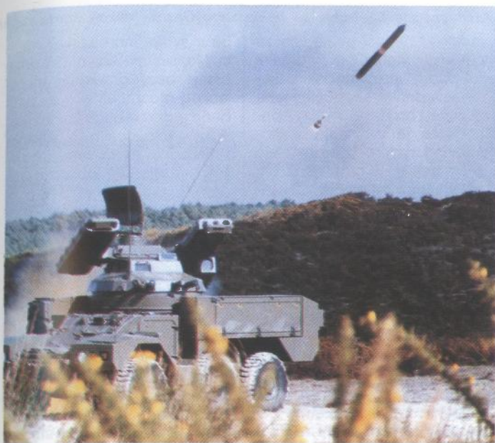
Santal inačica sustava Mistrale na vozilu Panhard ERC
