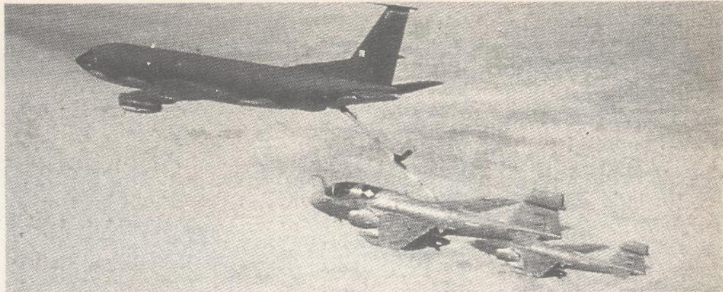
Mnogi EW zrakoplovi dobiveni su modifikacijom dizajna bombardera ili jurišnika, kao što je to slučaj s američkim zrakoplovom EA-6B
