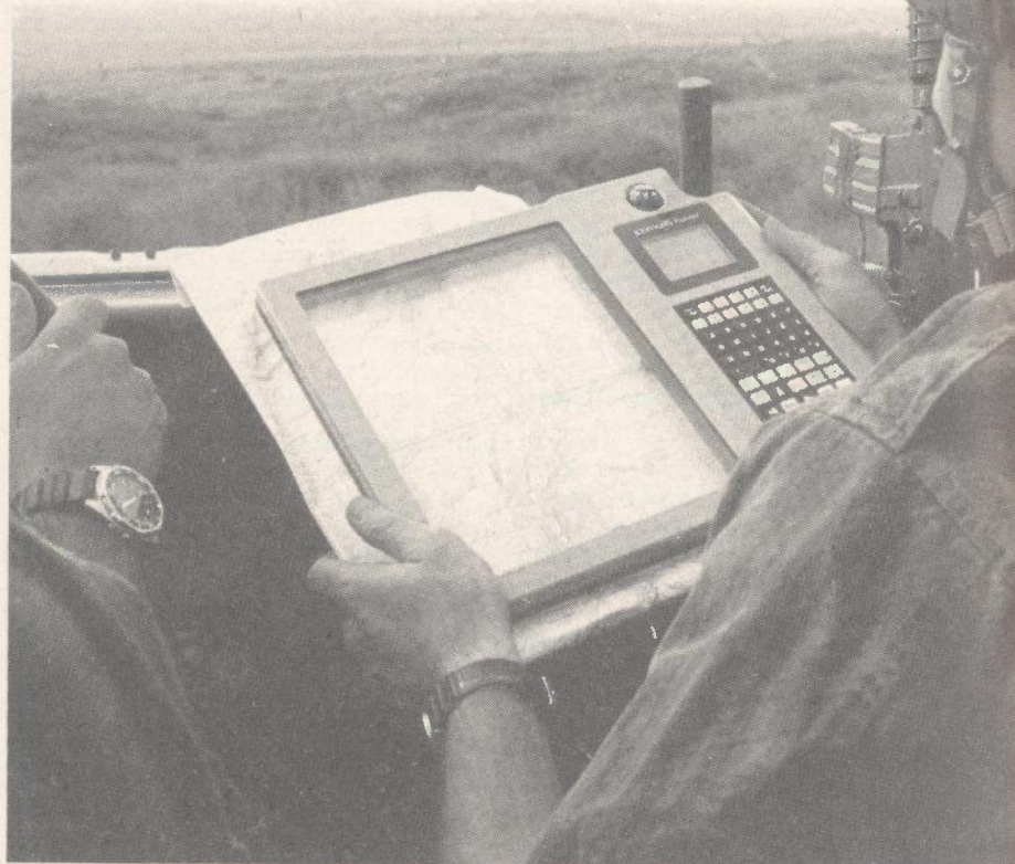
Slika 1. Prijenosni autonomni GPS navigacijski uređaj izraelske tvrtke AZIMUTH koji na zemljovidima različitog mjerila prikazuje putanju vozila ili osobe koja ga nosi. Križanje pomičnih niti označava trenutačni položaj na zemljovidu
