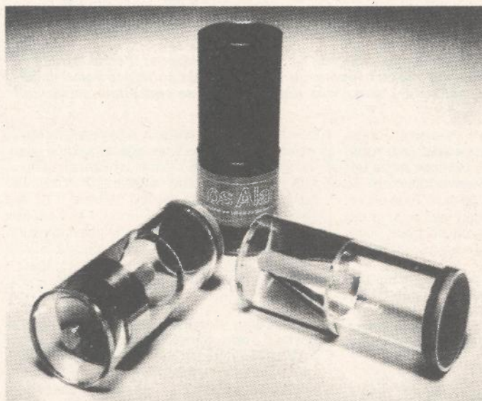
Jedan od tipova laserskog oružja predstavljaju i 40 mm projektili koji sadrže laser a u stanju je da zaslijepi elektro-optičke senzore. Prozirne plastične šipke se lako mijenjaju
