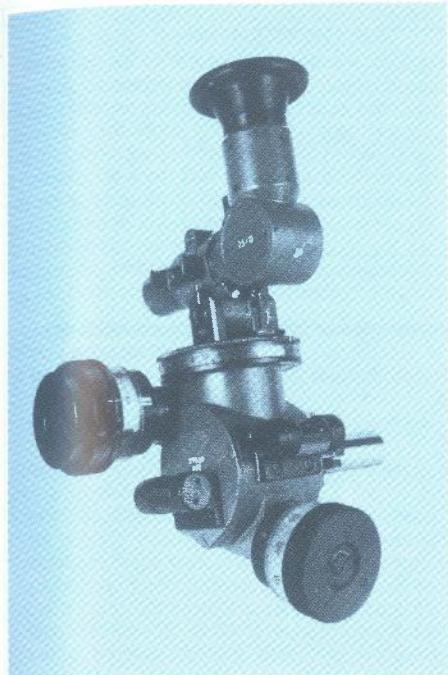
Ciljnička naprava PHOTONIC A-82 1/6400 s tricijskim osvjetljenjem
