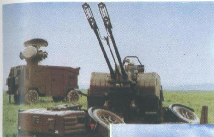
*Bez kvalitetnog sustava za upravljanje paljborom učinkovitost protuzrakoplovnih topova bila bi znatno smanjena. Na slici je prikazan sustav SKYGUARD i top 35/2 mm GDF-005*
