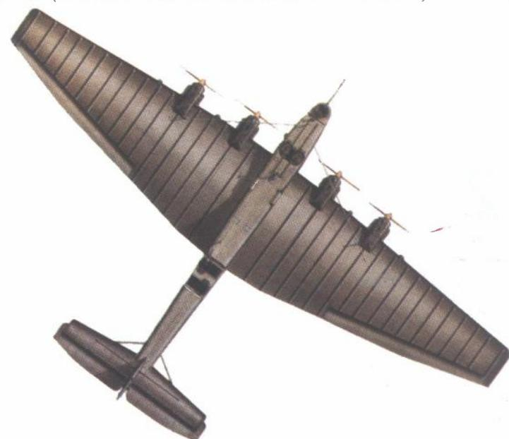
Prototip nakon ugradnje motora BMW VIz
