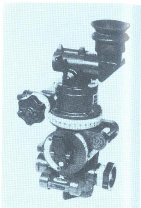
*Ciljnička naprava C2A1 1/6400 s tricijskim osvjetljenjem*
