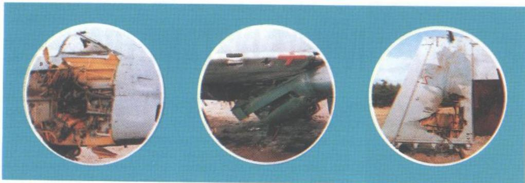
Izgled dijelova zrakoplova nakon pogađanja razorno-zapaljivom granatom kalibra 35 mm
