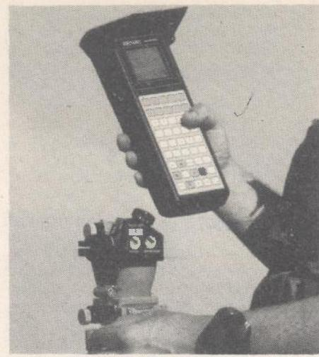
Slika 6. NORS 61 je proizvod tvrtke »Azimuth«. Čini ga mala optička naprava s taktičkim terminalom (takterom) koji se može isporučivati s ugrađenim GPS prijamnikom.
