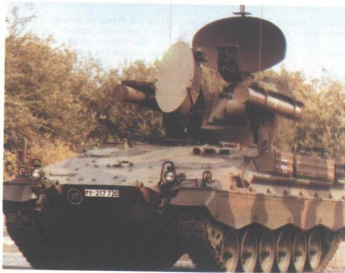
Slika i crtež njemačke inačice sustava Roland 2 postavljenog na podvozju oklopног transportera Marder
