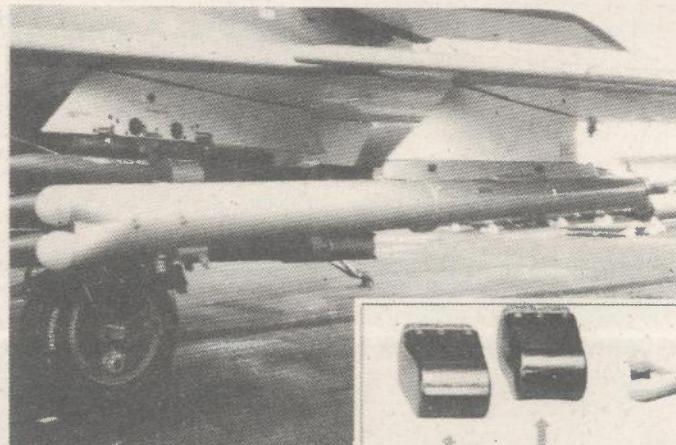
**Ometački sustav Thomson-CSF BAREM dizajniran je za osiguranje visokog stupnja zaštite borbenih zrakoplova i helikoptera pri izvršavanju različitih borbenih misija; na slikama je prikazan spremnik na potkrilnom nosaču, te glavne komponente sustava**
