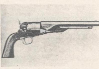
Revolver COLT ARMY 1860. godina, kalibra 0.44 palca, sustava SA, punio se sa šest naboja – papirni naboji s metkom i crnim prahom ili u ležaj nasipani crni prah, zatim kugla pa sve to zatvoreno maštu ili vazelinom, i bio je najzeljeniji revolver gradiškog rata u SAD. To je tzv. STREAMLINED model. Vojski Unije je, između 4. siječnja 1861. do 10. studenoga 1863. godine, ukupno dano 107.156 komada tog revolvera. Vojna mu je nomenklatura NEW MODEL ARMY REVOLVER
