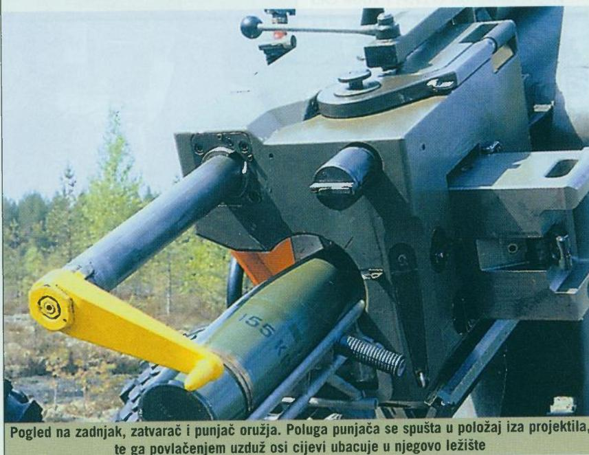
Pogled na zadnjak, zatvarač i punjač oružja. Poluga punjača se spušta u položaj iza projektila, te ga povlačenjem uzduž osi cijevi ubacuje u njegovo ležište
