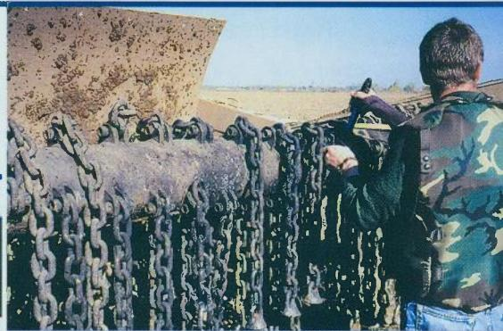
Brza zamjena oštećenih mlatila od eksplozije PT mine na prednjem rotoru s priručnim alatom
