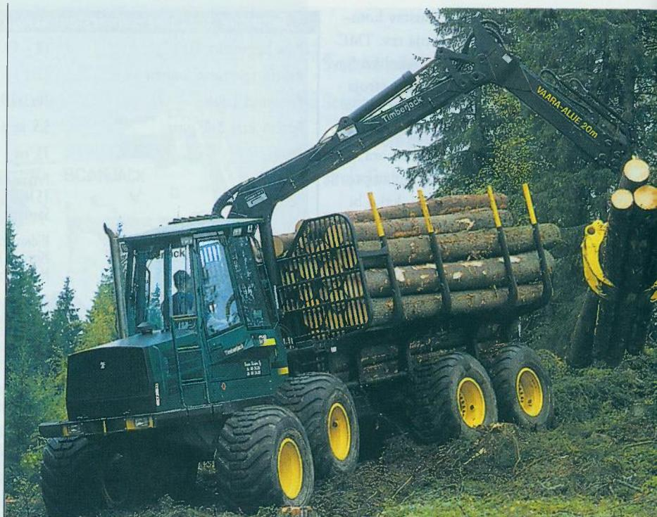
Šumarski stroj Timberjack 1710 Forwarder 8x8 na utovaru trupaca radi prijevoza po teško prohodnom terenu (nosivosti 17 t) je temeljnica stroja za razminiranje Scanjack 3500
