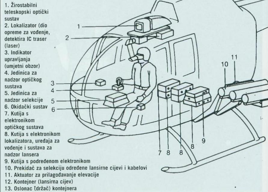
Na slici su prikazane sastavnice vrtoletske inačice HOT sistema. Tu je kao platforma prikazan njen vrtoljet BO-105P s optičkim sustavom APX-387
