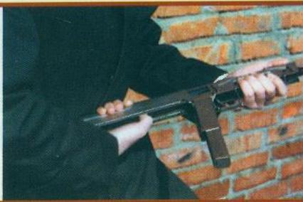
mm. Početna brzina projektila je 290 m/s, dakle podzvučna što omogućuje dobro prigušenje pucnja nakon što se na usta cijevi montira prigušivač. Strojnica ima metalni sklapajući kundak, a punjenje se obavlja iz spremnika kapaciteta 20 metaka. Ukupna dužina oružja je 380 mm, a masa s napunjennim spremnikom od 20 metaka manja je od dva kilograma.
