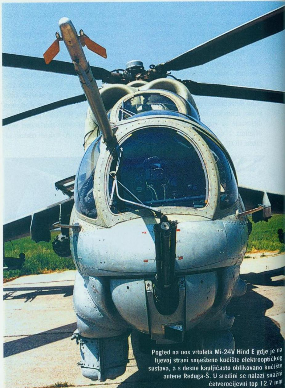
Pogled na nos vrtoleta Mi-24V Hind E gdje je na lijevoj strani smješteno kućište elektrooptičkog sustava, a s desne kapljičasto oblikovano kućište antene Reduga-Š. U sredini se nalazi snazični četverocijevni top 12.7 mm
