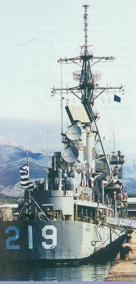
Ispod antene radara AN/SPS-52 uočavaju se dvije antene radara za upravljanje paljborom AN/SPG-51
