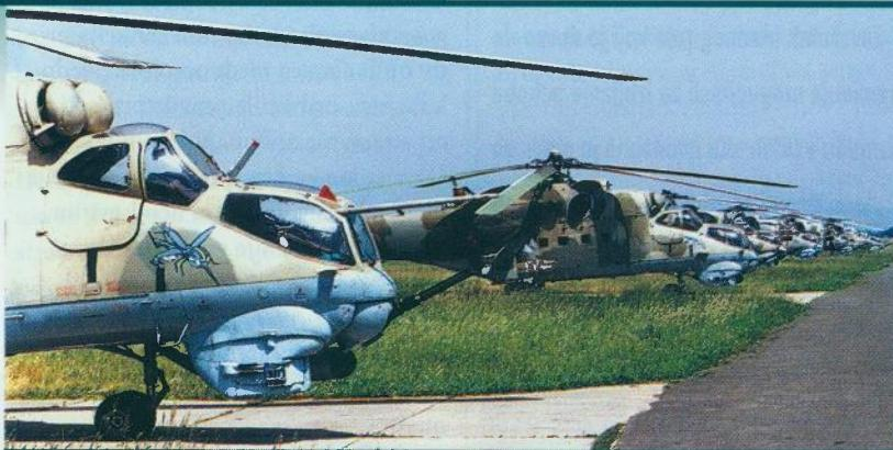
naoružan PO vođenim raketama 9M114 Kokon, on može na potkrilnim nosačima nositi i sačaste lansere za nevodene rakete zrak - zemlja koje su se pokazale prilično učinkovite i tijekom bojnih djelovanja vrtoleta Mi-24 za vrijeme operacije "Bljesak" u zapadnoj Slavoniji na početku svibnja 1995. U nosu vrtoleta postavljena je četverocijevna strojnica 12.7 mm s vrlo velikom brzinom (gustoćom) paljbe.
