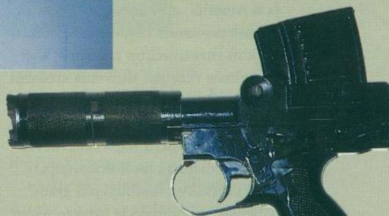
**Uredaj namijenjen spajaju različitih elemenata za čelične ili betonske ploče tijekom specijalnih operacija. Podjednako dobro radi i pod vodom. Kapacitet spremnika je šest metaka**
