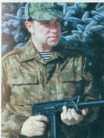
Kratka strojnica 9x18 mm Kiparis ostvaruje brzinu gađanja od 800-900 metaka u minuti
