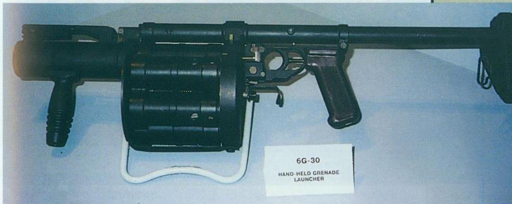
Bacač granata 6G-30 ima bubanj u kojem se smješta šest granata kalibra 30 mm, te metalni kundak na izvlačenje
