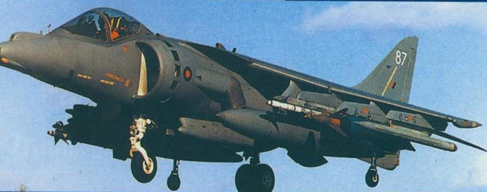
RAF-ov Harrier opremljen laserski vođenim bombama Paveway II
