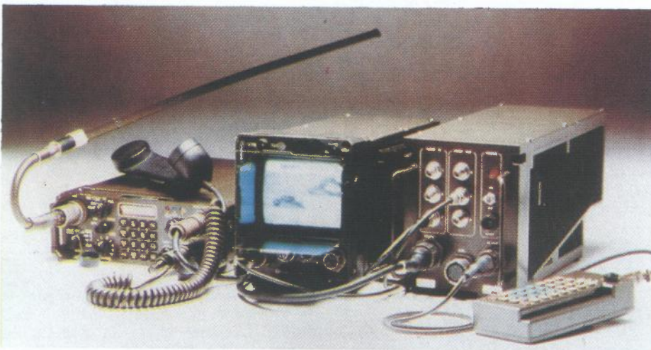
Slika 5. Sustav ITS-250/V namijenjen je za vozila a smješten je u kutiju protežnosti 19x 33.5x 14.7 cm, mase 7.7 kg. Lijevo od pokazivača je Tadiranov VHF radio s mogućnošću 16 kb/s prijenosa podataka
