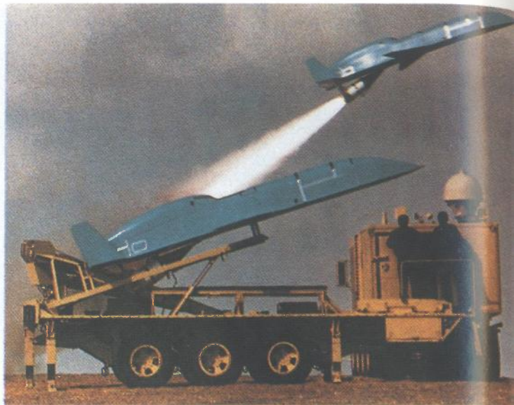
Slika 9. Model 324 Scarab bespilotne letjelice kakvih je 29 komada isporučila tvrtka Teledyne Ryan Aeronautical egipatskoj armiji potkraj 1988. Letjelica nosi sustave za izviđanje u optičkom i infracrvenom području elektromagnetskog spektra
