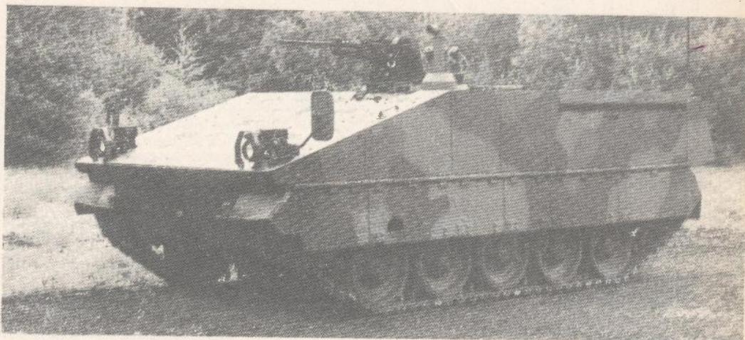
Drugi prototip iz obitelji lako oklopljenih borbenih vozila u APC konfiguraciji s kupolom naoružanom strojnicom 12,7 mm
