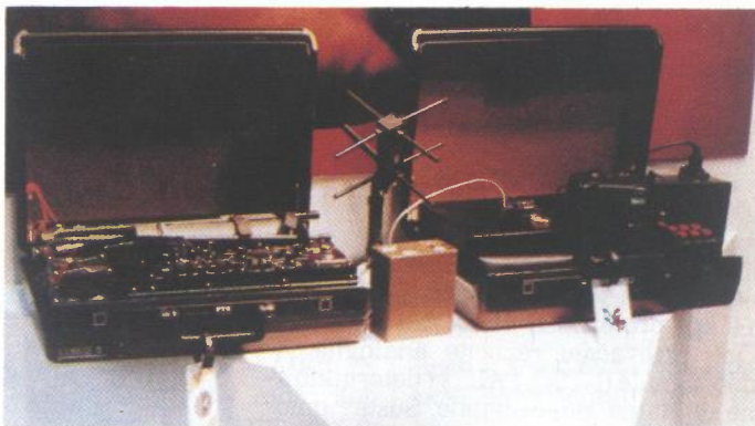
Slika 7. Komplet sustava za transmisiju slike a sastoji se od Mirageovog procesora slike, kamere Canon i transmitterskog uređaja koji se temelji na vojnom AN/PSC-3 UHF predajniku
