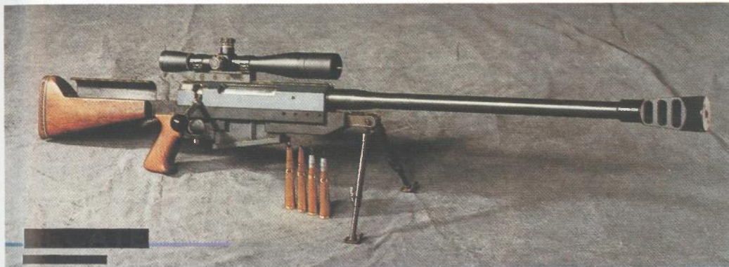
Oružja većeg kalibra zahtijevaju snažnije plinske kočnice. Na slici je prikazana snajperska puška u kalibru 12,7 mm BROWNING na koju je ugrađena jedna takva kočnica
