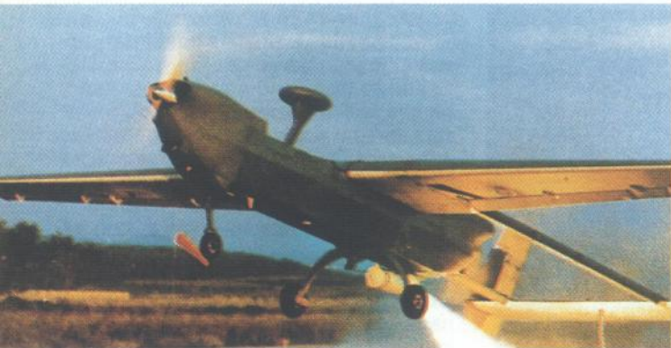
Slika 8. Izraelska bespilotna letjelica Hunter koju je američki ured UAV JPO odabrao za izviđanja na udaljenostima do 150 km sa zadaćom odašiljanja slika u gotovo realnom vremenu
