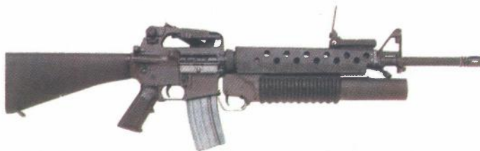
Ručni granatni bacač 40 mm M203 postavlja se ispod cijevi puške 5,56 mm M16. Masa bacača iznosi 1,6 kg, a maksimalni domet oko 300 m
