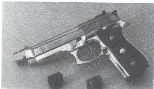
Izgled, način djelovanja i postupak montiranja kompenzatora za brazilski samokres TAURUS
