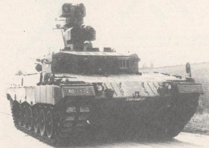
VT-2000 je korišten za prvi ispitni sustav s konceptom 2 x 2 operatera. Sadrži dva potpuno redundantna senzorska sustava (IC, 2 x TV na platformama i optronički periskop – tri TV kamere s mogućnošću pokretanja po smjeru). Ovakvi se ispitni sustavi sada ugrađuju na podvozje LEOPARD 2
