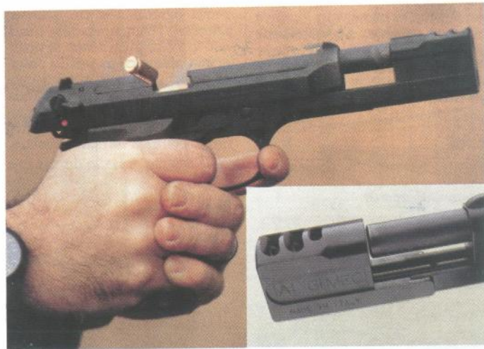
Kompensatori trzaja namijenjeni samokresima stekli su posljednjih godina veliku popularnost iako mnogi stručnjaci smatraju da se više radi o modnom hitu nego o nekom korisnom dodatku. Na slici je prikazan poznati samokres BERETTA 92F s jednim takvim kompenzatorom
