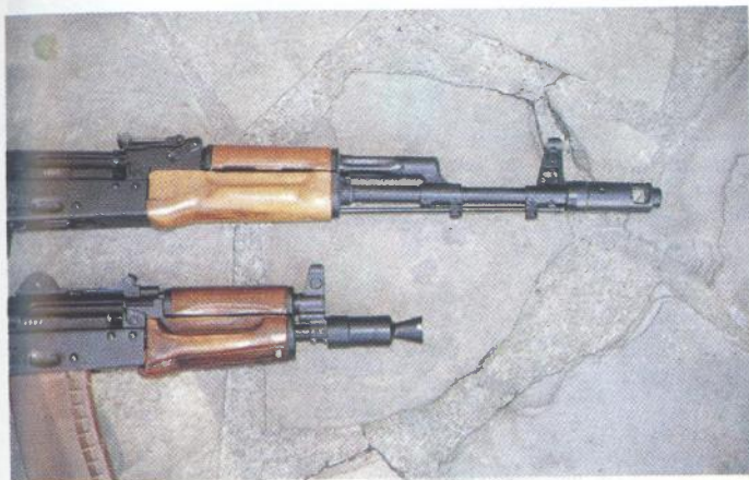
Izgled plinske kočnice-kompenzatora na ruskoj automatskoj pušci 5,45 mm AK74 (gore) i na kraćem modelu AKR-74 istog kalibra. Uočava se velika razlika u njihovom obliku što je posljedica različitih dužina cijevi i mjesta odvođenja barutnih plinova
