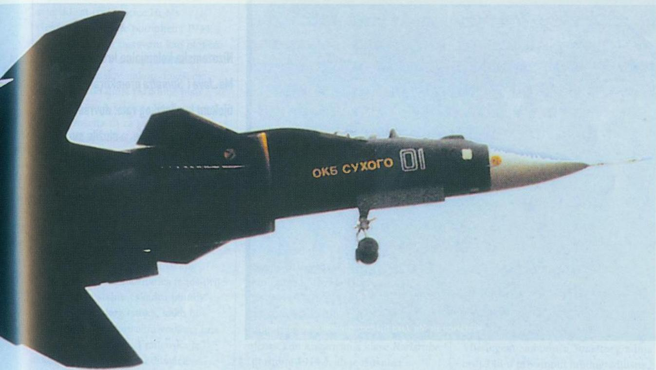
Premda tvrdnjama Suhoja zrakoplov postiže brzinu od 2200 km/h uz pomoć turboventilatorskih motora D-30F6
