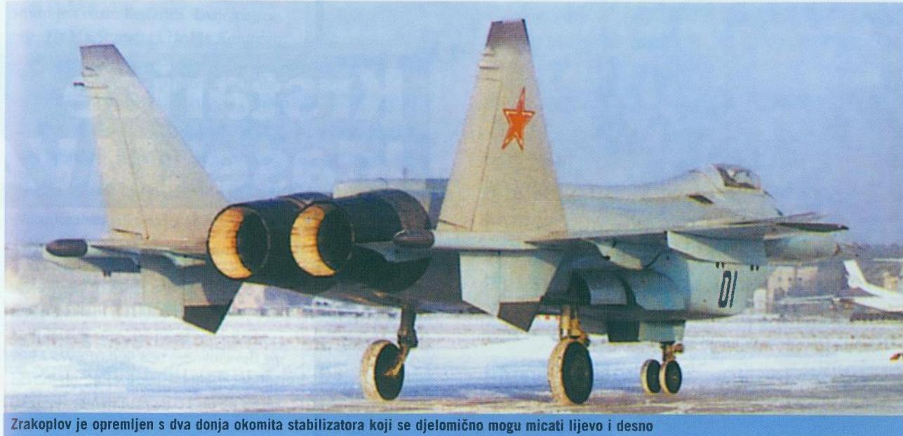
Zrakoplov je opremljen s dva donja okomita stabilizatora koji se djelomično mogu micati lijevo i desno
