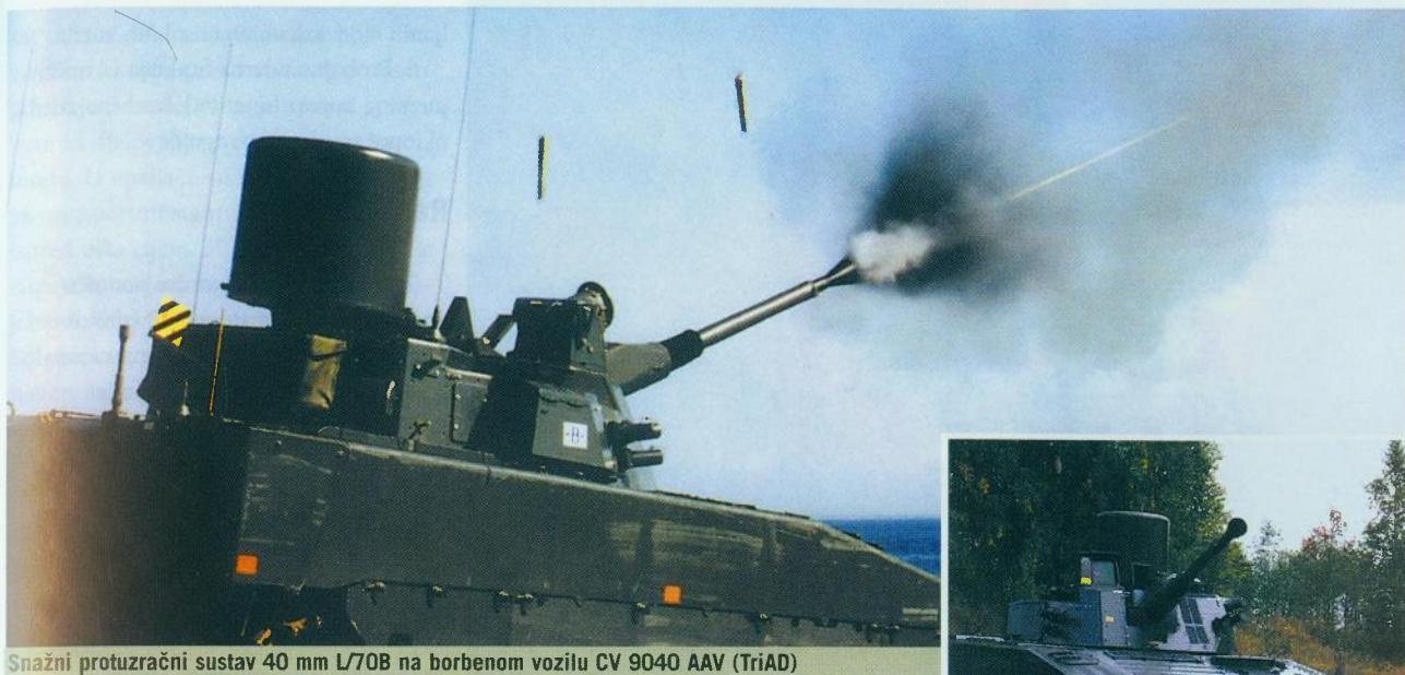
Snažni protuzračni sustav 40 mm L/70B na borbenom vozilu CV 9040 AAV (TriAD)
