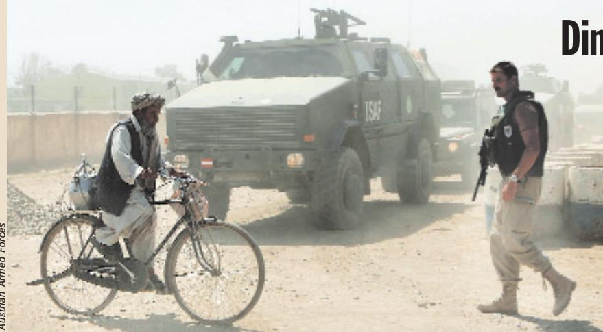
**VIŠENAMJENSKO** oklopno vozilo Dingo pogonske konfiguracije 4x4, odnosno noviju inačicu Dingo 2, proizvodi njemačka tvrtka Krauss-Maffei Wegmann iz Münchena. Vozilo je nastalo kao prilagodba podvozja taktičkog kamiona Unimog U-5000 specijaliziranim vojnim potrebama, ponajprije mirovnim misionama. Dosad je njemačkoj vojsci predano više od 140 vozila Dingo, i to od 2000. do 2003.
