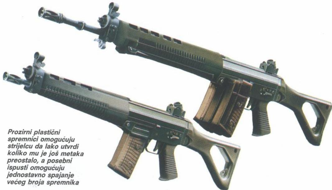
*Prozirni plastični spremnici omogućuju strijelcu da lako utvrdi koliko mu je još metaka preostalo, a posebni ispušti omogućuju jednostavno spajanje većeg broja spremnika*
