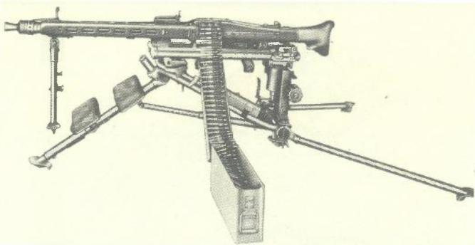
Strojnica 7,9 mm M53 koristi metalnu nerastavljivu nabojnjaču kapaciteta 50 metaka. Članci su međusobno spojeni žicom. U metalnu kutiju za streljivo mogu se smjestiti četiri takve nabojnjače
