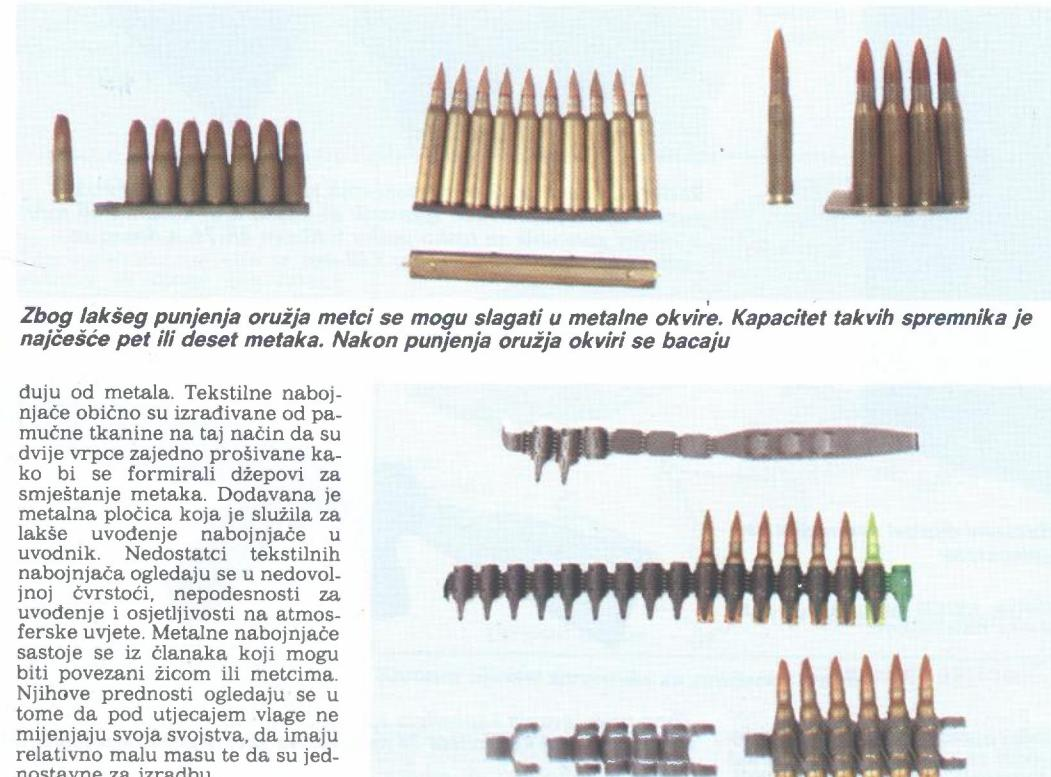
*Razlika između nabojavače s nerastavljenim člancima (gore) i rastavljenim člancima. Kod nerastavljeve nabojavače članci su međusobno povezani žicom, a zbog lakšeg uvođenja u oružje imaju metalni produžetak*
