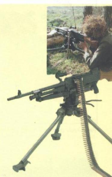
Strojnica FN MAG u kalibru 7,62 × 51 mm puni se pomoću nabojnjače sastavljene od metalnih članaka
