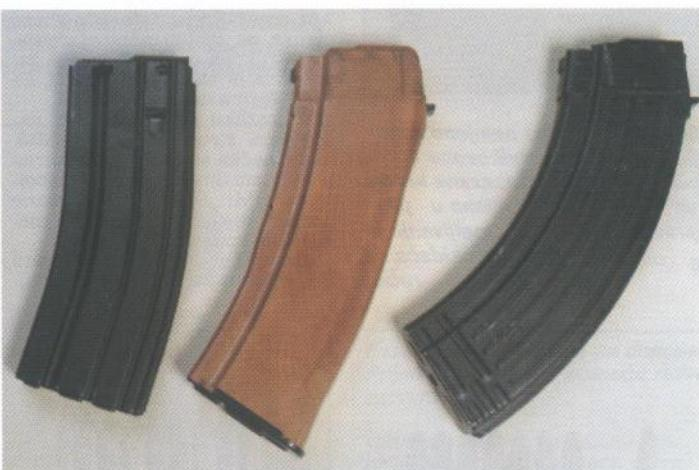
*Razlika u konstrukciji tri najpoznatija spremnika za automatske puške. Lijevo je prikazan spremnik za pušku SAR kalibra 5,56 mm, u sredini spremnik za rusku pušku 5,45 mm AK-74, a desno za pušku KALAŠNIKOV u kalibru 7,62 mm*
