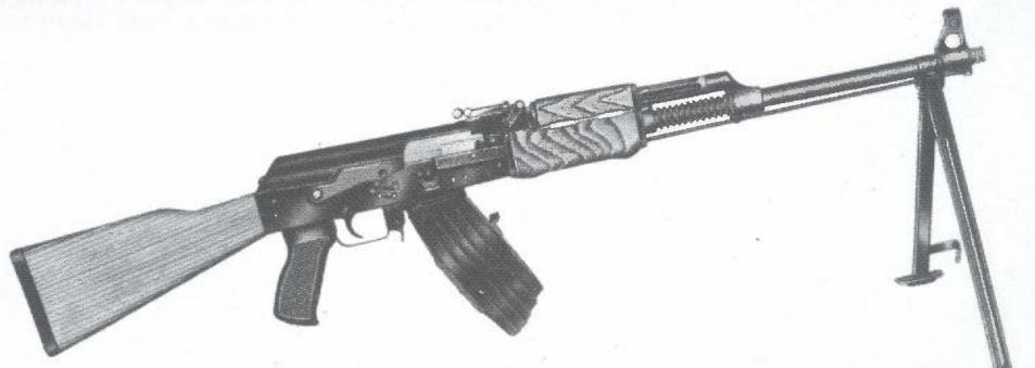
*Zbog povećavanja kapaciteta spremnika može se umjesto standardnog spremnika od 30 metaka koristiti bubanj kapaciteta 75 metaka. Na slici je prikazana jedna takva konstrukcija za strojopušku 7,62 mm M72*
