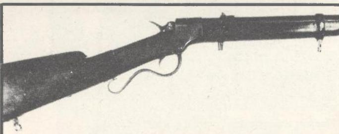
**Karabin sustava Ballard s napravom za perkusijsko paljenje smještenom unutar zatvarača, nevidljivom izvana**
