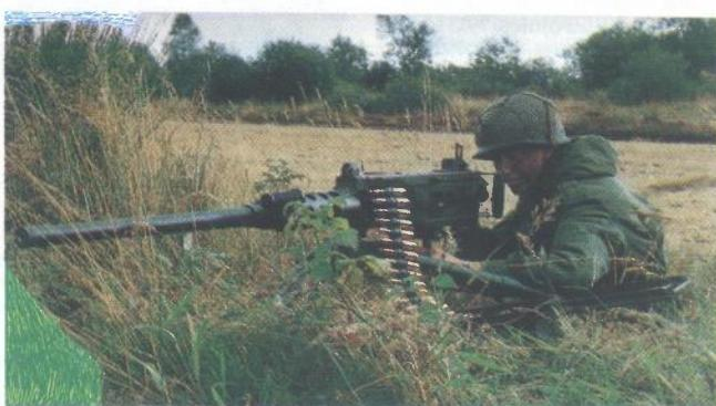
Teška strojnica 12,7 mm BROWNING koristi metalnu nabojnjaču s rastavljivim člancima. To znači da se spajanje nabojnjače obavlja pomoću metaka, a da prigodom gađanja dolazi do njezina raspadanja
