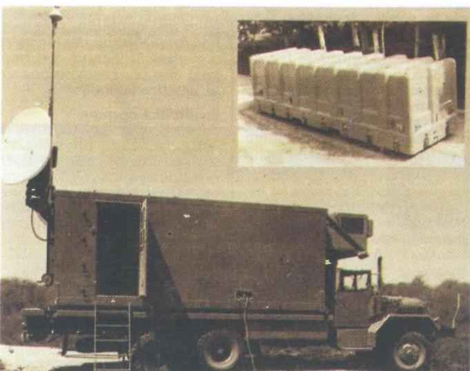
Slika 6. Vanjski izgled glavne upravljačke postaje sustava Scout. U gornjem desnom dijelu slike vidi se spremnik u kojem se prevoze i skladište rastavljene letjelice
