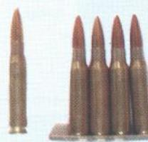
*Zbog lakšeg punjenja oružja metci se mogu slagati u metalne okvire. Kapacitet takvih spremnika je najčešće pet ili deset metaka. Nakon punjenja oružja okviri se bacaju*
