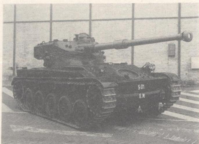
*AMX-13 prenaoružan s topom Cockerill 90 mm Mk IVA3 (na cijevi se jasno vidi plinska kočnica i uređaj za odvođenje barutnih plinova)*
