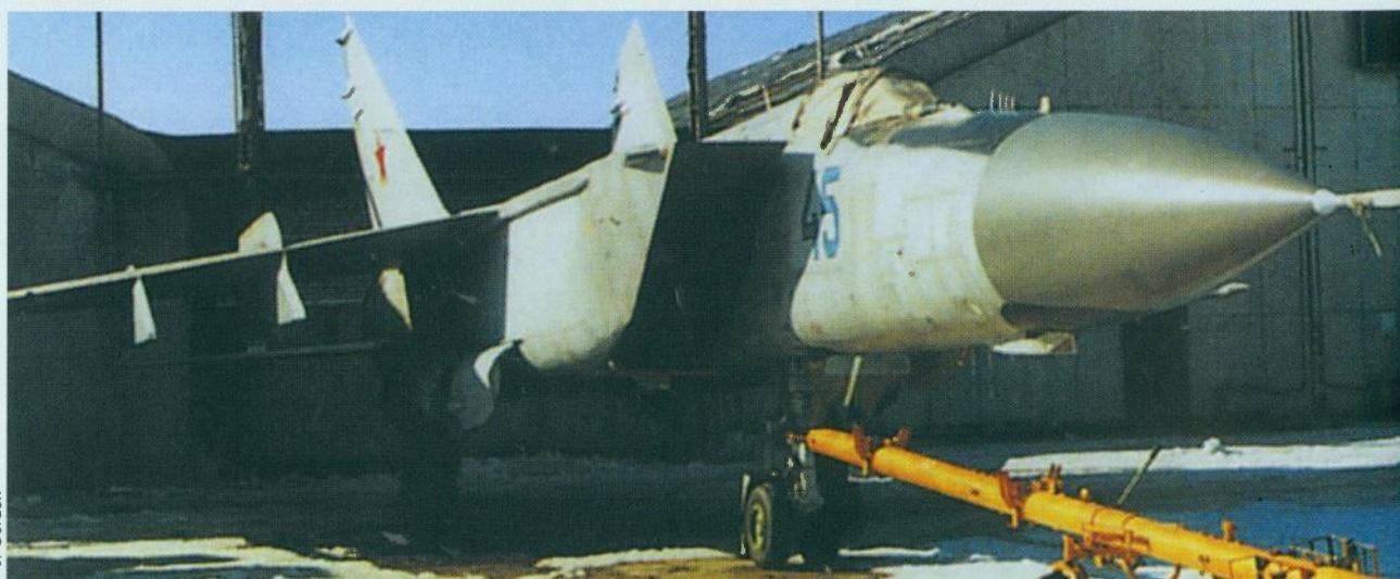
Eksperimentalni MiG-25PDZ, korišten za ispitivanje ugradnje priključka za punjenje gorivom u letu
