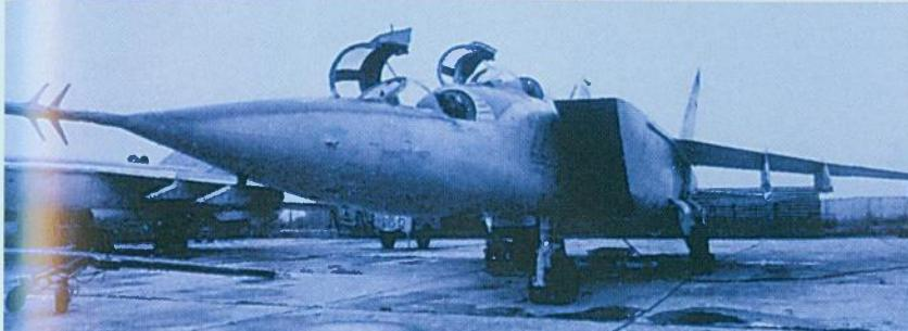
Pojedini primjeri MiG-25 modificirani su za korištenje u različitim ispitnim programima. Na slici je MiG-25PU-SOTN, korišten u programu razvoja raketoplana Buran
