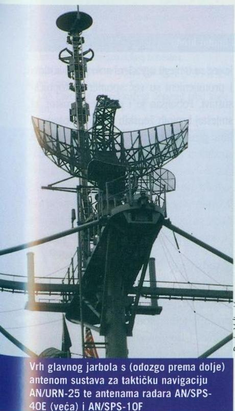
Vrh glavnog jarbola s (odozgo prema dolje) antenom sustava za taktičku navigaciju AN/URN-25 te antenama radara AN/SPS-40E (veća) i AN/SPS-10F
