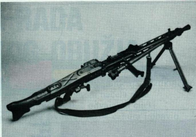
Konstrukcija njemačke strojopuške MG3 u kalibru 7,62×51 mm vrlo je slična dobro poznatom »šarcu« (7,9 mm M53). Za pokretanje trzajućih dijelova koristi se kratko trzanje cijevi
