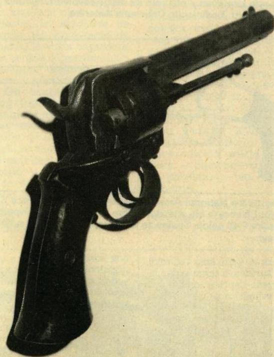
Revolver sustava Lefaucheur izrađen u Belgiji, u Liegeu. Kalibar mu je 11 mm i u bubnju ima 6 naboja. Izbacivač praznih čahure postavljen je s desne strane cijevi kao i otvarač zatvarača. Sustav odponca mu je DA tj. Chenet. Na slici se vidi otvoren zatvarač i naboј s iglenom pripalom umetnut u bubanj do polovice.
