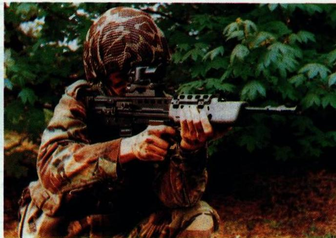
*Konstrukcija engleske jurišne puške SA 80 u kalibru 5,56 × 45 mm temelji se na načelu odvođenja barutnih plinova*
