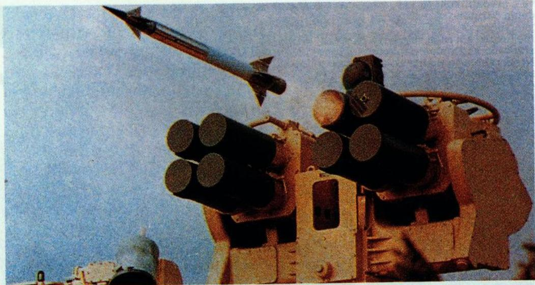
*Turela s četiri lansirne cijevi za sustav Starburst, namijenjena za ugradnju u oklopna vozila ili transportere*
