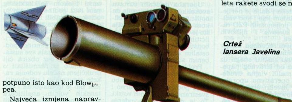
Najveća izmjena napravljena je kod načina stvaranja signala vođenja. Temeljni način praćenja Javelin rakete je praćenje njezinog IC izvora smještenog u području mlaznika tijekom cijelog gađanja, a ne samo za vrijeme
