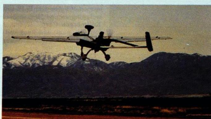
Slika 4 Letjelica Hunter SR (Short Range – kratki domet) sustava koji ulazi u uporabu u vojsci SAD-a. Ta letjelica je proizvod tvrtke AAI (iz SAD) i IAI. Temeljne zadaće sustava su: nadzor, izviđanje i određivanje položaja ciljeva. Rješenje pogonskog sustava je slično kao i kod letjelice Impact (IAI): ima jedan motor s potisnim i jedan s vučnim propelerom. Za razliku od Imparta, Hunter je aerodinamički znatno bolje oblikovan. Pretpostavlja se da u izviđanju može ostati duže od 24 sata
