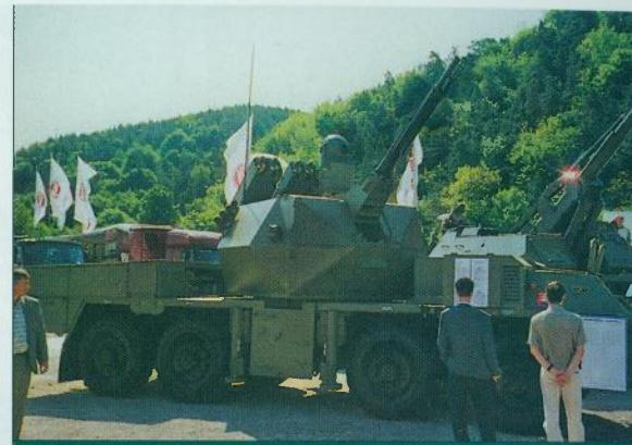
**Samohodni protuzračni sustav BRAMS sastoji se od dva topa kalibra 30 mm, te lansera s četiri samonavodene rakete zemlja-zrak smještenih na vozilu TATRA**
