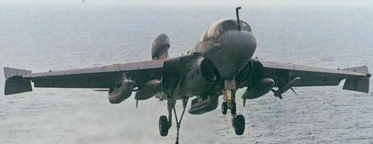
Kod slijetanja Grumman EA-6B Prowler prilazi nosaču slijedeći točno određen kut i smjer poniranja, a s izvučenim zračnim kočnicama, zakrilcima i pretkrilcima te kukom za zaustavljanje
