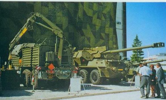
**Samovozni topnički sustav 155 mm ZUZANA model 2000. S lijeve strane vidi se posebno razvijeno vozilo sa streljivom**
