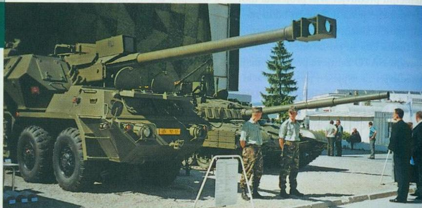
**Desno od sustava ZUZANA vidi se modernizirani tenk T-72M2 MODERNA s montiranim segmentima za zaštitu od protuoklopnih projektila**
