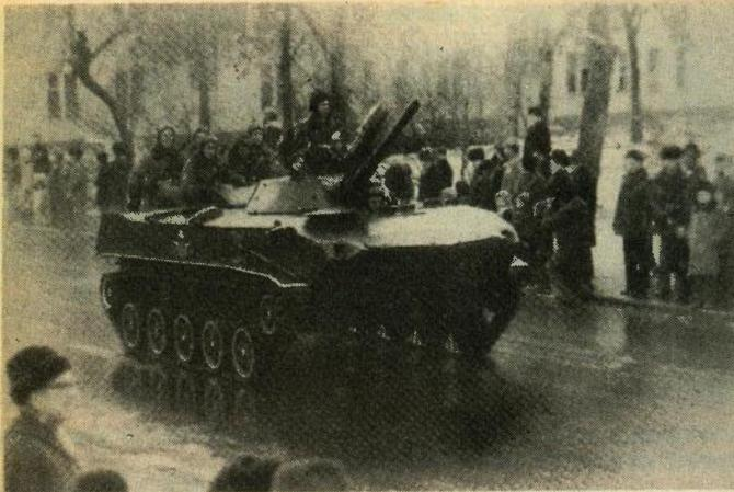
**BMD-1 s protuoklopnim projektilom AT-3 Sagger smještenim iznad 73 mm topa**
