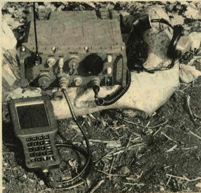
**Prijenosni radio-lokator ES1200 prekriva područje frekvencija od 500 kHz do 500 MHz. U kompletu se nalaze AN/PRD-12DF prijamnik/procesor, antena za HF i VHF/HF područje te radio PRC1077**
