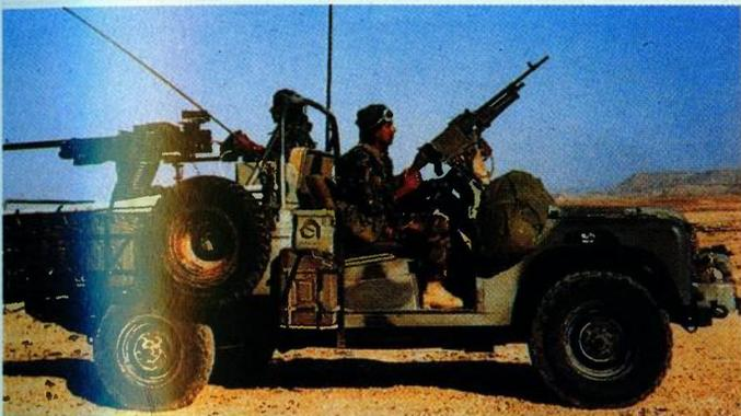
Izvidničko vozilo LR DEFENDER 110 PATROL, sa 7,62 mm strojnicom i 30 mm topom
