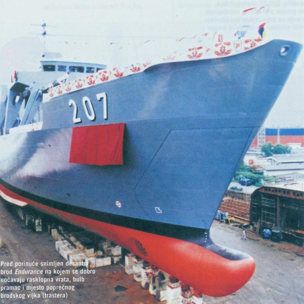
Pred porinućem snimljen desantni brod *Endurance* na kojem se dobro uočavaju rasklopna vrata, bulb pramac i mjesto poprečnog brodskog vijka (trastera)
