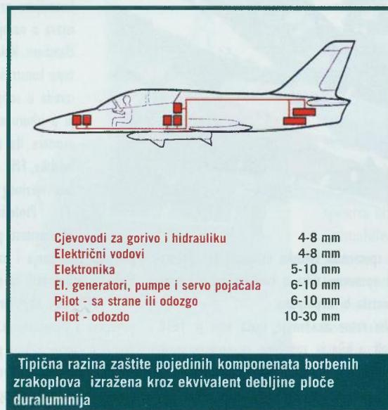
**Tipična razina zaštite pojedinih komponenata borbenih zrakoplova izražena kroz ekvivalent deblijine ploče duraluminija**
