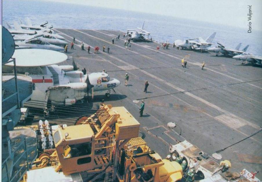
Preko krmnog (sletnog) dijela letne palube razvučena su i zategnuta (na visini oko 10 cm iznad palube) četiri čelična užeta za kočenje sustava za zaustavljanje aviona. Paluba je najviše "izderana" oko užeta br. 3 jer piloti najčešće "ciljaju" baš na njega. U prvom su planu palubna vozila za spašavanje i održavanje letjelica, dok su na palubi avioni E-2C Hawkeye, S-3B Viking, i F-14B Tomcat
