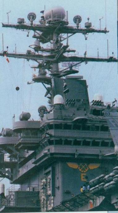
Desni bok nadgrada tj. zapovjednog otoka nosača USS *Dwight D. Eisenhower* s brojnim antenama radara, sustava za električna djelovanja, sustava za navođenje aviona komunikacijskih i drugih sustava ukazuje na svu složenost i brojnost električne opreme brodova te klase
