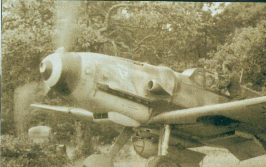
Bf 109G-6/R1 iz sastava JG 3 "Udet", naoružan s jednom bombom od 250 kg smještenom ispod trupa zrakoplova
