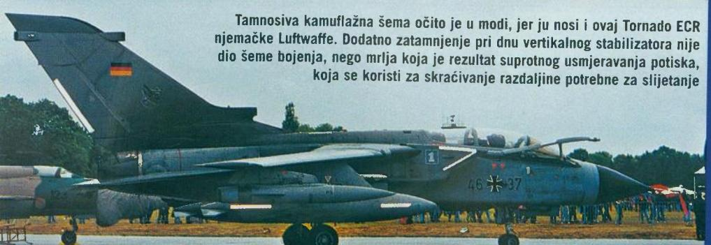
Tamnosiva kamuflažna šema očito je u modi, jer ju nosi i ovaj Tornado ECR njemačke Luftwaffe. Dodatno zatamnjivanje pri dnu vertikalnog stabilizatora nije dio šeme bojenja, nego mrlja koja je rezultat suprotnog usmjeravanja potiska, koja se koristi za skraćivanje razdaljine potrebne za slijetanje
