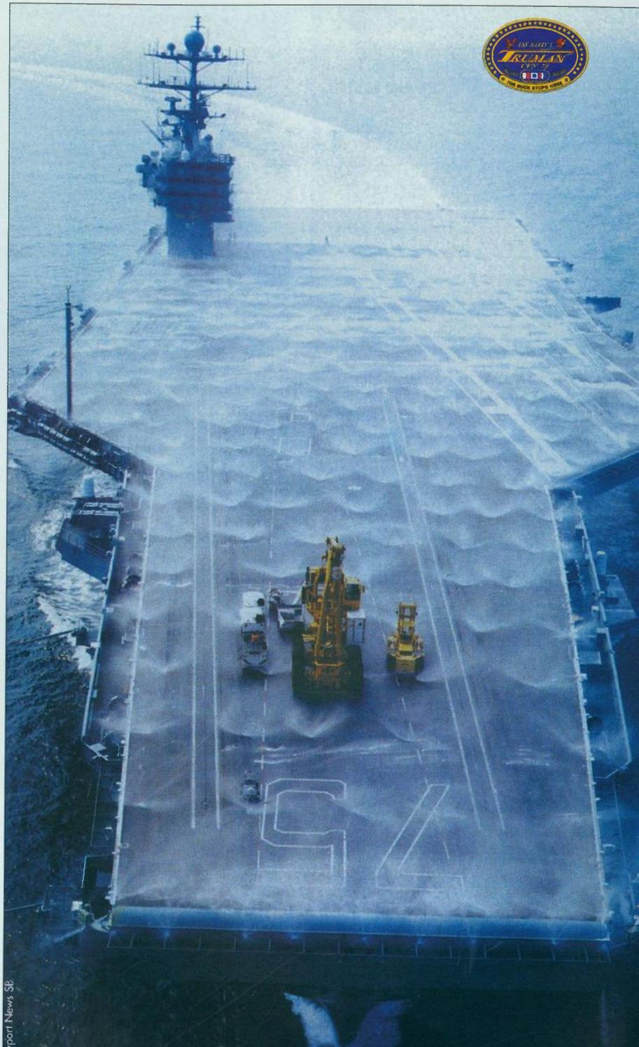
Ispitivanje sustava orušavanja letnom palube (površine oko 19.000 m<sup>2</sup>) na nosaču USS Harry S. Truman (CVN-75)
