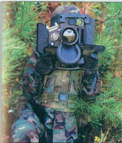
Sl. 7. - Zapovjedno-lansirna jedinica može se koristiti i samostalno za motrenje terena, pri čemu dnevno/noćni optički sustav omogućava motrenje i po danu u uvjetima smanjene vidljivosti i po noći
