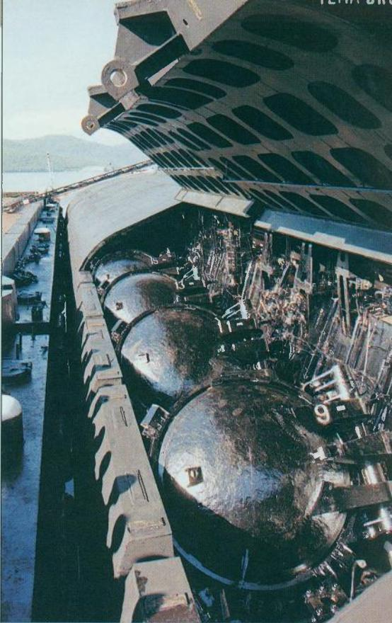
Temeljno naoružanje podmornica Projekta 949A su 24 krstareća protubrodska projektila P-700 sustava Granit (SS-N-19 Shipwreck) dometa 550 km, brzine leta 2,5 Macha čije su lansirne cijevi postavljene u svakom boku, između unutarnjeg i vanjskog trupa (po 12 cijevi na svakom boku) tako da jedan poklopac lansirnog otvora zatvara po dva lansera
