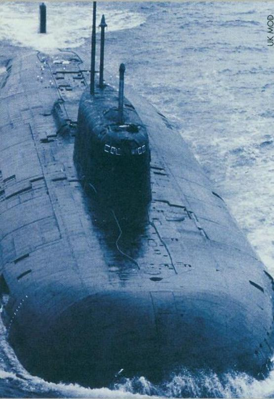
K-525 s izvučenim periskopom, VHF antenom i antenom Pert Spring
