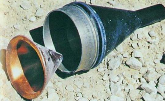
Izgled kumulativnog lijevka raketnog projektila
