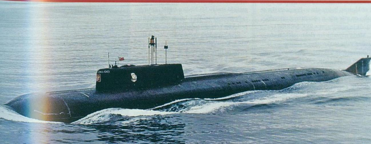
U pogonskoj skupini podmornica Projekta 949A su dva nuklearna reaktora OK-650B snage po 190 MW hlađena vodom pod tlakom te dvije parne turbine OK-9 koje im osiguravaju najveću podvodnu brzinu 28 čv
