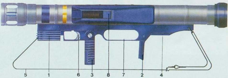
Presjek bacača: 1. rukica za oslanjanje; 2. oslonac za rame; 3. rukica okidača; 4. obloga ; 5. remen za nošenje; 6. okidač; 7. rukica za nošenje; 8. ciljnik
