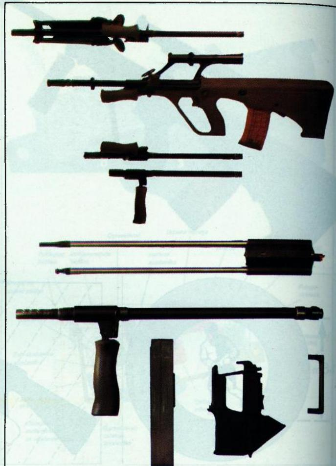
Temeljna konfiguracija puške 5,56 mm AUG može se prilagoditi ispaljivanju slabijeg streljiva 9 mm Parabellum. Na taj način puška se zapravo pretvara u kratku strojnici. Dijelovi za konverziju uključuju kraku cjev (350 mm), nosač zatvarača, spremnik i adapter za spremnik
