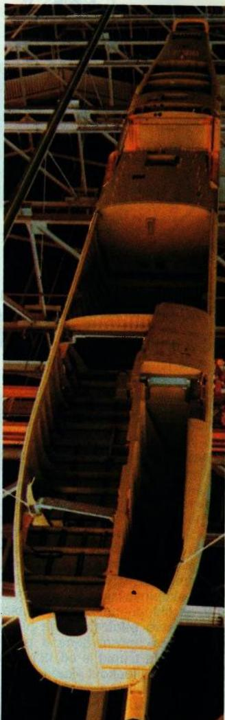
Gornji dio trupa, na kojem se vidi odjeljak za smještaj topa GAU-8/A i ležiste nosnog kotača podvozja, pomaknuto udesno od osi zrakoplova
