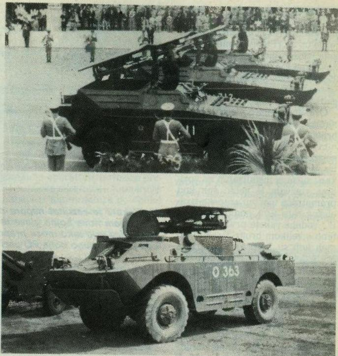
*Najčešće korišten lovac tankova na podvozju vozila GAZ-41-06 (BRDM-2) namijenjen je za lansiranje i vodenje raketama 9M14M Maljutka. Prva inačica 9P122, prikazana na slici, ispaljuje raketama 9M14M, dok poboljšana inačica 9P133 ispaljuje poboljšane raketama 9M14P koje se mogu do cilja voditi poluautomatskim sustavom vodenja. Inačica 9P133 ima i poboljšani blok optike koji se nalazi s desne strane vozila iznad operatorova sjedala*
