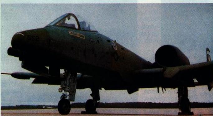
**Podvozje A-10 dizajnirano je tako da u slučaju otkaza hidrauličkog sustava svi kotači dolu u izvučeni položaj djelovanjem zračne struje i gravitacije**
