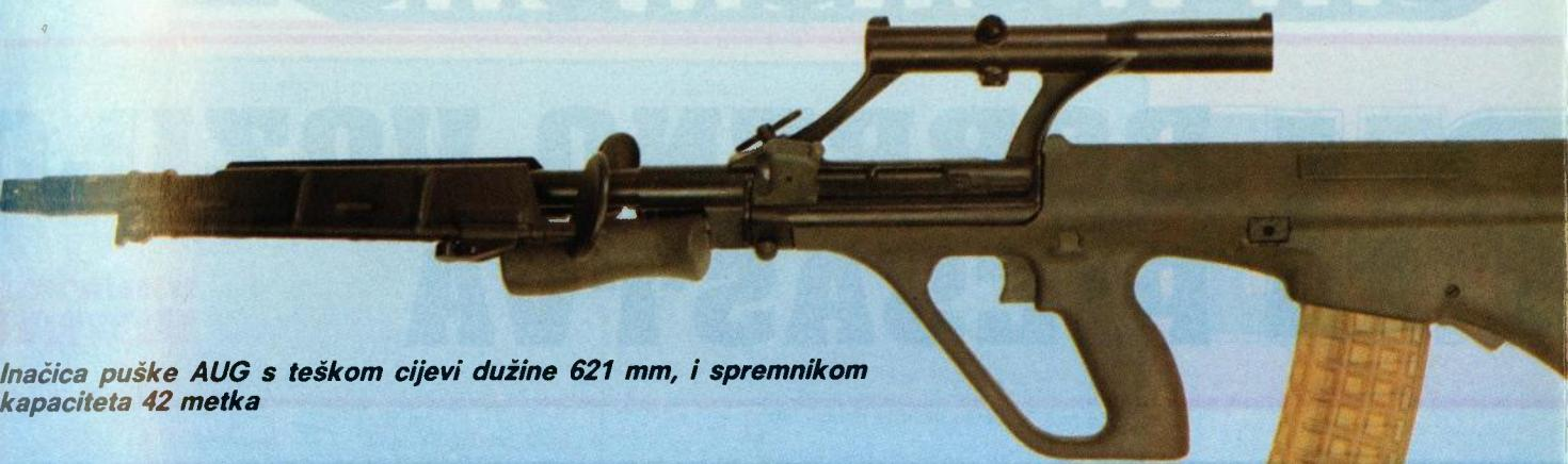
Inačica puške AUG s teškom cijevi dužine 621 mm, i spremnikom kapaciteta 42 metka
