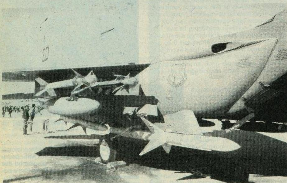
*F-15E, opremljen za zračnu borbu: na potkrilnim nosaćima nalaze se projektili AIM-9 Sidewinder, a na nosaćima na CFT spremnicima nalaze se AIM-7 Sparrow*
