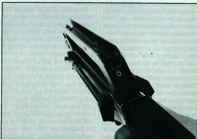
Izgled mehaničkog ciljnika na pušci FAMAS. Prednji ciljnik ima luminiscentni prekllopnik za noćno gađanje. Stražnji ciljnik ima otvor za gađanje na daljinama od 100 i 200 metara, te fiksni otvor za gađanje na daljinu od 300 m
