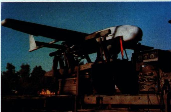
*Talijanska letjelica Mirach 26 u pripremi za lansiranje s odbacivim lansirnim raketnim motorom. Na donjem dijelu trupa letjelice vidi se polukuglasto kućište pokretnog girostabiliziranog nosača s izvidničkom opremom. Domet upravljanja ovom malom letjelicom iznosi 50 kilometara. Za navigaciju (osim u pasivnoj preprogramiranoj navigaciji) rabi signale Omega/VLF navigacijskog sustava*
