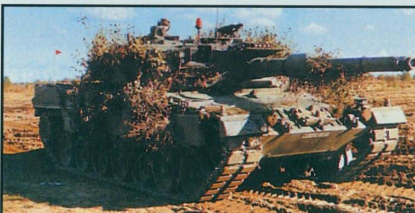
Njemački Leopard 2A4, opremljen Saabovim BT41 AGDUS sustavom, uključujući pirotehničku opremu zbog stvaranja vizualnog dojma paljbe
