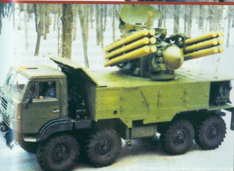
**Izgled sustava Pantsir S-1 smještenog na kamion. Sustav je modularne konstrukcije i može se postaviti na različite platforme**
