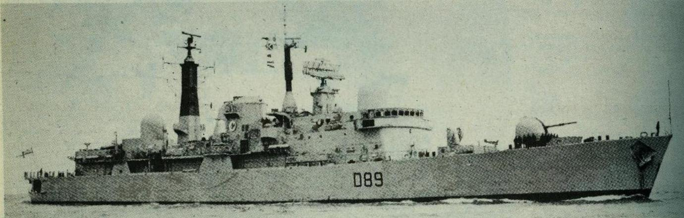
Slika razarača Exeter (D89) načinjena nakon zadnje modernizacije. Kod broskog se dimnjaka uočava bijela radarska kupola proturaketnog topničkog sustava Vulcan Phalanx Mk15
