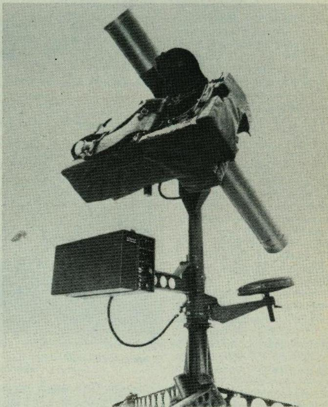
Ispitivač IFF 880 integriran s Boforsovim RBS 70 protuzračnim raketnim sustavom
