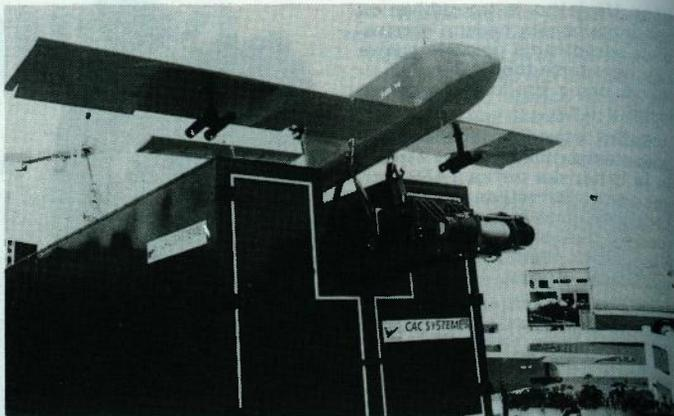
Letjelica Fox AT. Ta letjelica je leteći cilj za protuzračnu obranu. Pregradnjom ovih letjelica i ostalih dijelova sustava tvrtka CAC je proizvela izvidničke bespilotne sustave koji su u uporabi u snagama UN. Pod svakim krilom letjelice vidi se po nekoliko mamaca – izvora topline
