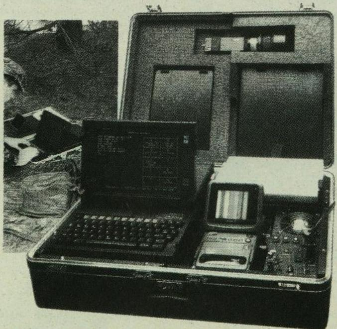
GTE je razvio PORTS 1N prijenosni slikovni sustav težine ispod 20 kg za zadužje tipa prikrivenog motrenja zračnih luka. Sustav se u temeljnoj inačici sastoji od TV kamere, monitora računala i printera u transportnom kovčegu. Korisnik može slike spremati na disk, na njima vršiti približeske i obradivati ih, te komprimirati ih radi kasnijeg prijenosa
