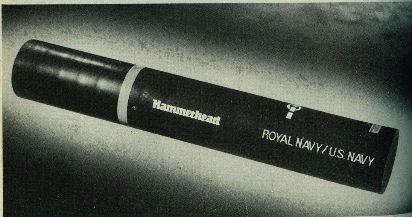
Mina-torpedo Marconi/Lorel »Hammerhead«, na morskome dnu raščlanjuje šumove brodova i podmornica pasivnim sonarom. Nakon detekcije i klasifikacije cilja progone ga kao torpedu, navodeći se aktivnim sonarom
