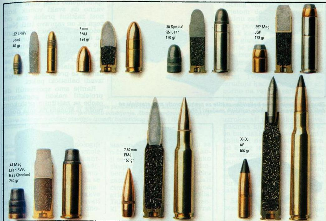
Ispitivanje razine balističke zaštite obavlja se s različitim vrstama streličiva. Na slici su prikazani izgledi i presjeci metaka koji se rabe tijekom ispitivanja po NIJ standardu (1 gr = 0,0648 grama)
