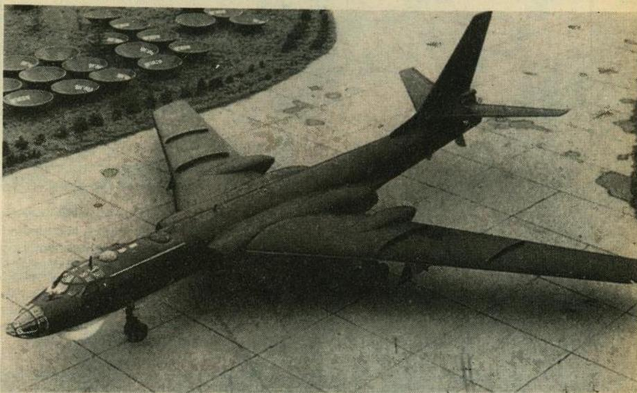
Dio H-6 modificiran je za izvršavanje protubrodskih zadaća: označeni kao H-6L, tridesetak ovih zrakoplova nose po dva protubrodска projektila C-601 (pod nosom H-6 vidljiv je radar koji se koristi za vođenje C-601)
