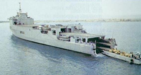
Desantni brod-dok *Foudre* istoimene klase iskrcava desantnu brodicu tipa CTM (modificirani po licenci građeni američki tip LCM 8) pune istisnine 150 tona
