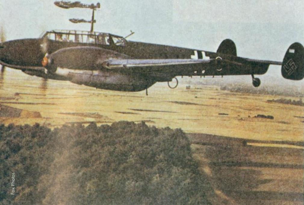
Teški dvomotorni lovac Messerschmitt Bf 110C. Unatoč očekivanjima planera Luftwaffe kako će se taj avion pokazati sposobnim za praćenje bombardera na većim udaljenostima, njegova slaba pokretljivost u odnosu na Spitfire i Hurricane dovela je do toga da je i samom Bf 110 trebala pratrna u obliku Bf 109
