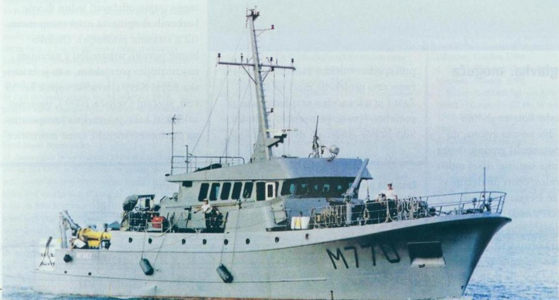
*Antares*, prvi od tri broda za izviđanje ruta i obuku u navigaciji opremljenih tegljenim protuminskim sonarom; dvije vrlo slične jedinice klase *Glycine* rabe se za obuku u navigaciji
