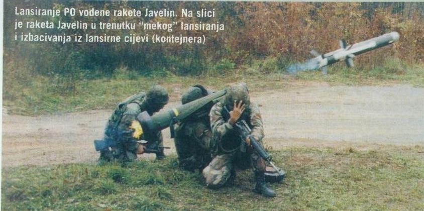
Sustav se prevodi iz putnog u paljbeni položaj u roku od 30 sekundi, te ponovo puni za 20 sekundi. Za razliku od konvencionalnih raket koje se vode preko žice, optičkog kabela ili preko laserske zrake (laser beam riding), Javelin se autonomno navodi na cilj nakon lansiranja, omogućavajući operatoru i poslužitelju da odmah nakon izljetanja rakete iz kontejnera napuste/promjene položaj ili napune sustav za sljedeće lansiranje.
