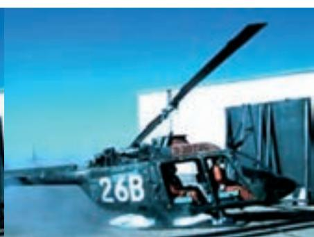
kojih se neposredno prije udara aktivira REAPS sustav i izvlači zračne jastuke nastojeći time zaštiti posadu i putnike u letjelici, odnosno ublažiti oštećenja na helikopterima.
