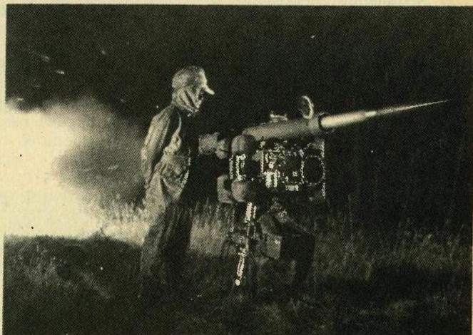
Noćna uporaba sustava RBS 70 s noćnom ciljničkom napravom razvijenom u CelsiusTech
