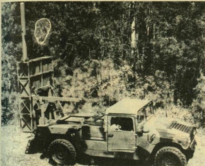
**Projektil vođen preko optičkog kabela tvrtki Boeing i Huges, naziva FOG-M**
