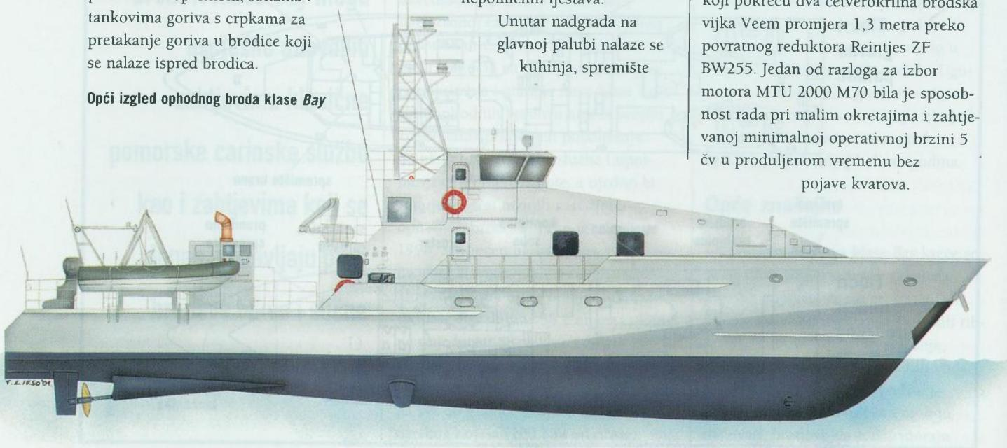
Ograde i otvori su smješteni tako da olakšaju izvlačenje objekata iz vode, uklanjanje/zamjenu opreme iz strojarnice i ukrcavanje/iskrcavanje tereta. Na glavnoj palubi ugradeni su poklopcii otvora upuštenog tipa kako bi se omogućilo sigurno rukovanje teretom. Teret i brodska strojarska oprema može se prenositi dizalicom smještenom na palubi nadgrada iza radne kabine.
