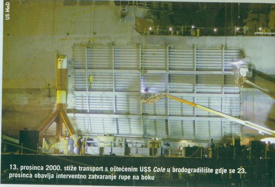
13. prosinca 2000. stiže transport s oštećenim USS Cole u brodogradilište gdje se 23. prosinca obavlja interventno zatvaranje rupe na boku
