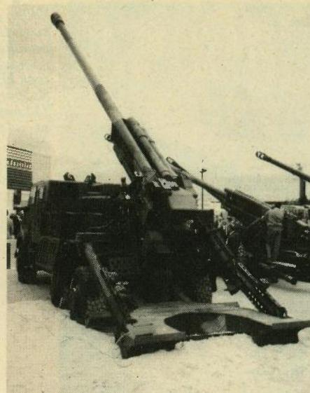
Francuska haubica CAESAR u kalibru 155 mm smještena je na podvozju vozila UNIMOG 6 x 6. Brzina gadađa je 15 projektila u minuti, a maksimalni domet iznosi 42 km.
