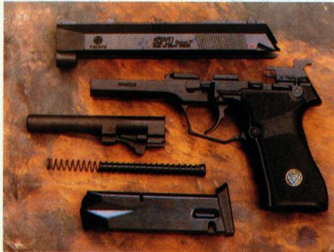
Izgled rasklopljenog samokresa SP1. Kao konstrukcijski uzor poslužila je talijanska BERETTA Model 92 SF. Uočava se specifični način bravljjenja
