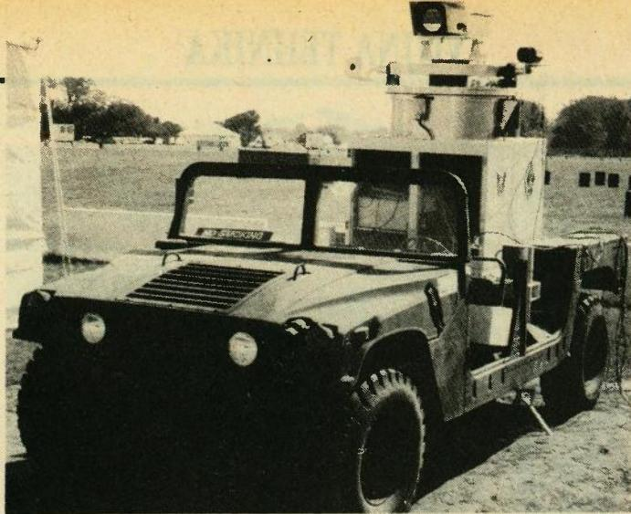
Daljinski upravljana platforma s naoružanjem pod nazivom TEAM ima senzorske sustave (TV, termalnu kameru, laserski označivač cilja, laserski daljinomjer, detektor radioaktivnog zračenja), a radi se na realizaciji automatskog prepoznavanja cilja
