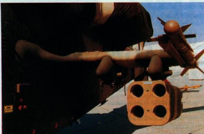
Lijevo krilo za nošenje naoružanja, s raketom zrak-zrak V3
