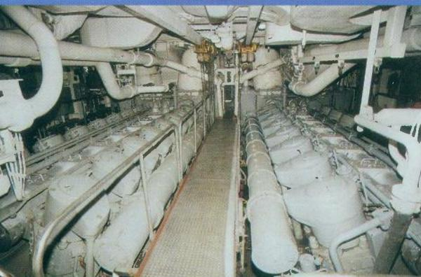
Po dva Dieselova motora Colt-Pielstick 16 PC2.5V400 smještena su u dvije odvojene strojarnice
