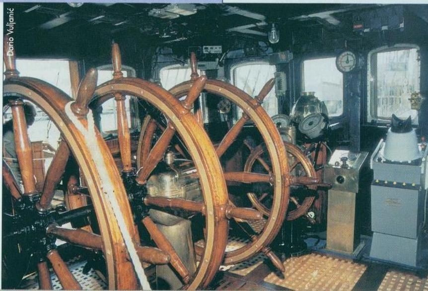
Unutrašnjost donjeg krmenog zapovjednog mosta, gdje se uz suvremene navigacijske i komunikacijske sustave te radar, nalaze i velika drvena kola kormila. U slučaju отказa glavnog elektro-hidrauličkog kormilarskog uređaja (ili tijekom obuke) tim četverostrukim kolima može se ručno upravljati kormilima
