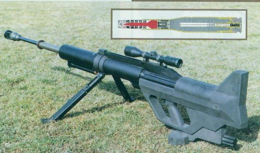
Puška IWS 2000 kalibra 15,2 mm razvio je austrijski proizvođač Steyr-Mannlicher. Ispaljuje projektile u obliku strelica izrađenih iz volframa početnom brzinom od 1450 m/s
