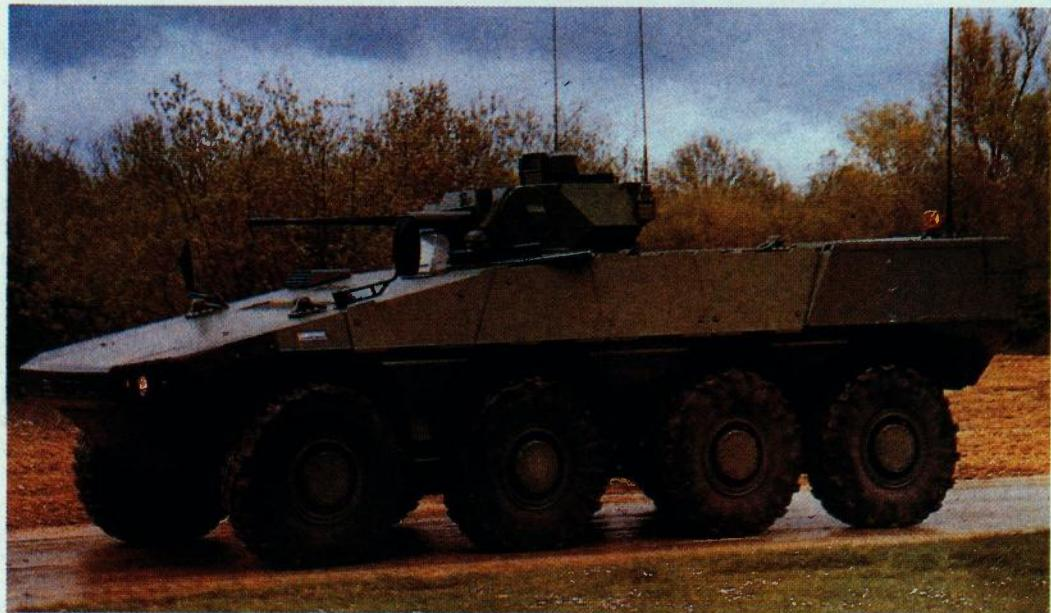
*Bočni prikaz temeljno oblikovane oklopne zaštite na koju se predviđa postavljanje dodatne zaštite, pasivnog i reaktivnog tipa*
