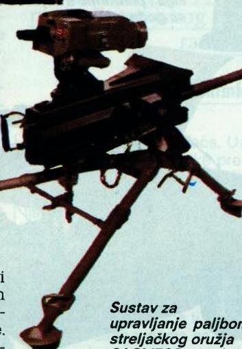
Sustav za upravljanje paljborom streljačkog oružja SACMFCS montira se na teške strojnice i automatske bacace granata. Na slici je prikazan američki bacac 40 mm Mk 19 s jednim takvim uređajem koji u sebi ima ugrađen dnevno/noćni ciljnik te mali laserski daljinomer.
