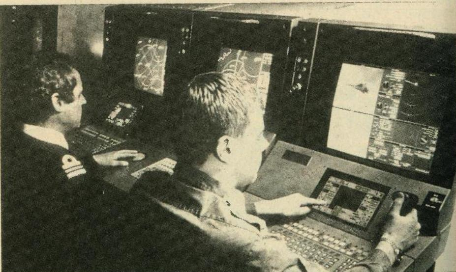
C2 sustavi iz obitelji Nautis mogu se ugradjivati na sve klase brodova, koriste distribuirano načelo obradbe podataka, s više konzola prilagođenih za pojedino radno mjesto. Sustav na temelju ulaznih podataka s brodskih nadvodnih i podvodnih senzora stvara koordinirani taktički prikaz, a s konzola se u cijelosti može upravljati senzorima i naoružanjem. Konzole su autonomne i s njih se mogu obavljati sve funkcije sustava. Nautis-M je vrlo uspješna protuminska inačica
