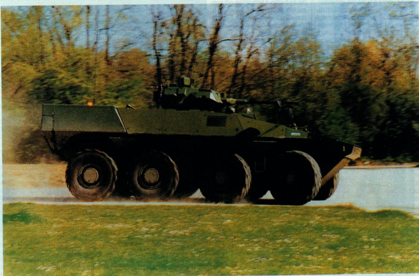
**VEXTRA** ima izvanredne dinamičke značajke i pri kočenju. Pri brzini od 60 km/h put kočenja do potpunog zaustavljanja iznosi 26 m (masa praznog vozila iznosi 26 tona)
