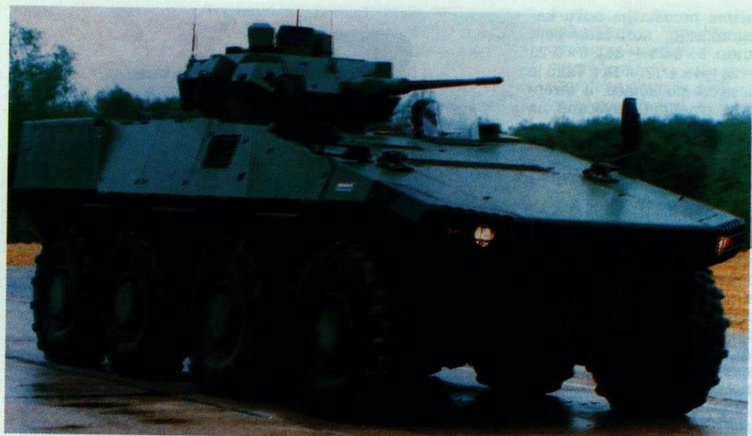
*Eksperimentalni model oklopnog vozila na kotačima VEXTRA APC 8 × 8, naoružano topom 25 mm*
